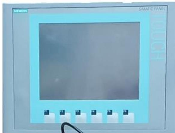
Figura 26. Interfaz humano-máquina SIMATIC HMI KPT400 Basic [57].
