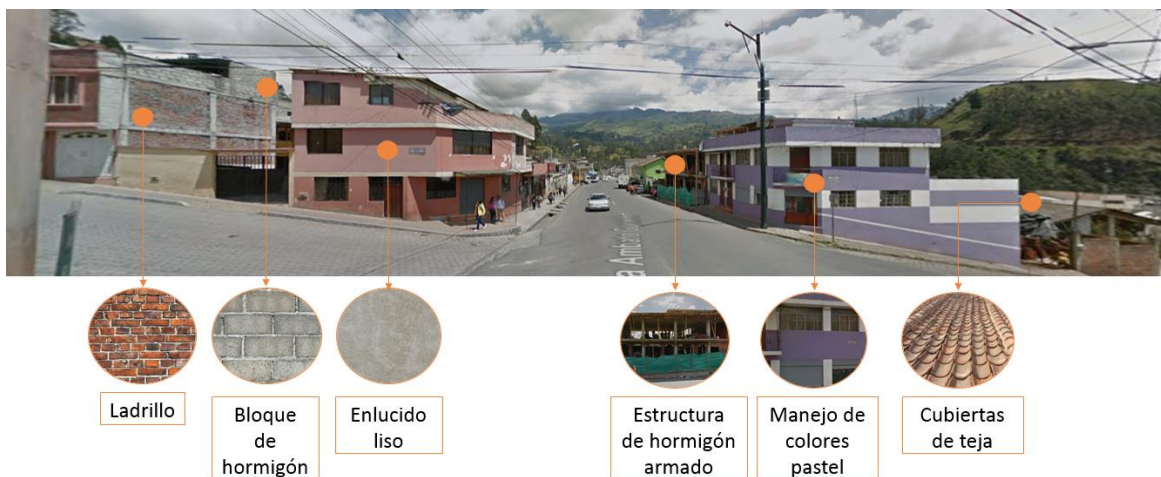
Gráfico 27: Materialidad de la zona Fuente fotografías: Google Earth y Google. Elaborado por: Sebastian Sánchez López, 2018.
