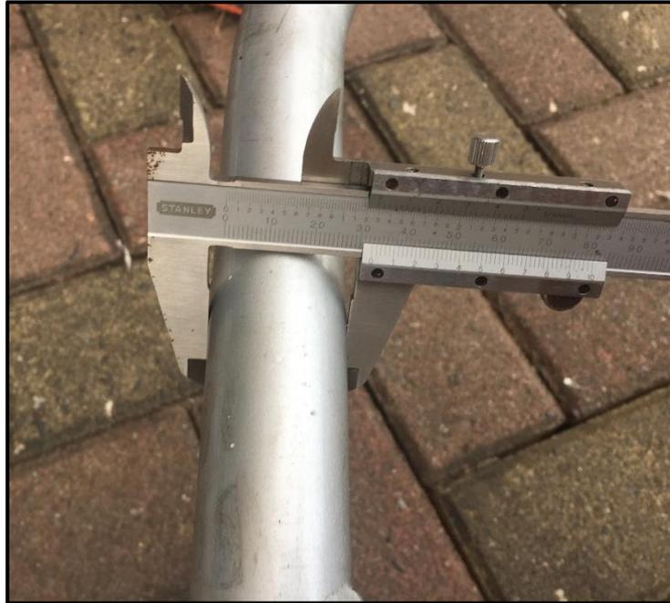
Figura 24. Medición del tubo de la estructura del Go Kart
