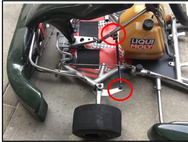
Figura 49. Ajuste de la dirección del Go Kart
