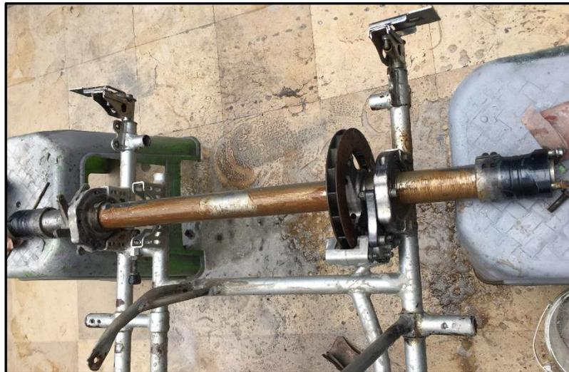
Figura 34. Selección y disposición del eje de la transmisión
