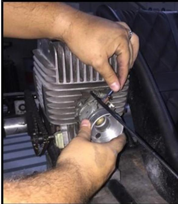
Figura 75. Calibrando aire y combustible
