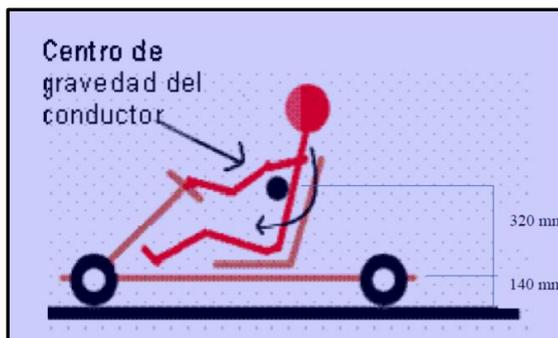
Figura 36. Centro de gravedad del asiento del piloto del Go kart
