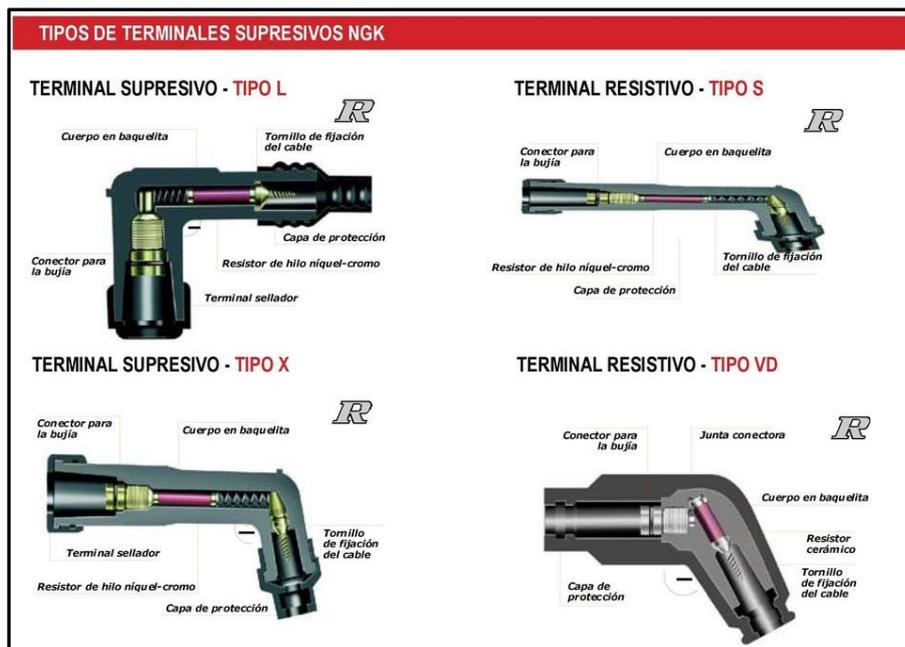
Figura 71. Tipos de terminales supresivos NGK de cables de bujía
