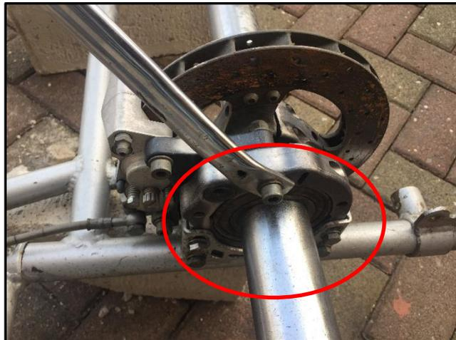
Figura 54. Acoplamiento y ajuste de soporte del eje posterior
