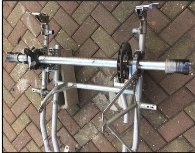
Figura 51. Montaje del eje posterior
