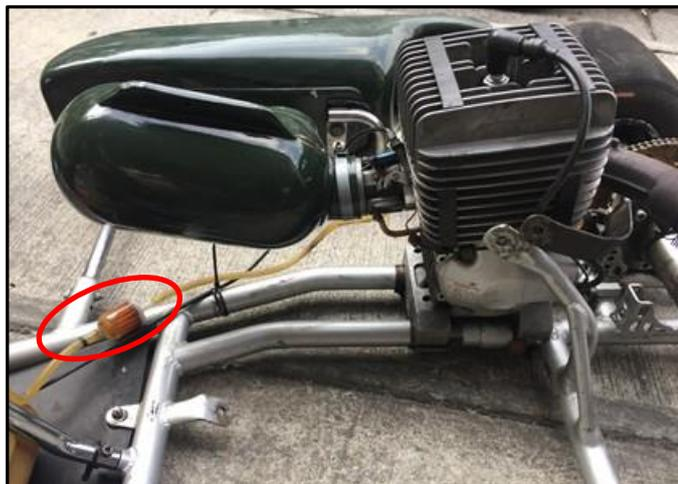
Figura 53. Ubicación del conducto y filtro de alimentación de combustible
