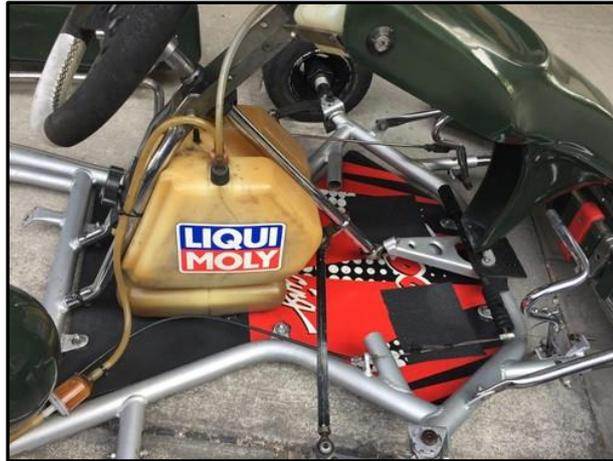
Figura 58. Ubicación del tanque de combustible
