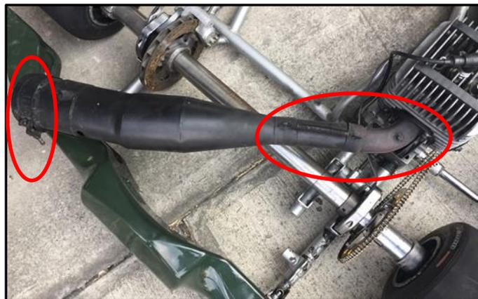
Figura 52. Montaje del sistema de escape
