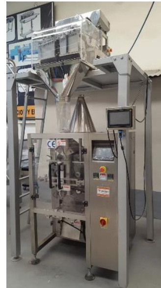
Figura A2. Envasadora Vertical Para Chifles Con Pesadora Lineal
