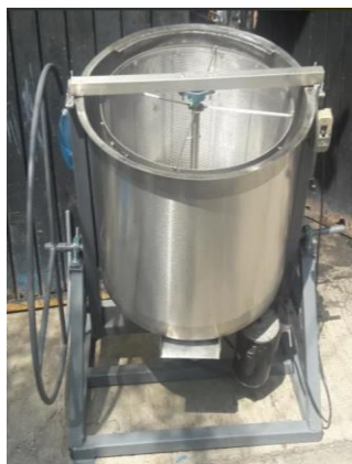
Figura A3. Centrifugadora De Volteo Industrial Para Botanas
