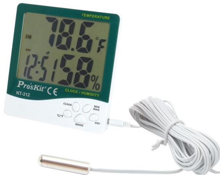
Figura 26. Termómetro Proskit NT312. (ELECO-G, 2019).
