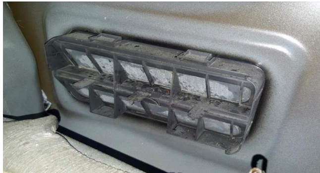
Figura 52. Válvulas Descongestionamiento de Presión Vista Interior.
