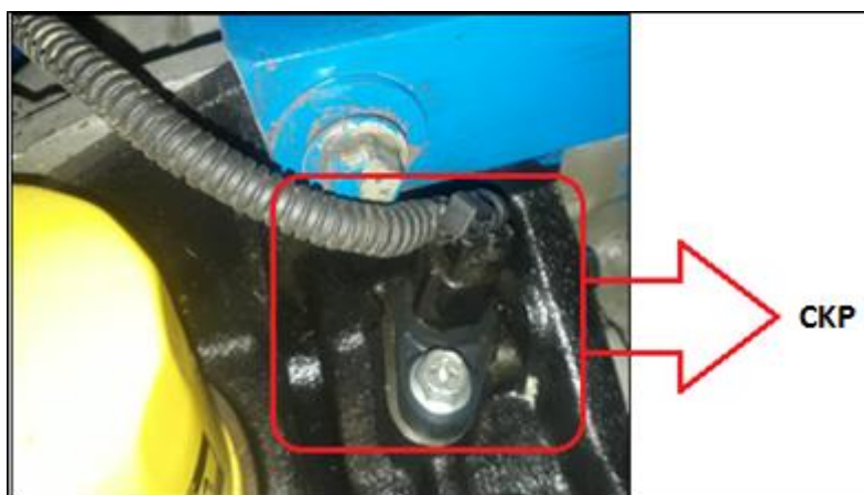
Figura 89. Ubicación del sensor CKP
