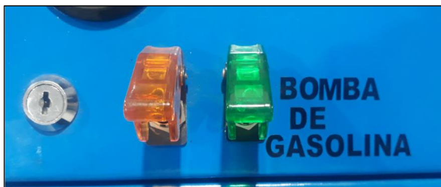
Figura 64. Encendido, corte de energía y activación de bomba de gasolina
