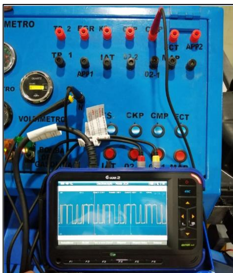
Figura 94. Conexión del osciloscopio en sensor CMP
