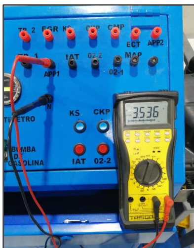
Figura 69. Conexión del multímetro al PPS
