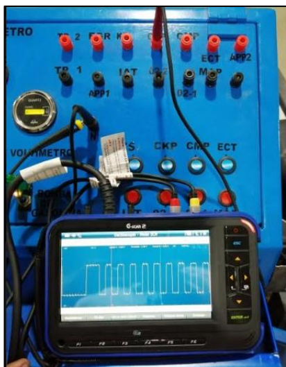
Figura 90. Conexión del osciloscopio en sensor CKP
