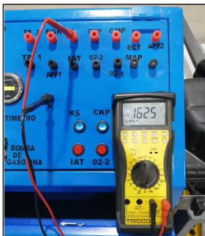
Figura 99. Medición del sensor KS
