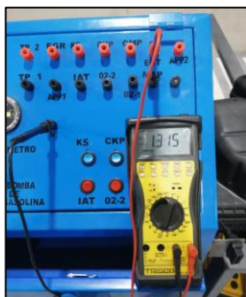
Figura 78. Conexión del multímetro al ECT
