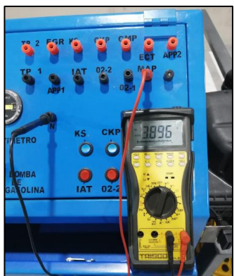
Figura 82. Conexión del multímetro al MAP
