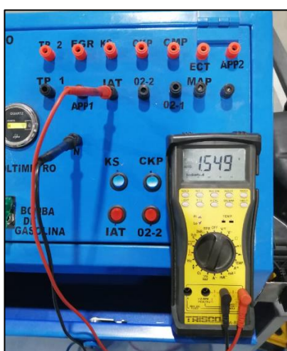
Figura 74. Conexión del multímetro al IAT
