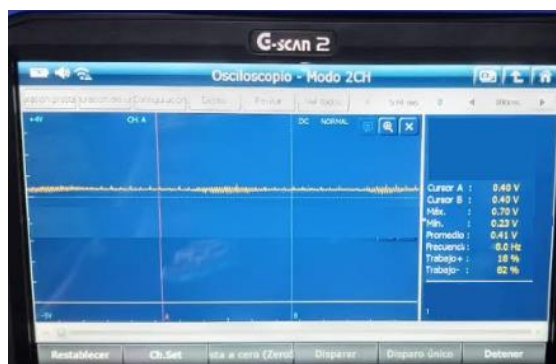
Figura 79. Señal del ECT
