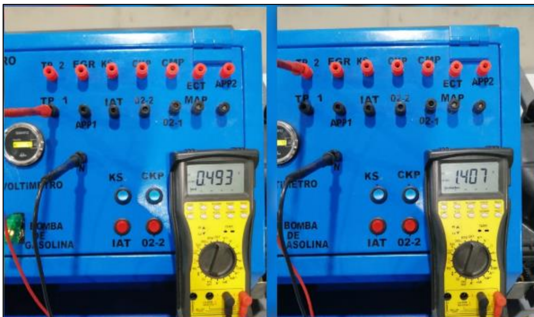
Figura 109. Conexión del multímetro al ETC
