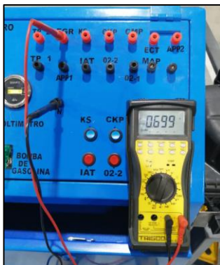
Figura 107. Medición de la posición de la mariposa de la válvula EGR
