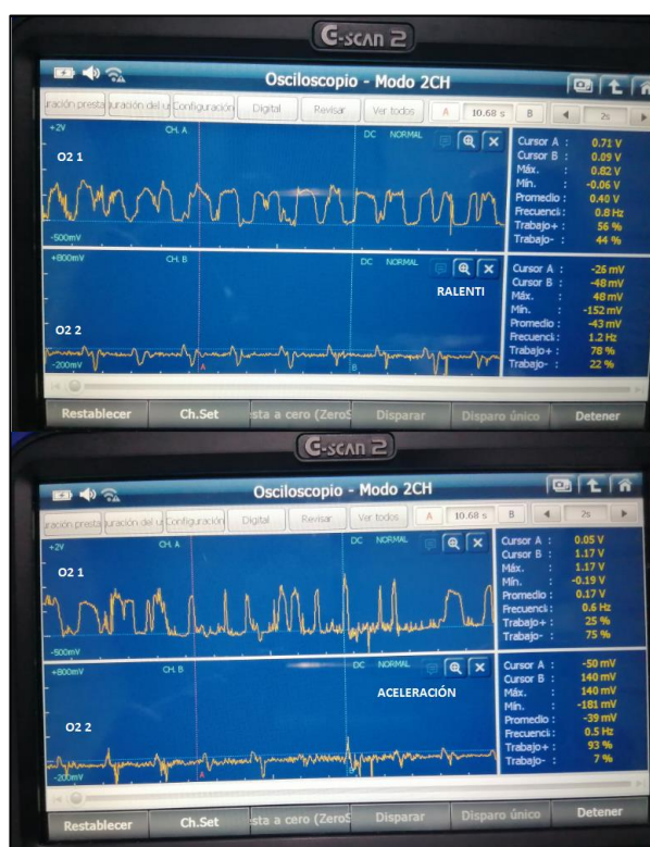
Figura 87. Señal del O 2
