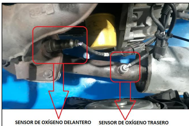
Figura 84. Ubicación de los sensores de oxígeno
