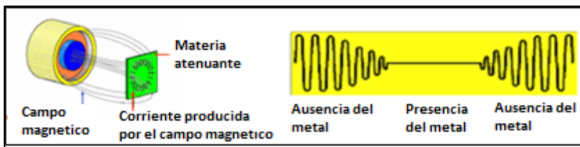
Figura 13. Principio de funcionamiento de los sensores tipo Inductivo
