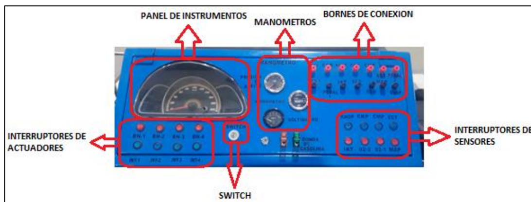
Figura 61. Descripción del tablero
