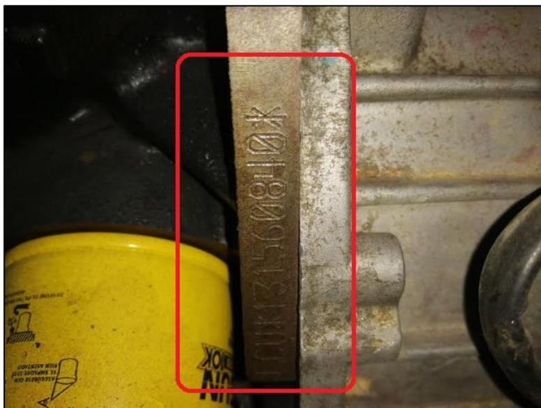
**Figura 3.** Ubicación del número de identificación del motor
