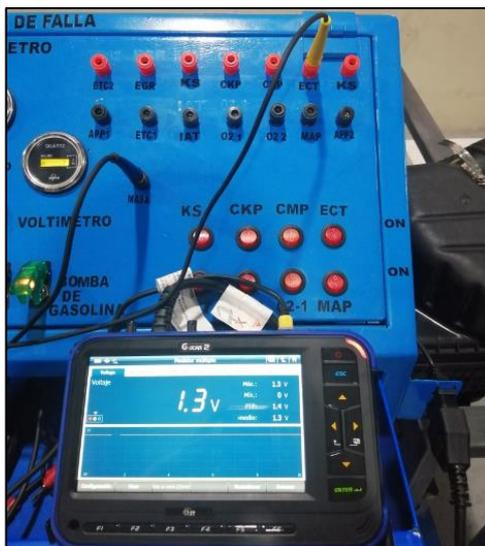
**Figura 58.** Mediciones de señal del ECT
