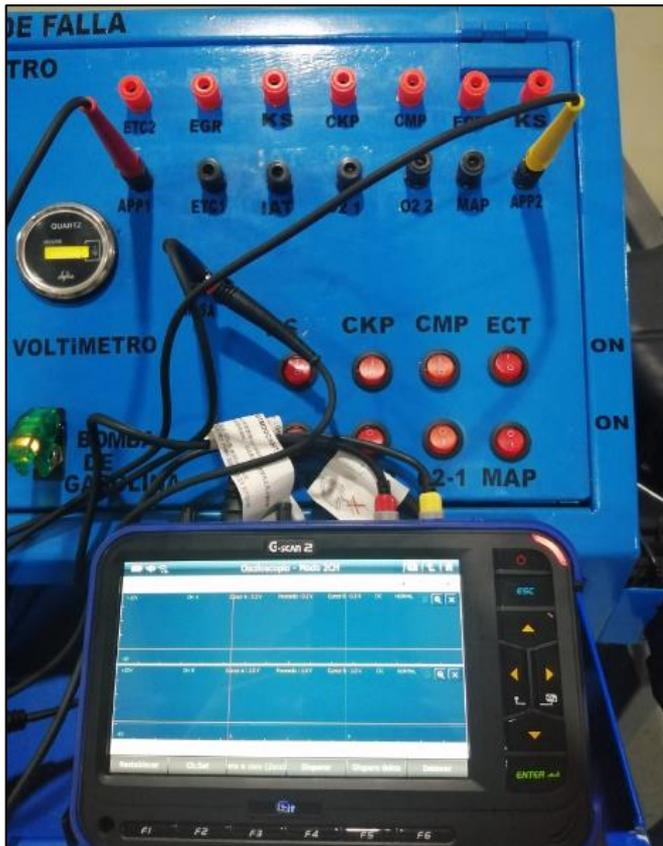
**Figura 55.** Conexión del osciloscopio a la señal del Pedal
