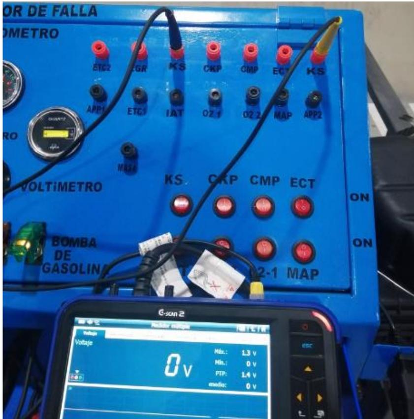
**Figura 70.** Conexión del osciloscopio para la señal del KNOCK
