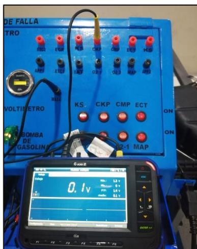
**Figura 64.** Conexión del osciloscopio para la señal del CKP
