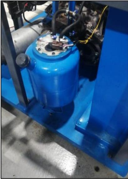
**Figura 52.** Colocación del tanque de combustible
