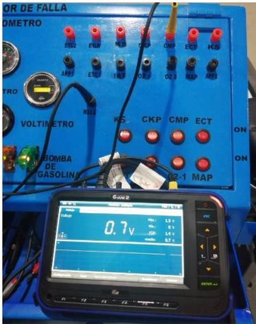
**Figura 67.** Conexión del osciloscopio para la señal del CMP
