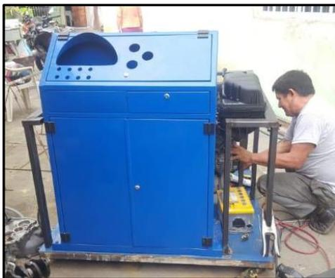
**Figura 45.** Ubicación de las bases del motor en la estructura principal
