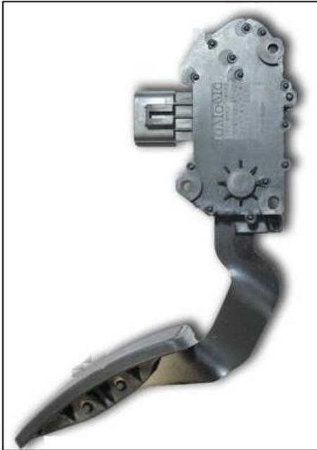
*Figura 12.* Pedal de aceleración
