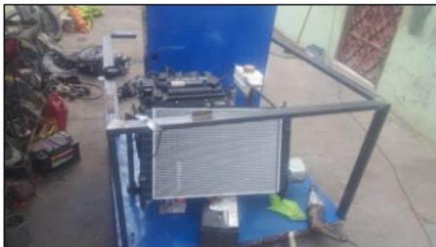
**Figura 51.** Colocación del radiador
