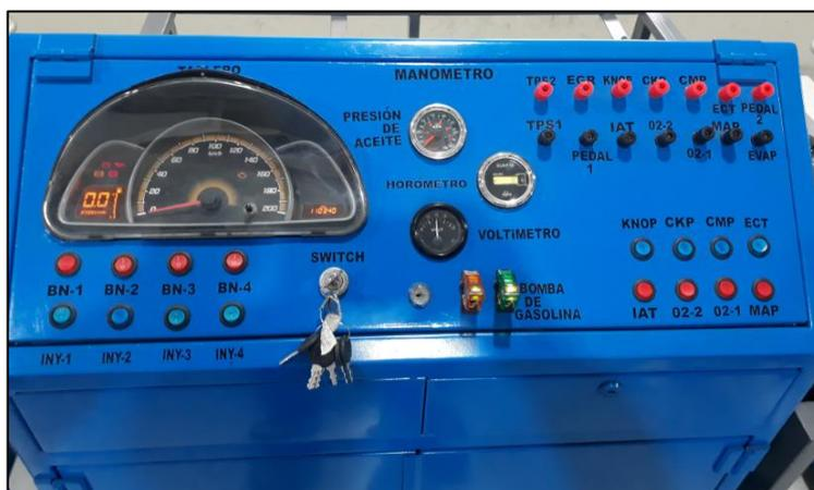
**Figura 47.** Panel de instrumentos de simulador de fallas
