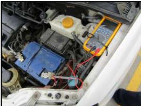
Figura 25. Medición de voltaje con multímetro
