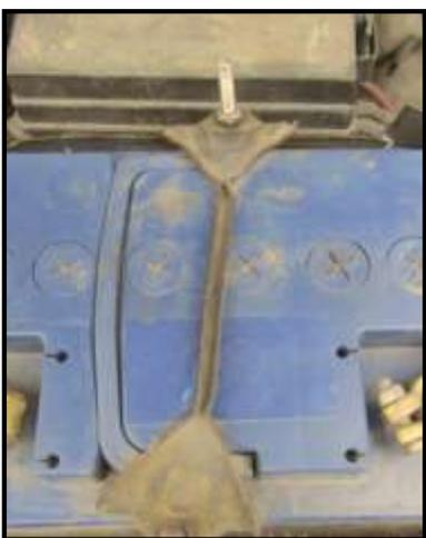
Figura 29. Ajuste correcto del bracket
