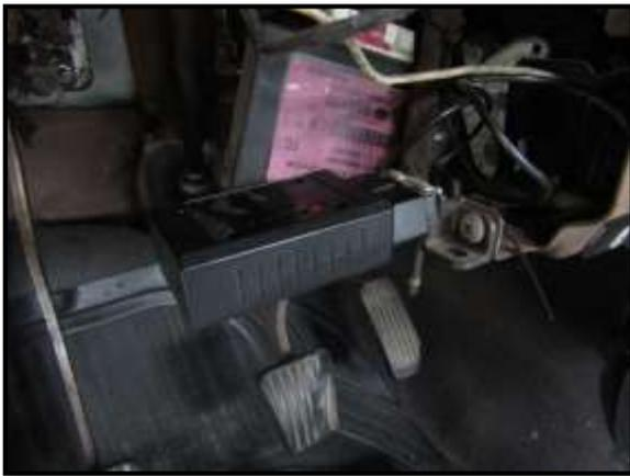
*Figura 26.* Conexión del OBDII ELM327
