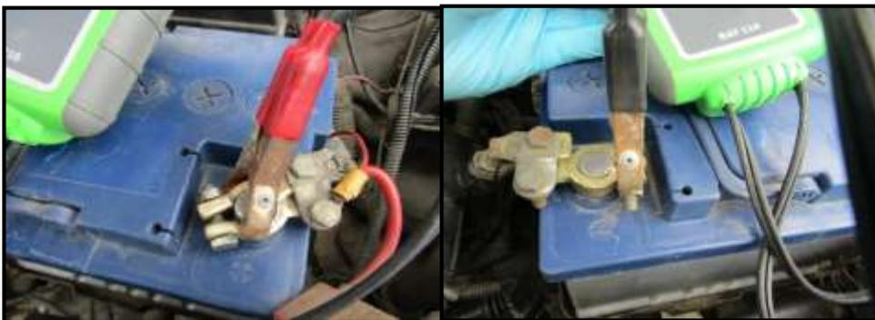
Figura 33. Conexión del BAT110
