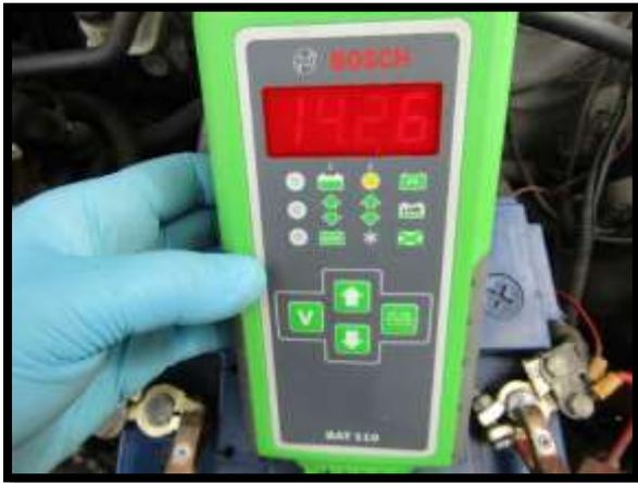
Figura 40. Registro de carga del alternador en la batería
