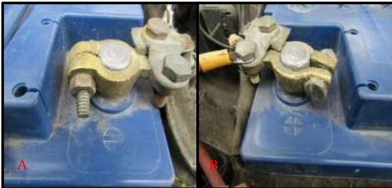
Figura 30. A. Borne negativo B. Borne positive
