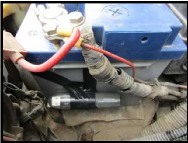
*Figura 23.* Instalación del sensor de temperatura USB
