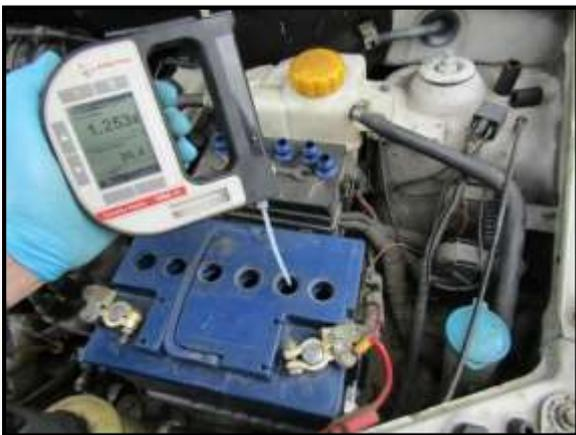
*Figura 38.* Medición de la densidad del electrolito
