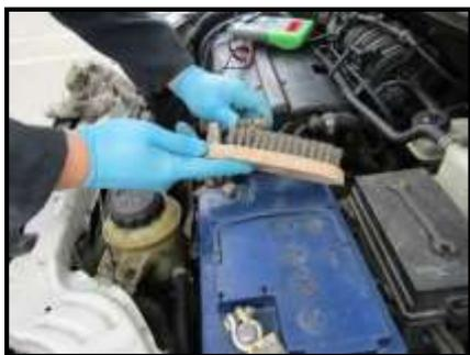
Figura 31. Limpieza de bornes con cepillo de cerdas metálicas
