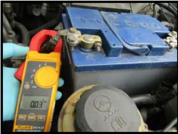
*Figura 39.* Medición de consumo en el circuito del vehículo
