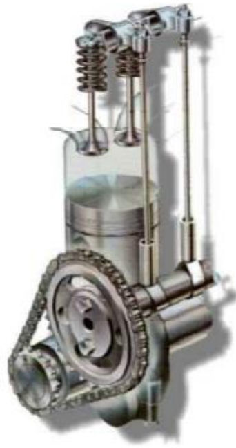
Figura 1.8 Sistema de distribución 8 .
