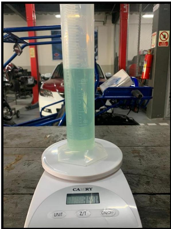
Figura 50. Probeta con 300ml de combustible.
