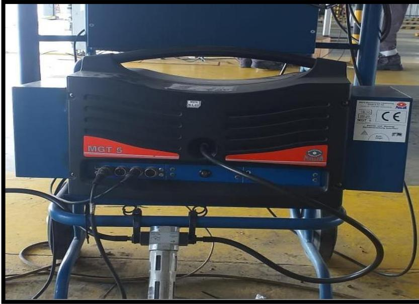
*Figura 54.* Analizador de gases MGT5 marca MAHA.
