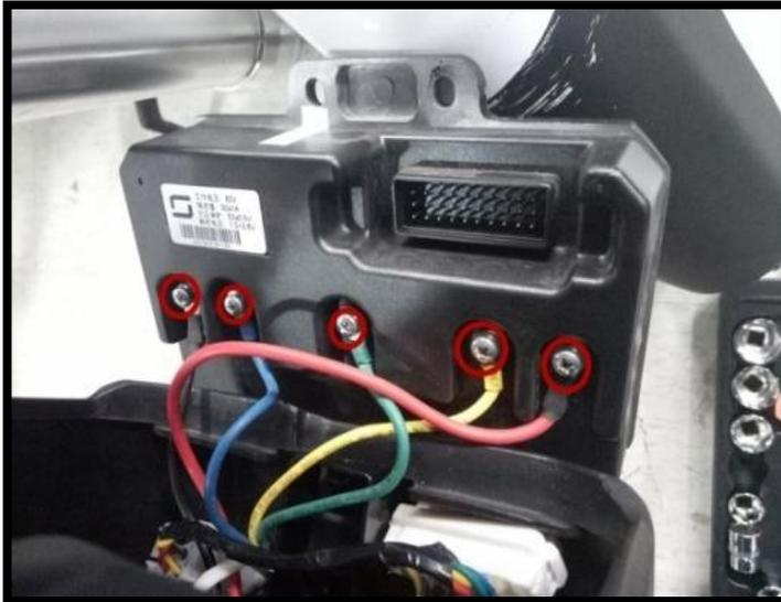
*Figura 59.* Controlador electrónico (Intercar, 2019).
