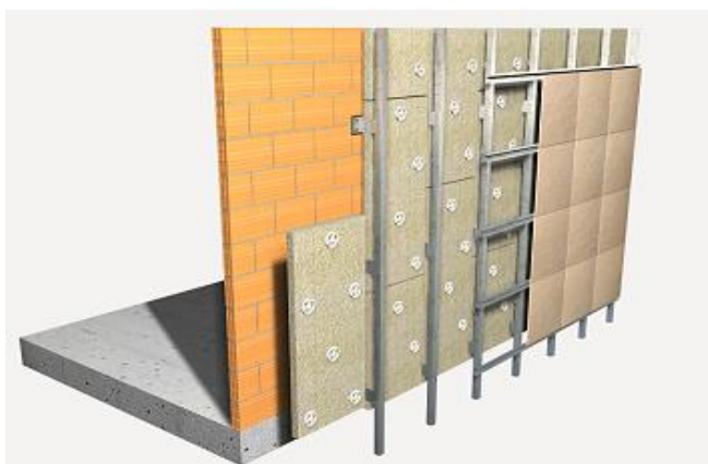
Figura 29 Fachadas y paredes con tratamiento acústico
