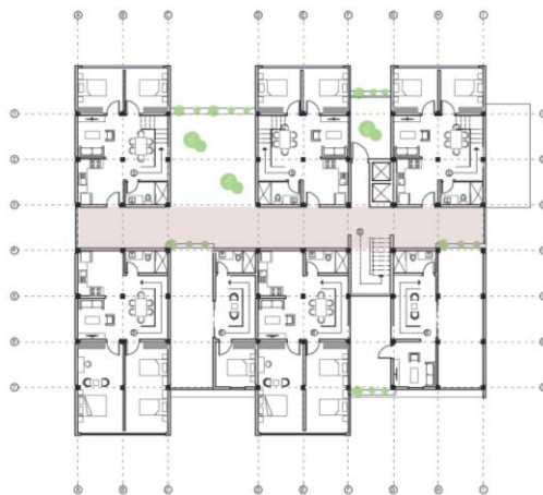
Gráfico 91: Propuesta arquitectónica. Planta tipo II de las edificaciones aisladas tipo III
