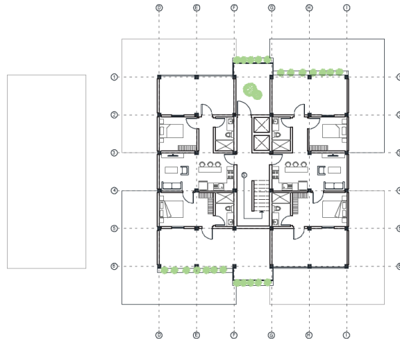
Gráfico 79: Propuesta arquitectónica. Planta tipo II de las edificaciones aisladas tipo I
