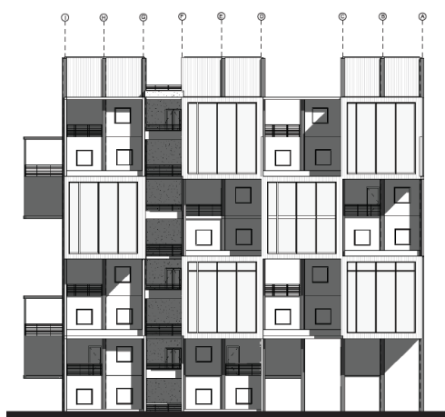
Gráfico 93: Propuesta arquitectónica. Elevación frontal de las edificaciones aisladas tipo III
