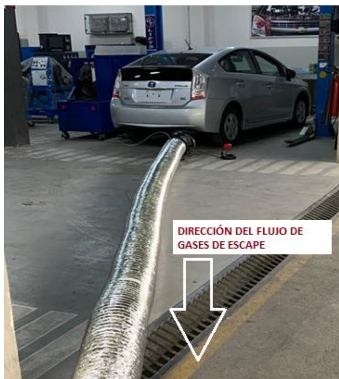
Figura 46 . Uso de la manga flexible para extractor móvil de gases
