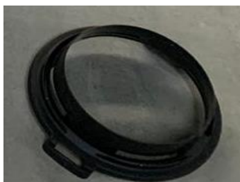
Figura 38. Acople de la entrada del extractor de gases
