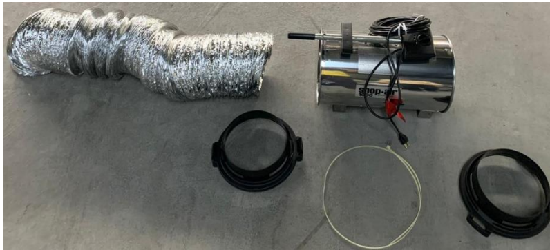
Figura 31. Partes del extractor de gases de escape
