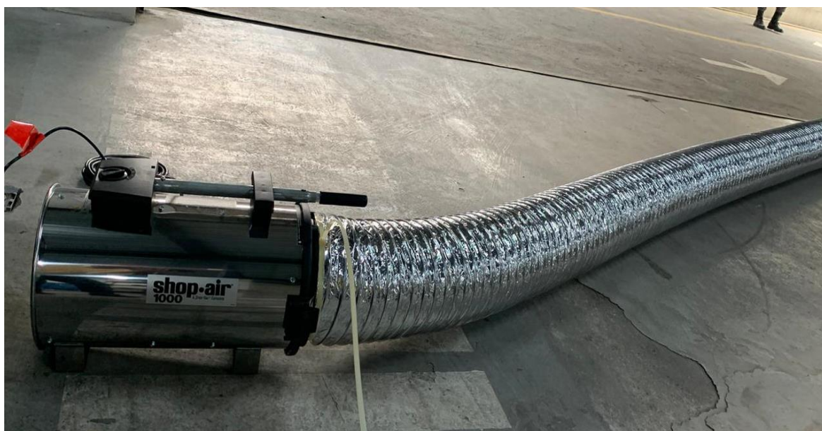
Figura 45. Uso de la manga flexible para extractor móvil de gases
