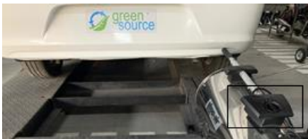
Figura 43. Prueba de extracción de gases
