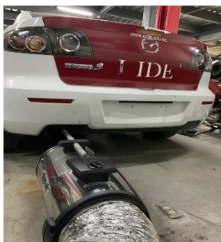
Figura 37. Disposición de ubicación del extractor
