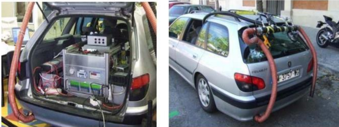
Figura 18. Sistema de medida de emisiones contaminantes – MIVECO-PEMS (Fonseca, 2009)
