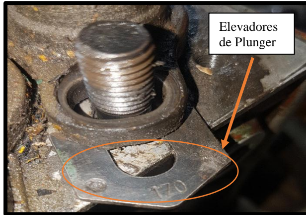
Figura 89. Instalación de los elevadores de los plunger. (Rodríguez, 2018)
