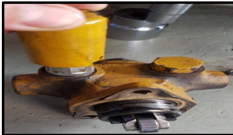
Figura 78. Extracción de la Bomba de Alimentación (Rodríguez, 2018)
