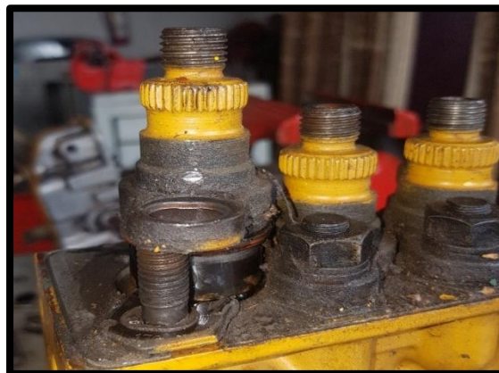
Figura 84. Extracción de los porta plunger de la Bomba.(Rodriguez, 2018)
