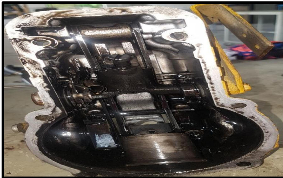
Figura 81. Extracción del Regulador de Velocidad de la Bomba. (Rodríguez, 2018)
