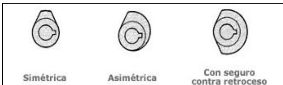
Figura 59. Forma de levas. ( http://www.aficionadosalamecanica.net/curso-bomba-linea.htm , 2014)
