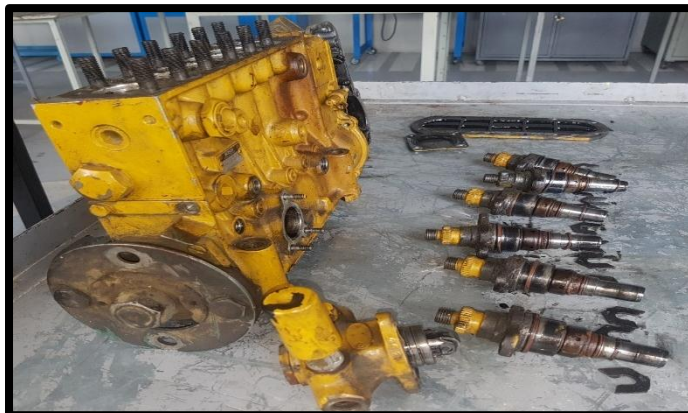
Figura 85. Extracción de los porta plunger en forma ordenada. (Rodríguez, 2018)
