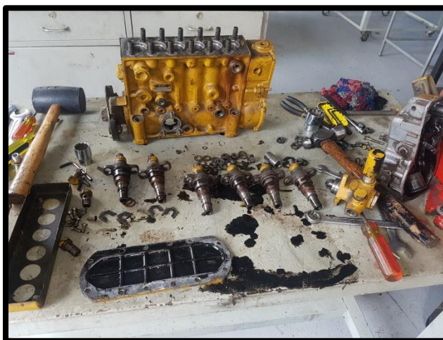
Figura 86. Despiece de la bomba de inyección. (Rodríguez, 2018)
