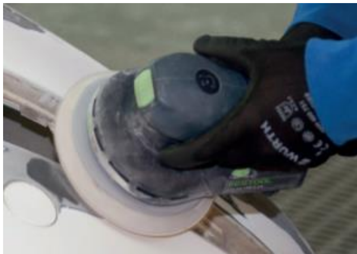
Figura 25. Lijado de masilla en superficie plástica
