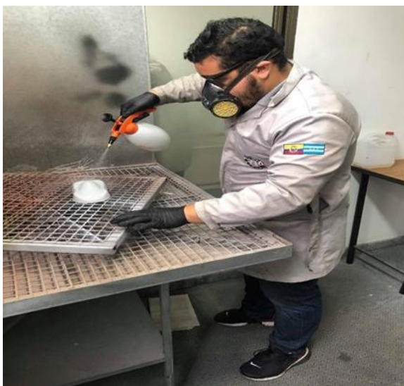
Figura 53. Eliminación de residuos de compuesto R
