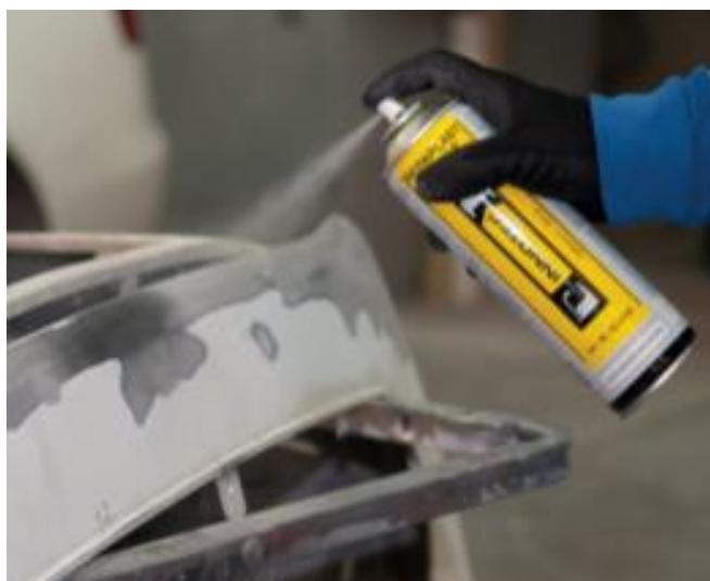
Figura 24. Aplicación de anclaje
