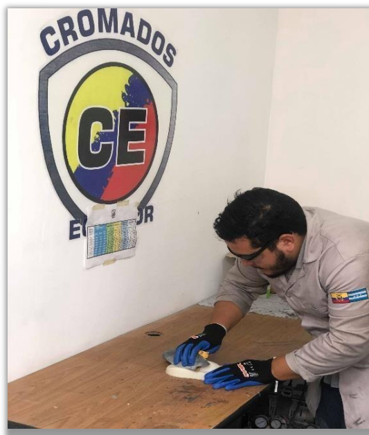
Figura 26. Eliminación de residuos sobre superficies plásticas
