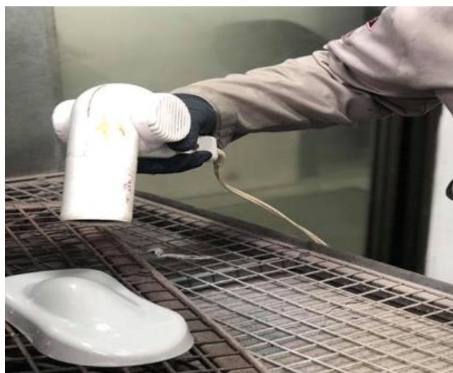
Figura 50. Secado de residuos de agua desionizada
