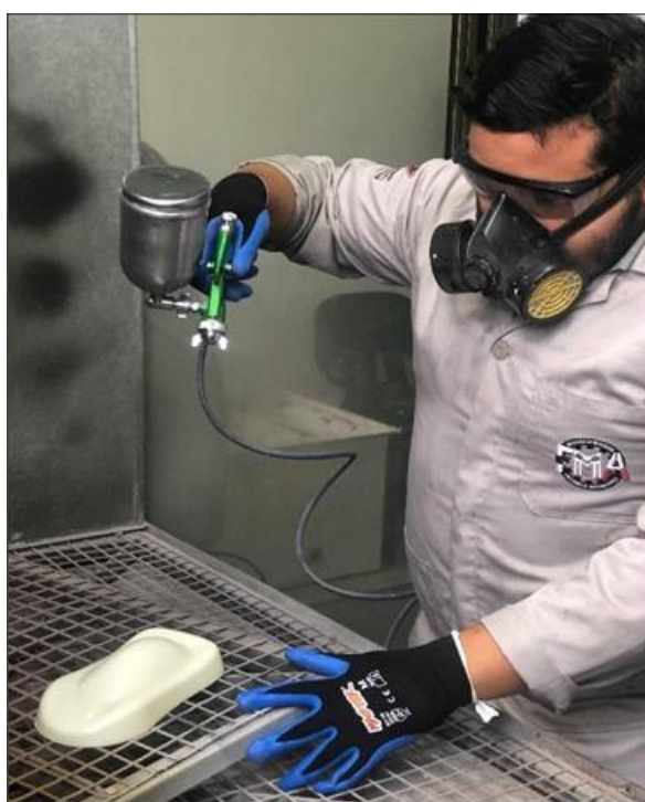
Figura 31. Atomización del adherente
