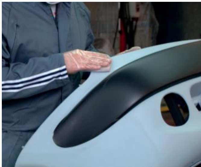
Figura 21. Preparación de superficie plástica
