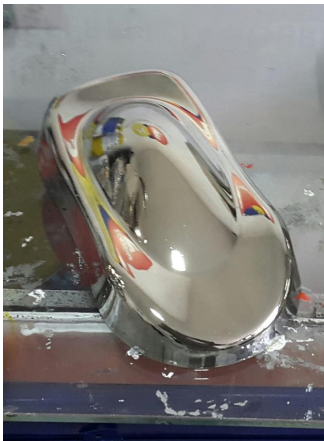
Figura 57. Obtención de pieza plástica cromada
