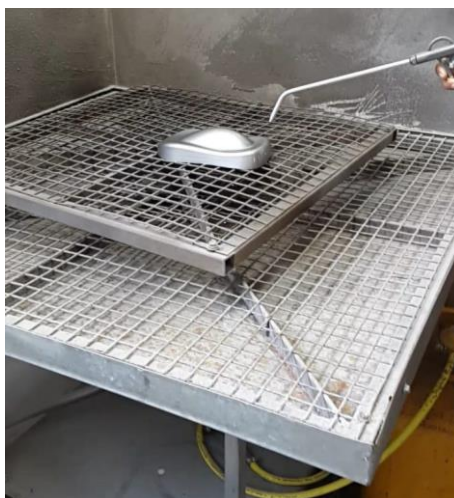
Figura 54. Eliminación de residuos de compuesto G y C
