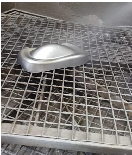
Figura 56. Eliminación de residuos de sellador
