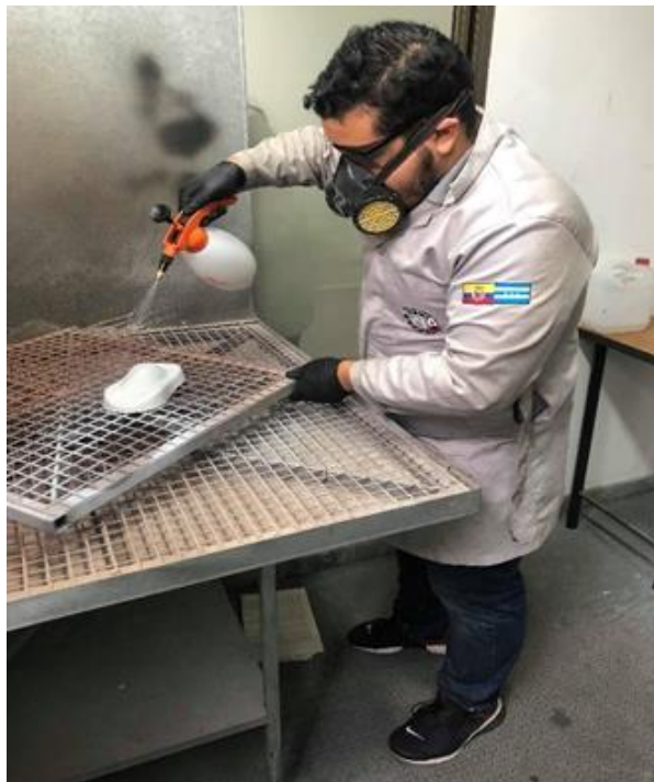
Figura 49. Atomización de agua desionizada
