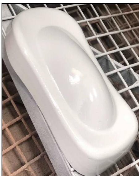
Figura 36. Pieza plástica con recubrimiento de barniz poliuretano
