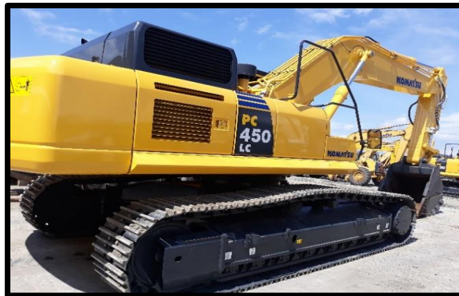
Figura 4. Vista lateral derecha de una Excavadora PC450LC (Diteca S.A., 2019)
