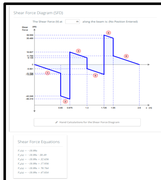
Figura 40. Visualización de esfuerzos con sus distancias (Jara, 2019)
