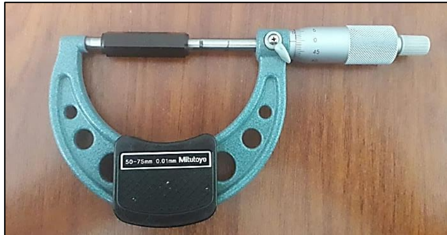
Figura 83. Proceso de calibración del micrómetro a través del patrón de medida (a 20°C)
