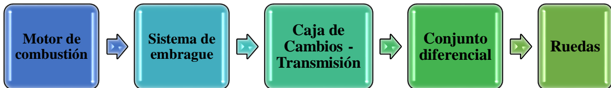
Figura 29. Flujo de potencia de la maquinaria agrícola
