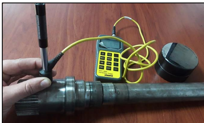
Figura 107. Fotografía durante una de las pruebas de dureza realizada sobre el eje de transmisión
