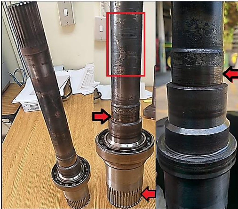
Figura 76. Puntos de averías del eje YZ9406 de la transmisión TSS
