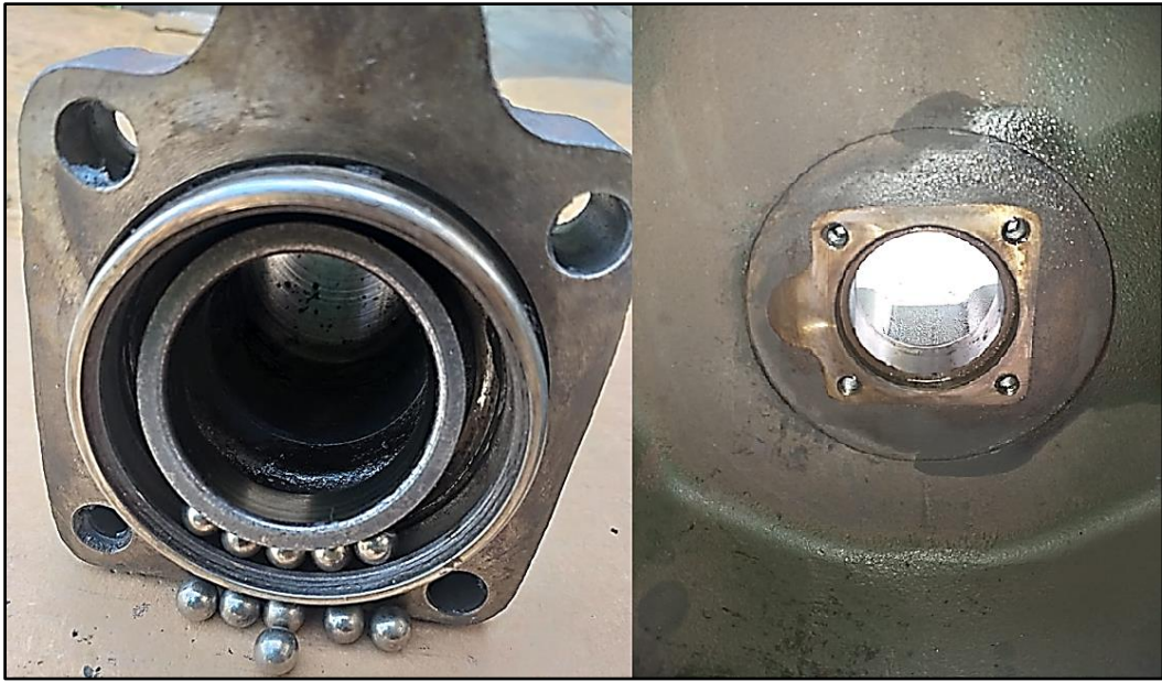
Figura 74. Ovalamiento en el alojamiento del rodamiento YZ90831
