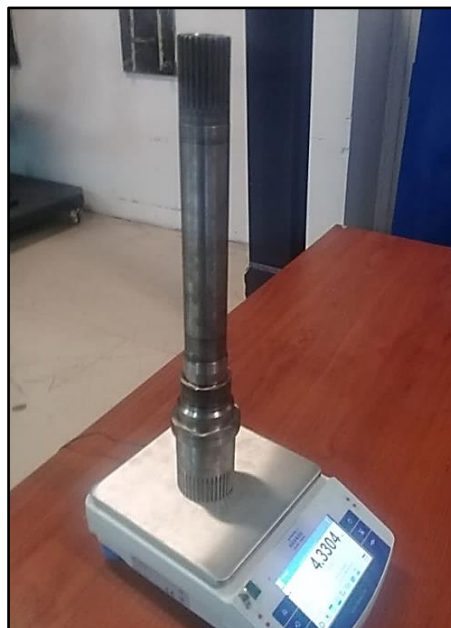
Figura 97. Medición de la masa del eje a través de la balanza electrónica
