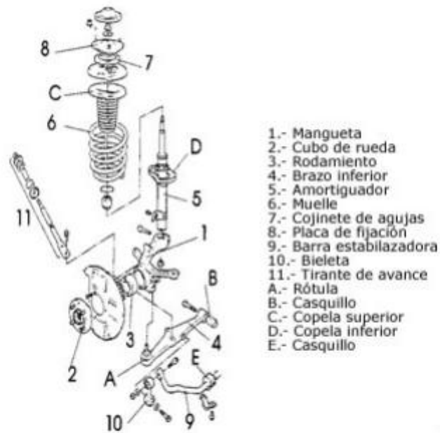
Figura 3.21. Detalle de una suspensión McPherson
