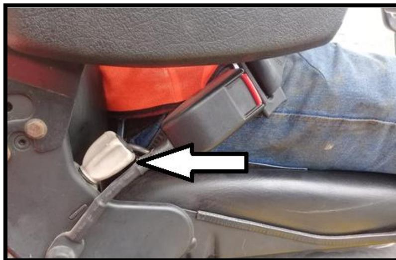
**Figura 81.** Rodillo de ajuste de inclinación
