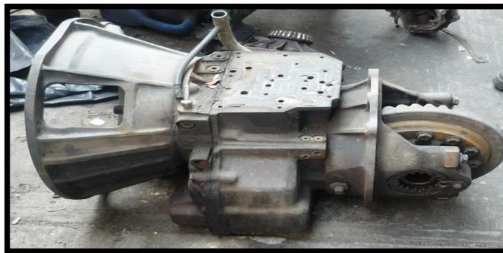
*Figura 28.* Transmisión automática de Heli
