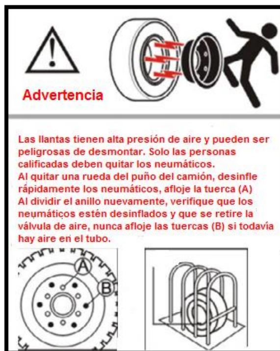
*Figura 70.* Advertencia de seguridad sobre los neumáticos (Heli, 2019)
