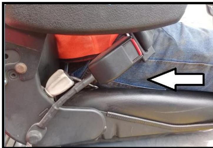
*Figura 83.* Ajuste de cinturón de dos puntos
