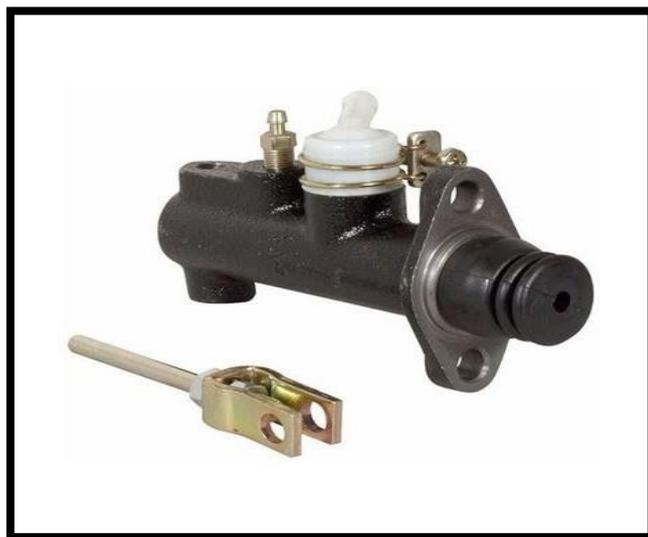
*Figura 35.* Cilindro maestro de freno (Perez, 2014)
