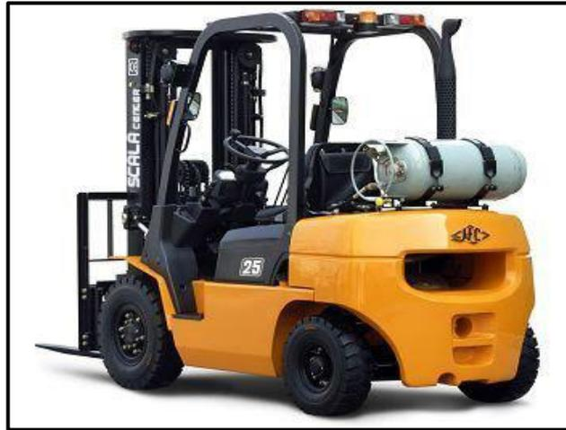
*Figura 12.* Montacargas a combustión DUAL (CREIXER, 2019).
