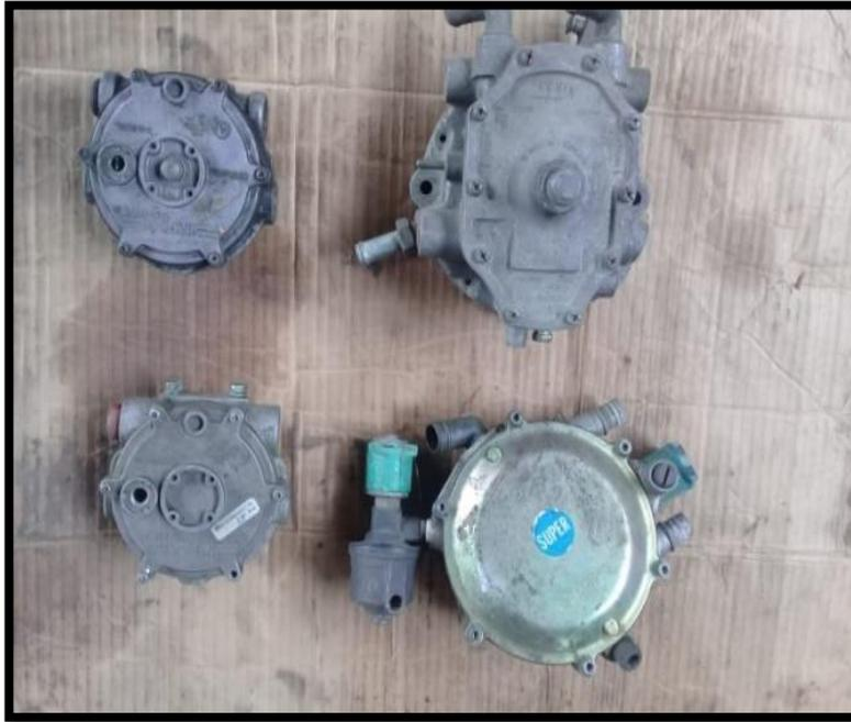
*Figura 22.* Modelos de evaporadores GLP
