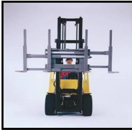
*Figura 53.* Aditamento horquilla ajustable
