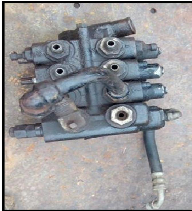
*Figura 45.* Control de válvula de sistema hidráulico
