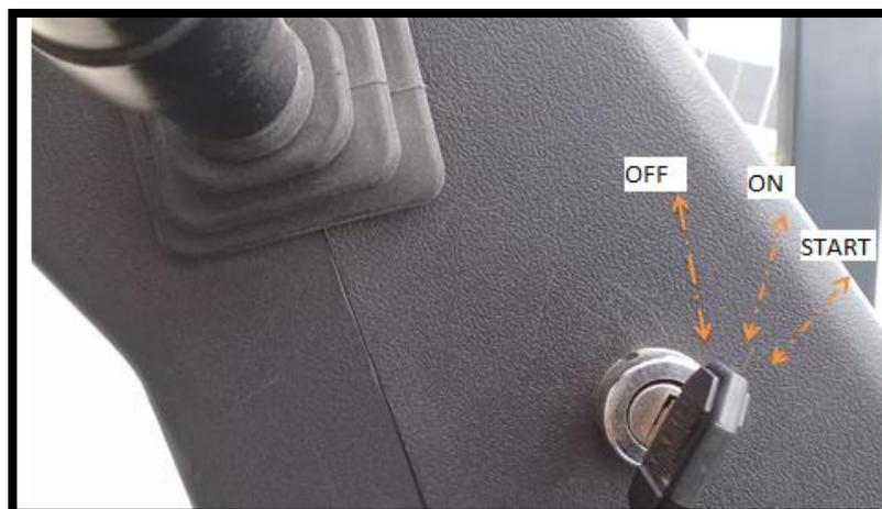
*Figura 86.* Posición de encendido del montacargas
