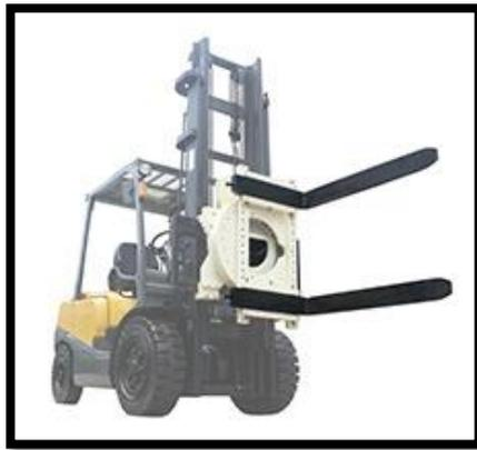
*Figura 51.* Aditamento tipo rotador (Heli, 2019)
