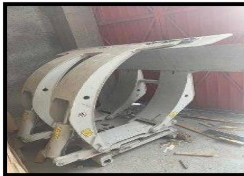
*Figura 50.* Aditamento tipo abrazadera
