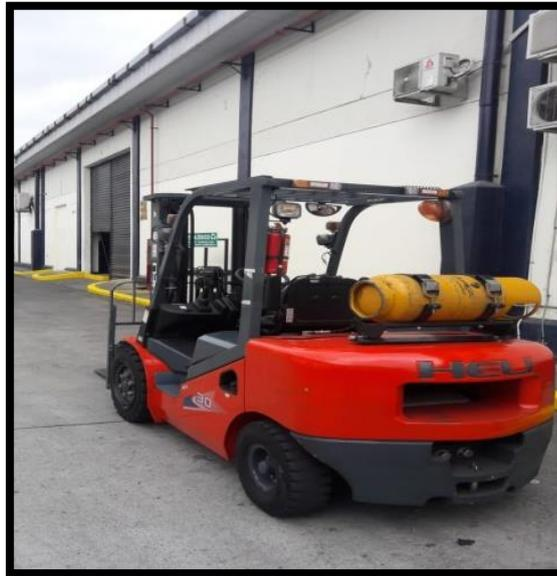
*Figura 18.* Tanque de 16 kg de combustible GLP
