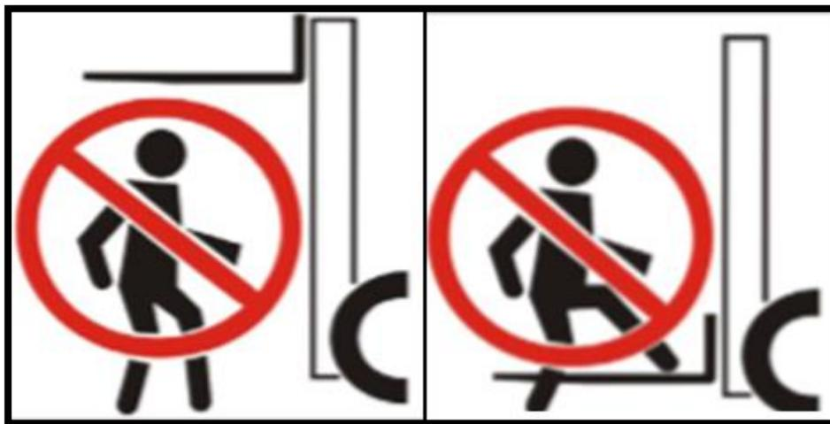
*Figura 76.* No pararse por debajo ni por encima de las horquillas (Heli, 2019)
