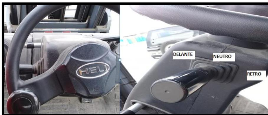
**Figura 88.** Palanca selectora de cambios automáticos
