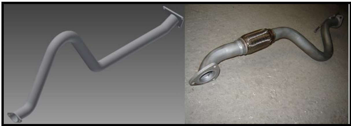
Figura 27 Tramo intermedio dibujado en CAD y original.
