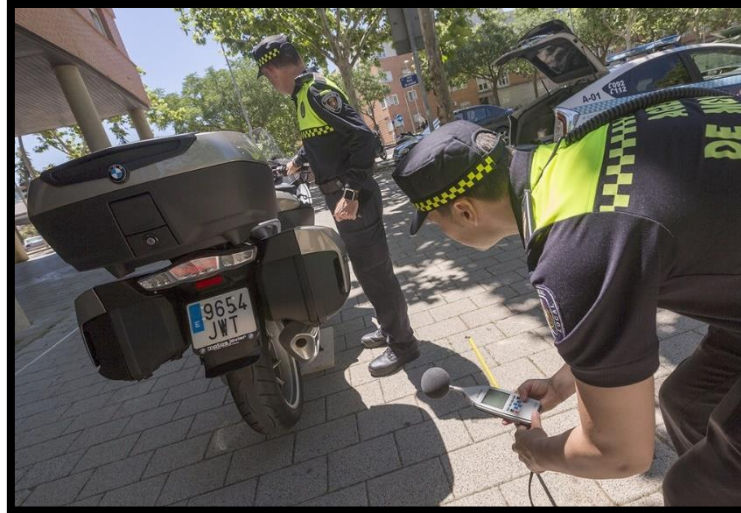
Figura 19 Medición del ruido que producen los vehículos en el ambiente con un sonómetro.
