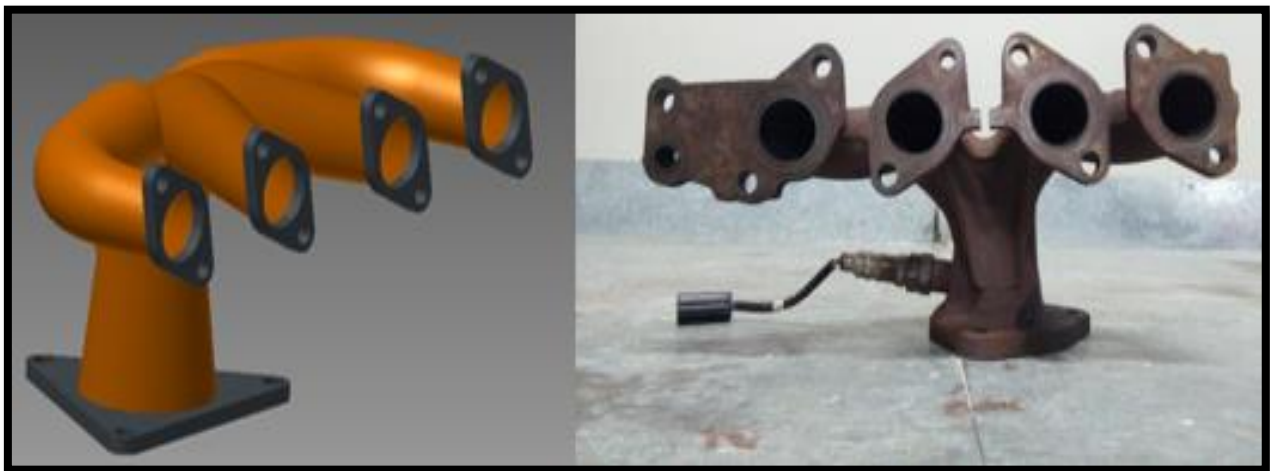
Figura 25 Múltiple de escape dibujado en CAD y original.
