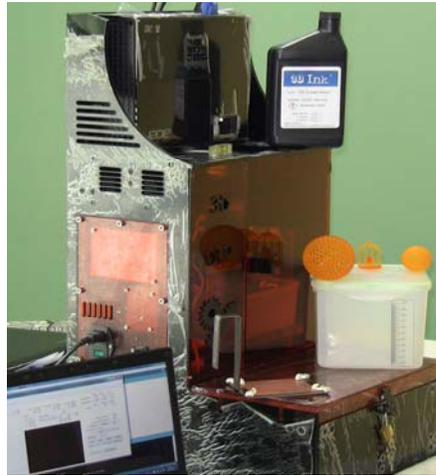
Figura 1.29. Impresora 3D con tecnología DLP realizada en la ESPE
