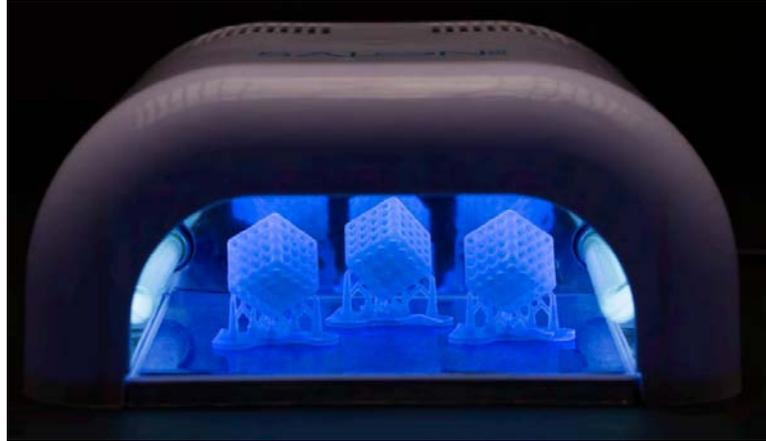
Figura 1.8. Proceso de Curado de la pieza impresa
