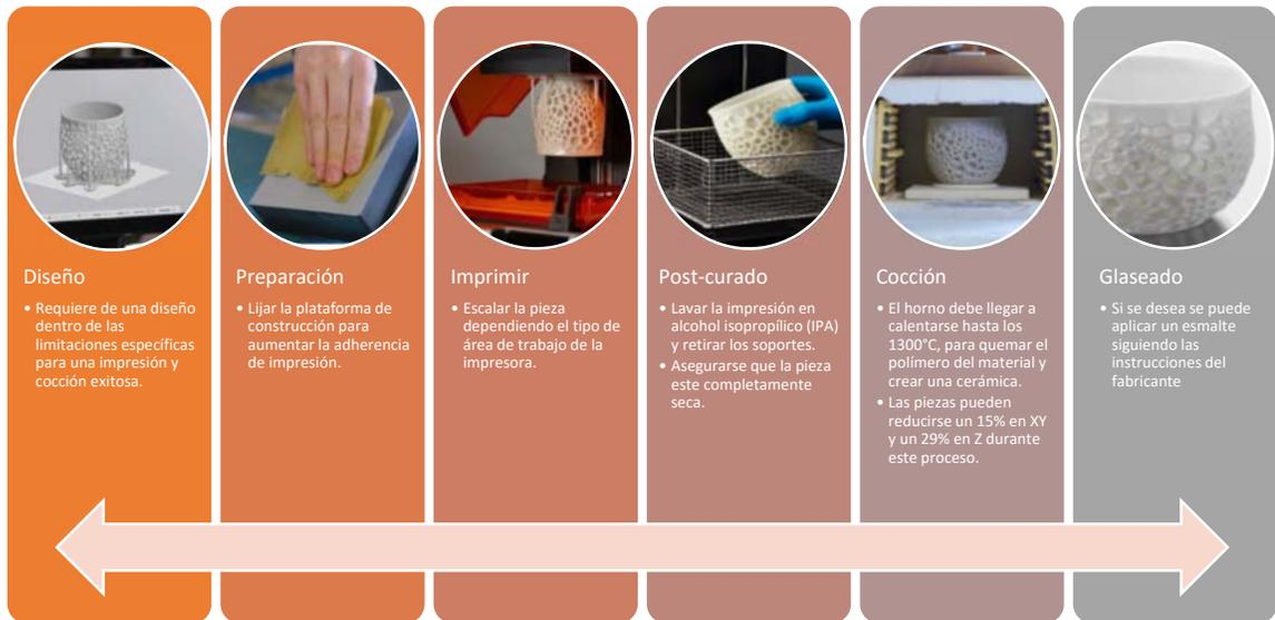
Figura 1.10. Procesamiento del desarrollo de una pieza con resina de cerámica
