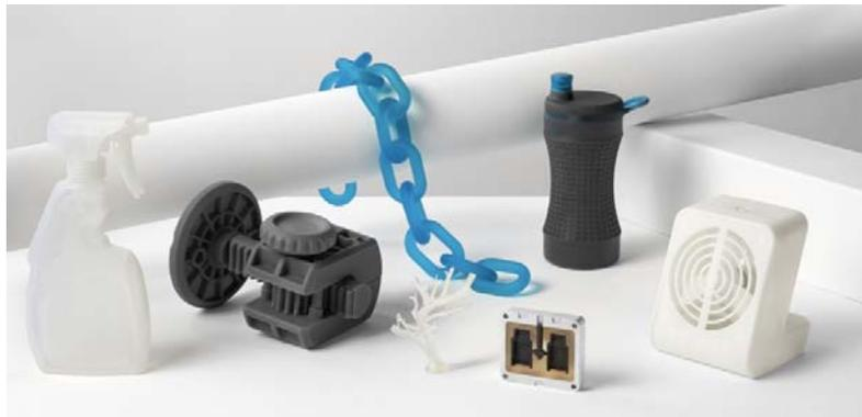
Figura 1.16. Piezas y prototipos impresos con los distintos tipos de resina para ingeniería
