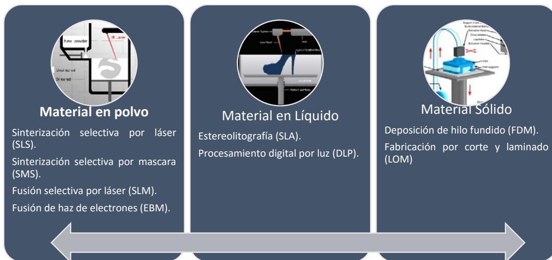
Figura 1.4. Tipos de prototipado 3D de acuerdo al tipo de material prima
