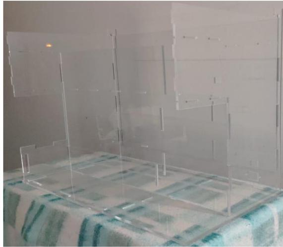
*Figura 4.2. Piezas de acrílico del prototipo ensambladas*
