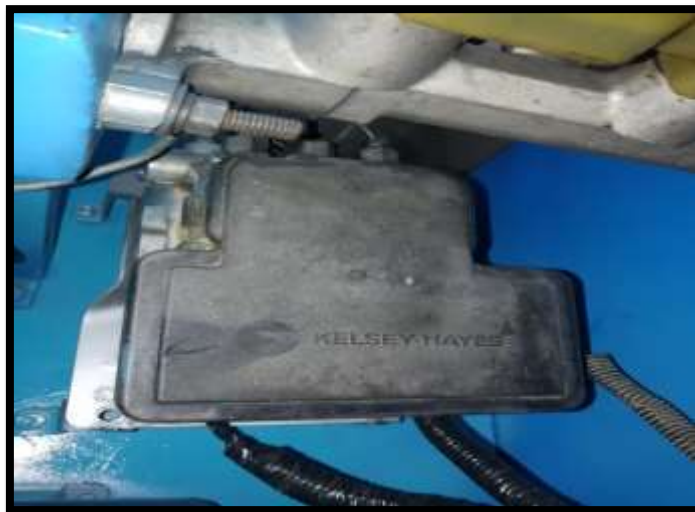
Figura 93. Alimentación del modulador (Tomalá, 2019)
