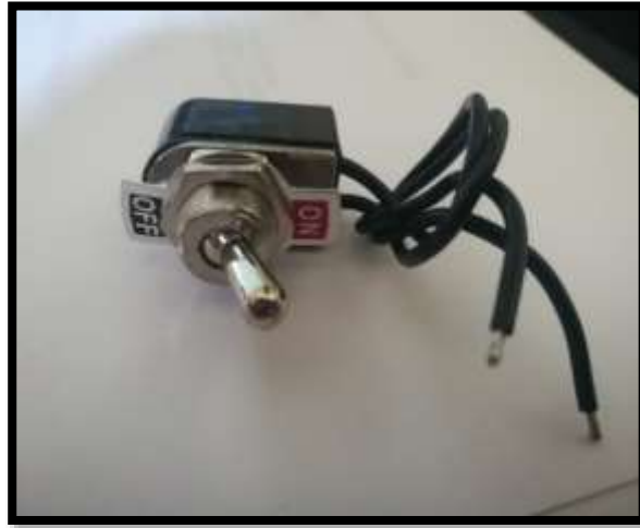
Figura 84. Interruptor para la simulación de fallas (Tomalá, 2019)
