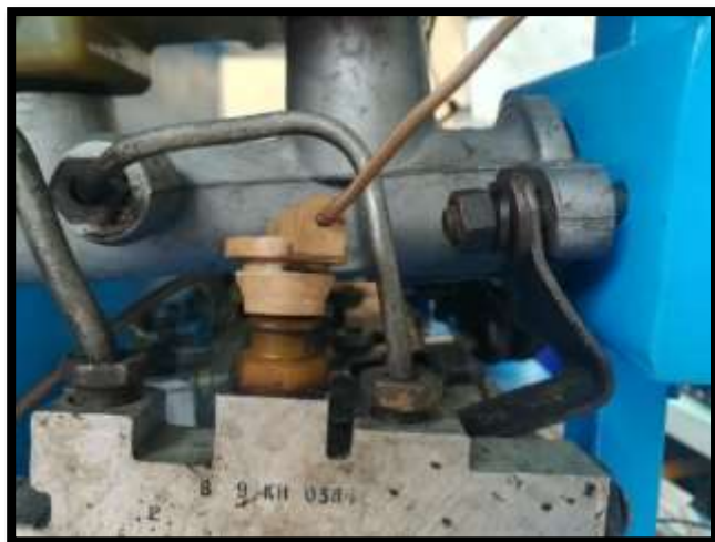
Figura 91. Alarma de bajo nivel (Tomalá, 2019)
