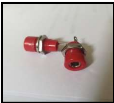
Figura 86. Conectores para pruebas (Tomalá, 2019)
