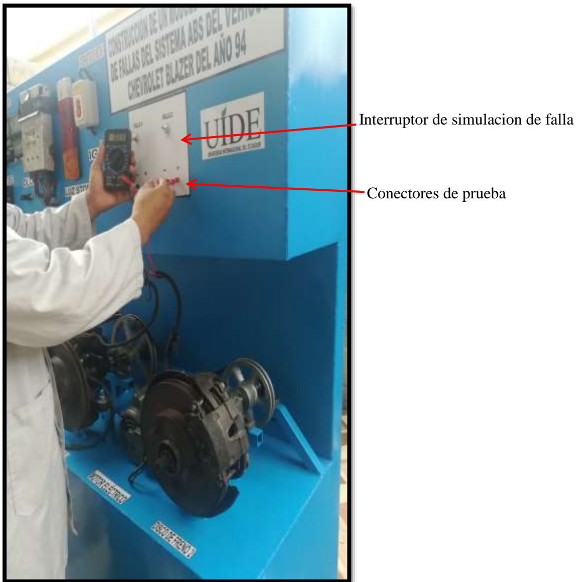
Figura 106. Generación de voltaje de los sensores de las ruedas (Tomalá, 2019)
