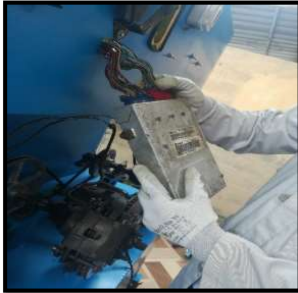
Figura 92. Conexión de la ECU (Tomalá, 2019)
