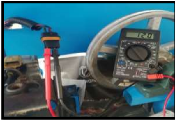
Figura 101. Alimentación de módulo ABS (Tomalá, 2019)
