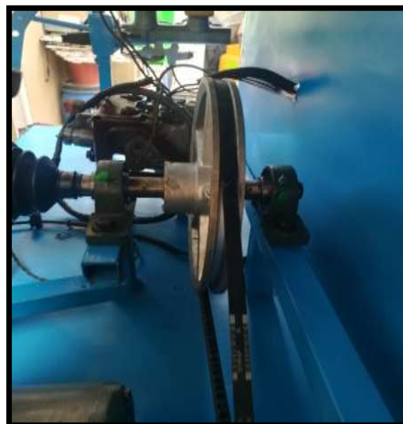
Figura 77. Montaje de las chumaceras 2 (Tomalá, 2019)
