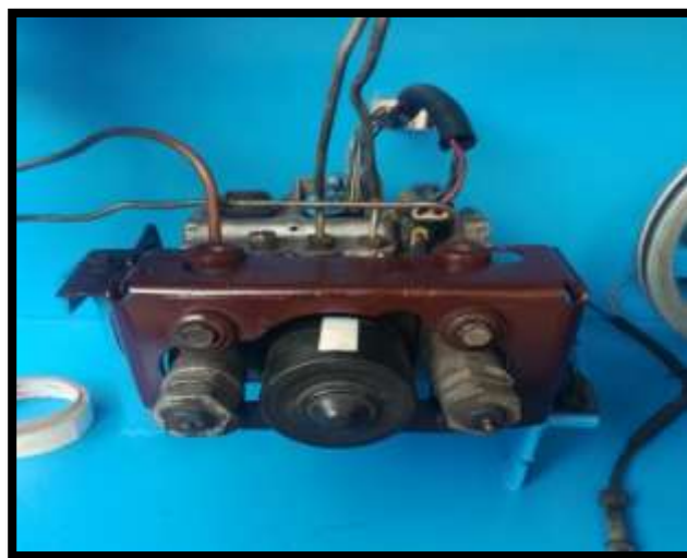
Figura 68. Montaje de modulador de presión (Tomalá, 2019)
