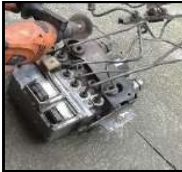
Figura 61. Mantenimiento al módulo controlador de presión (Tomalá, 2019)
