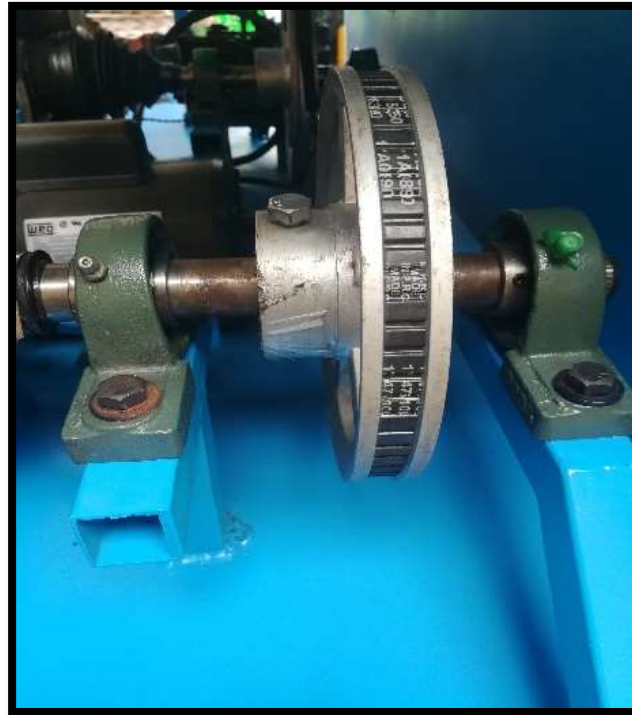
Figura 76. Montaje de las chumaceras 1 (Tomalá, 2019)
