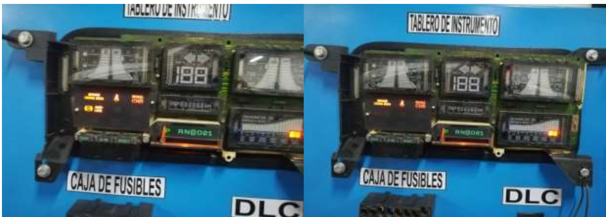
Figura 107. Activación del alerta ABS (Tomalá, 2019)
