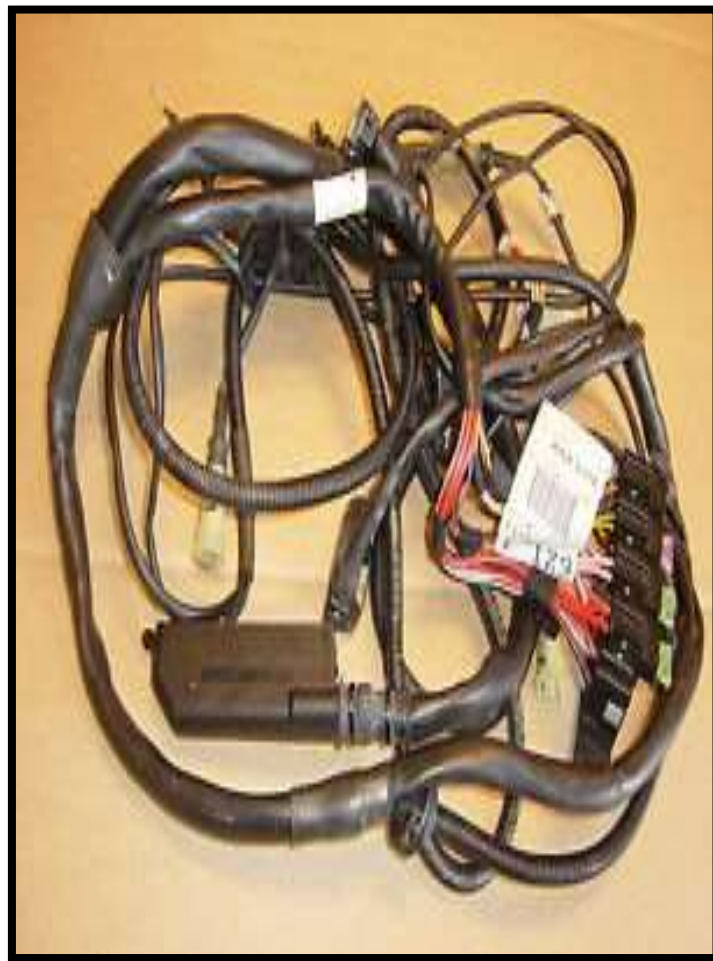
Figura 25. Arnés eléctrico (Tomalá, 2019)
