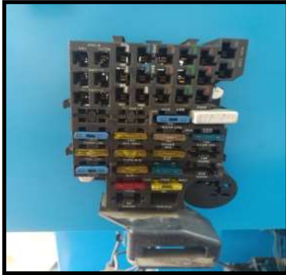
Figura 88. Caja de fusibles (Tomalá, 2019)
