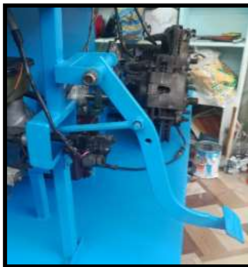
Figura 72. Montaje de pedal de freno (Tomalá, 2019)
