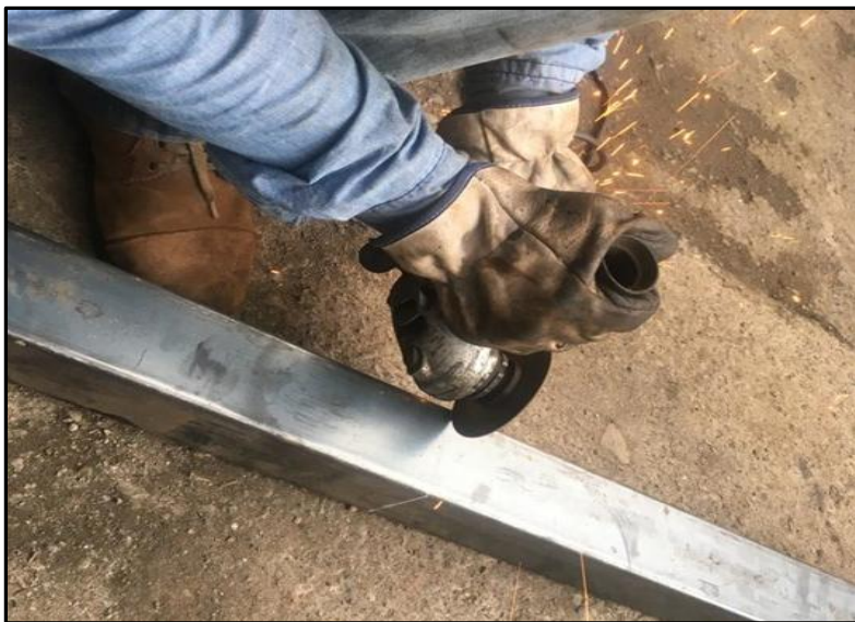
Figura 52. Inicio de corte con un disco de corte Fuente. Ángel Paredes
