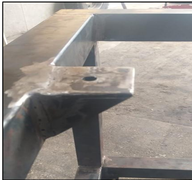
Figura 62. Base que soporta el motor Fuente. Ángel Paredes
