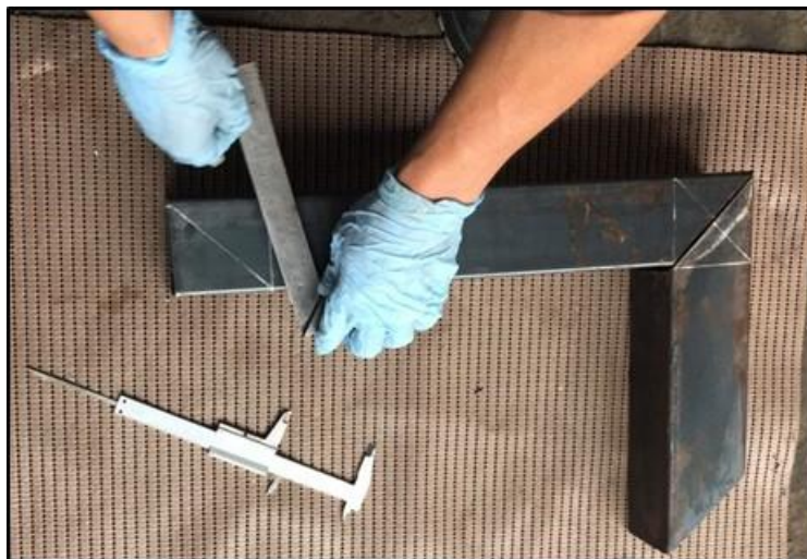
Figura 54. Marcado de corte en ángulos Fuente. Ángel Paredes
