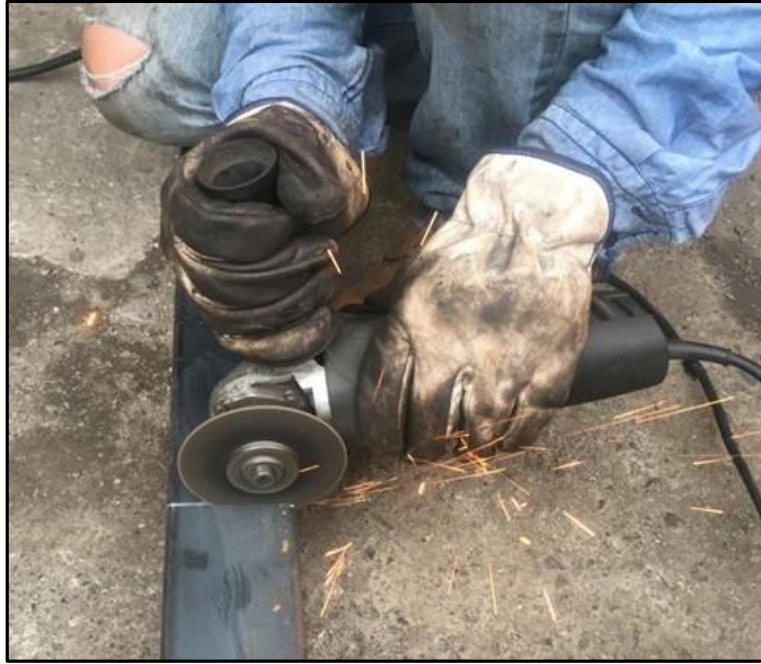
Figura 53. Proceso de corte con un disco de corte Fuente. Ángel Paredes
