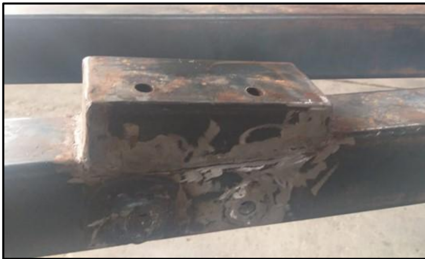
Figura 64. Base lateral de soporte del motor Fuente. Ángel Paredes
