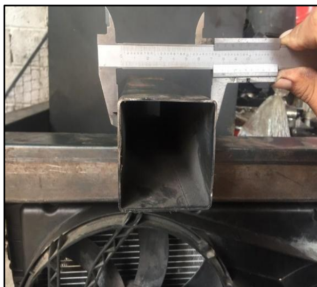
Figura 47 Medición del espesor y ancho del tubo cuadrado negro
