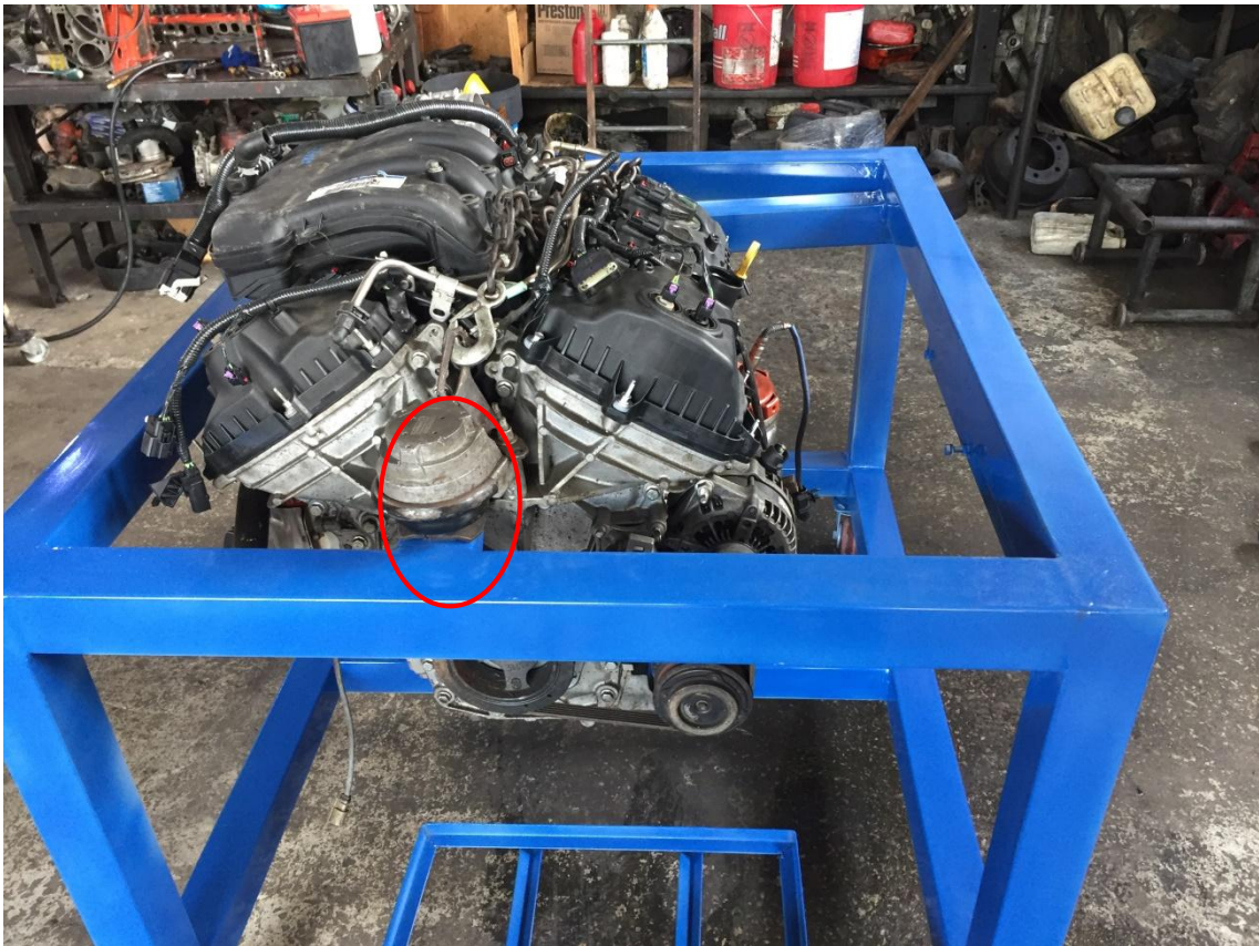
Figura 73. Fijación del motor en la estructura Fuente. Ángel Paredes
