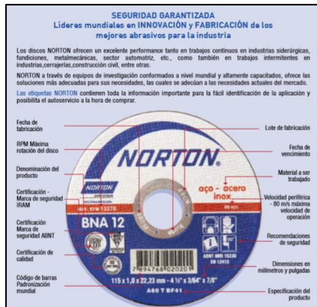
Figura 19. Información de etiquetado del disco de corte Fuente. Ángel Paredes
