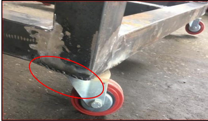
Figura 61. Garruchas soldadas en la base del tubo Fuente. Ángel Paredes
