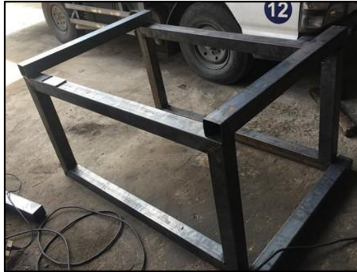
Figura 59. Armado de los tubos Fuente. Ángel Paredes
