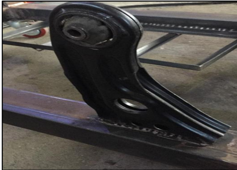
Figura 65. Base inferior para la caja de cambios Fuente. Ángel Paredes
