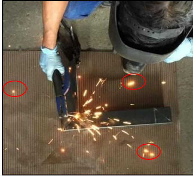
Figura 57. Proceso de punteado de soldadura Fuente. Ángel Paredes
