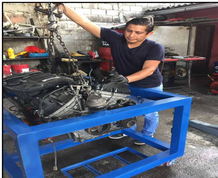
Figura 72. Ubicación del motor en la estructura Fuente. Ángel Paredes
