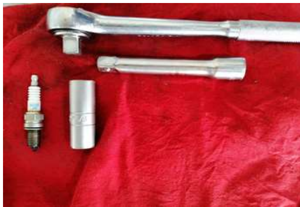
Figura 38 Desmontaje de bujías (Torres, 2019)
