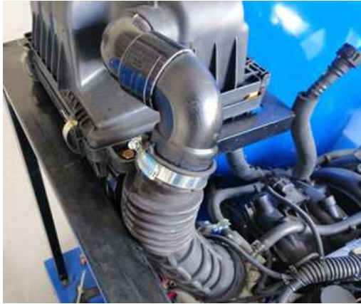
Figura 25 Ensamble de filtro de aire (Torres, 2019)
