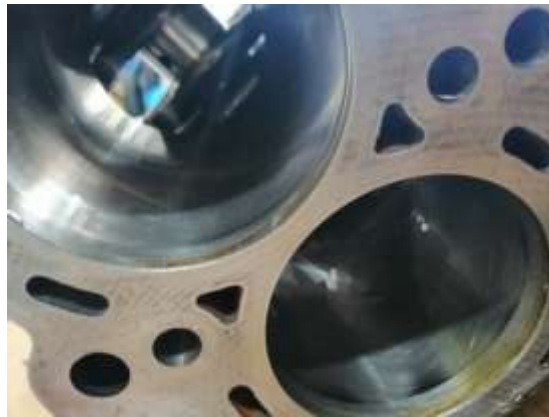
Figura 96 Limpieza de cilindros (Torres, 2019)
