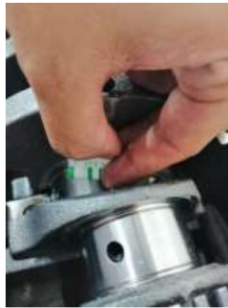
Figura 88 Medición de luz de aceite (Torres, 2019)
