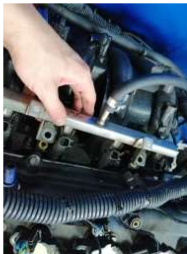
Figura 81 Instalación riel de combustible (Torres, 2019)
