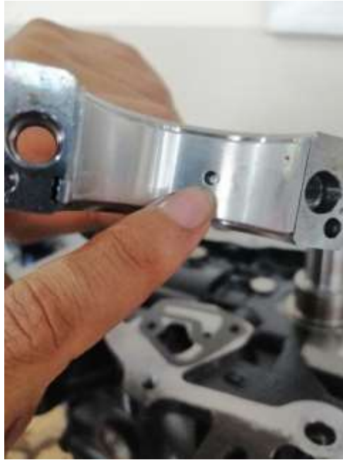
Figura 54 Extracción de cojinetes (Torres, 2019)
