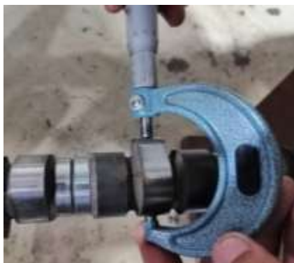
Figura 84 Evaluación de altura de leva (G.M., 2012)
