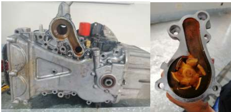
Figura 44 Desmontaje tapa de bomba de agua (G.M., 2012)
