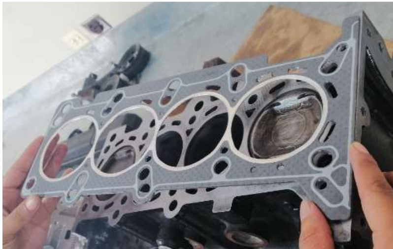
Figura 4 Junta de cabezote (Torres, 2019)
