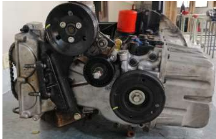
Figura 42 Remover polea de cigüeñal (Torres, 2019)
