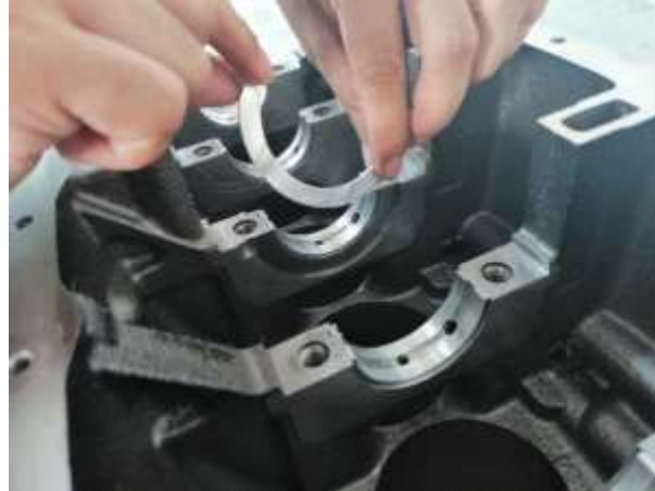
Figura 61 Colocación de cojinetes axiales. (Torres, 2019)
