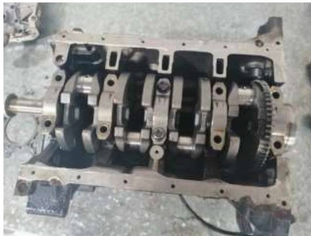
Figura 53 Desmontaje de bancadas de cigüeñal (Torres, 2019)
