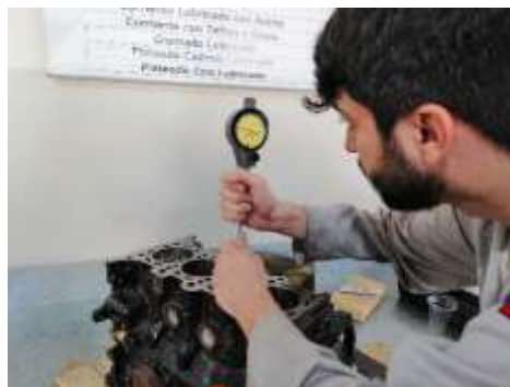
Figura 97 Evaluación de cilindros (Torres, 2019)
