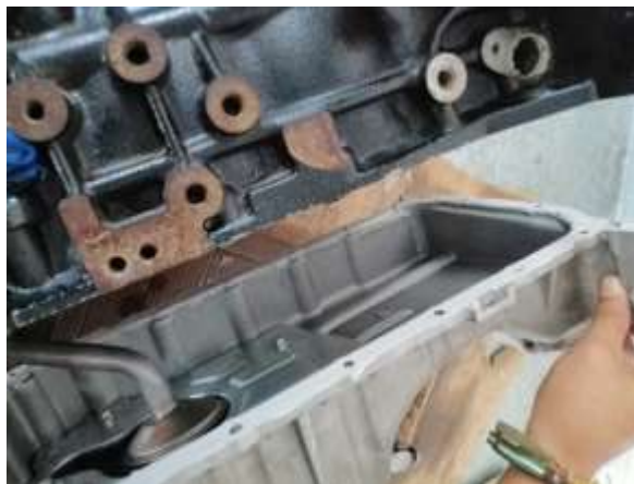
Figura 73 Instalación de cárter (Torres, 2019)
