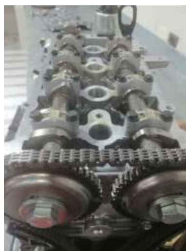
Figura 86 Evaluación de túnel para árbol de levas (G.M., 2012)
