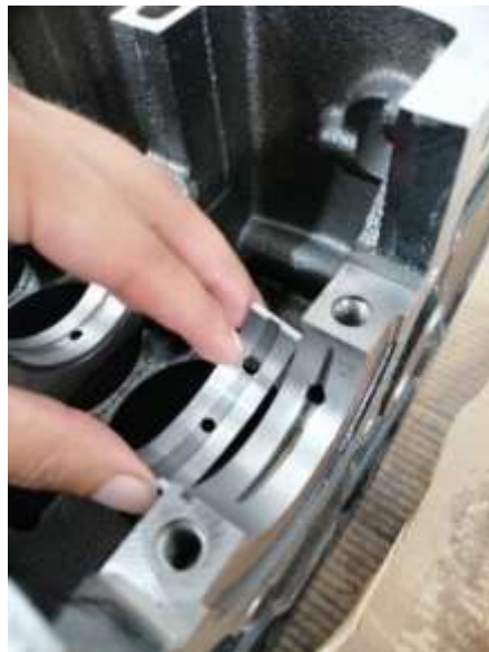
Figura 60 Montaje de cojinetes (Torres, 2019)
