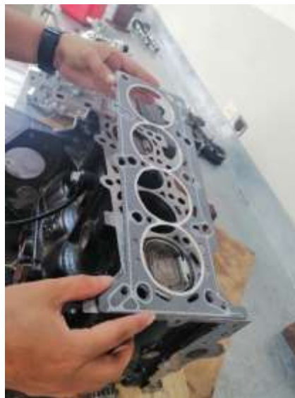
Figura 67 Instalación de junta (Torres, 2019)
