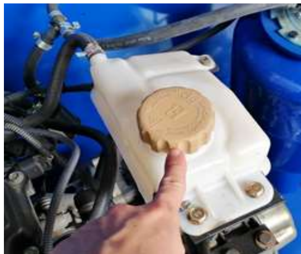
Figura 17 Tapa de tanque de reserva (Torres, 2019)
