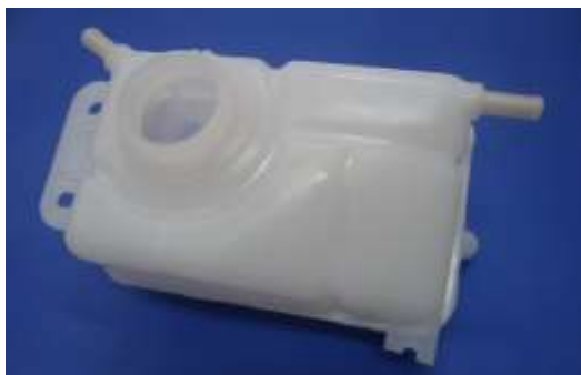
Figura 16 Tanque de reserva (Torres, 2019)
