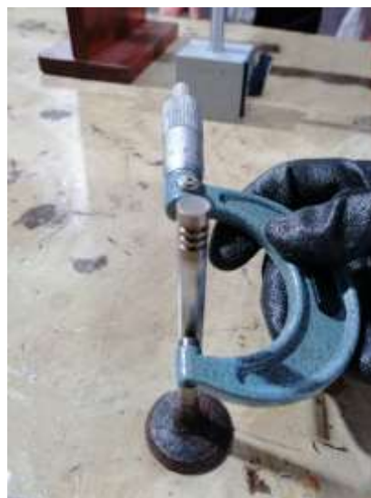
Figura 95 Evaluación de vástago de válvulas (G.M., 2012)
