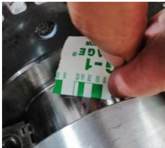
Figura 104 Comprobación de luz de aceite (G.M., 2012)
