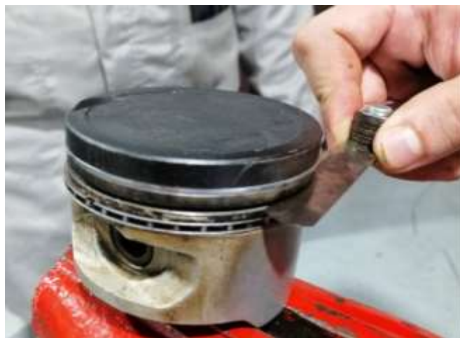
Figura 100 Verificación de ranuras para segmentos (G.M., 2012)
