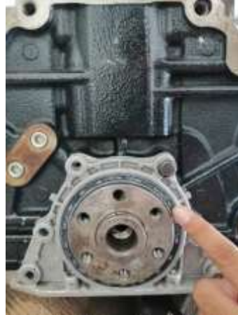
Figura 65 Colocación de retenedor posterior (Torres, 2019)
