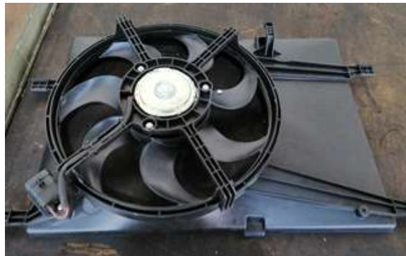
Figura 20 Ventilador de sistema de refrigeración (Torres, 2019)
