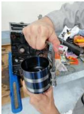
Figura 66 Instalación de pistones (Torres, 2019)
