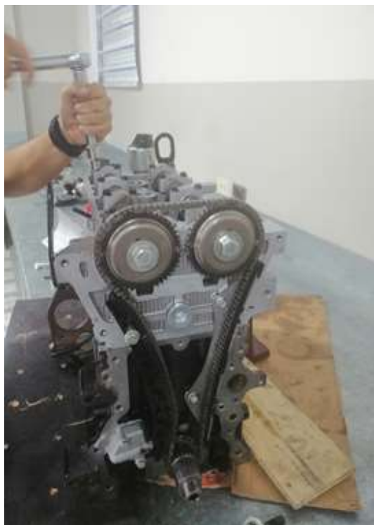
Figura 14 Mecanismo de distribución (Torres, 2019)
