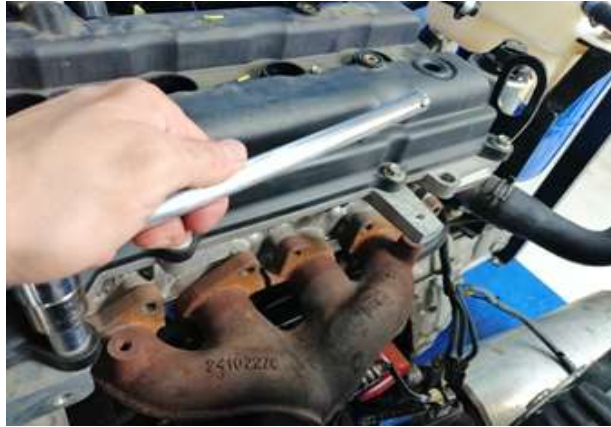
Figura 41 Desmontaje tapaválvulas (Torres, 2019)
