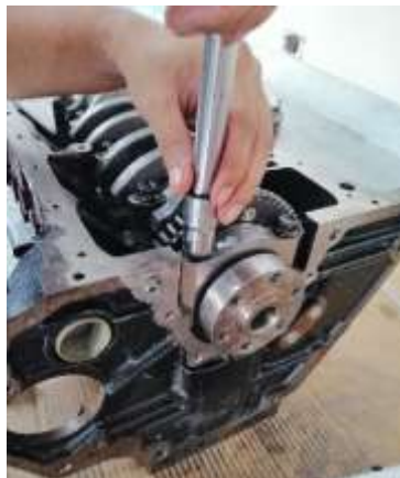
Figura 57 Extracción de bancadas de cigüeñal (Torres, 2019)
