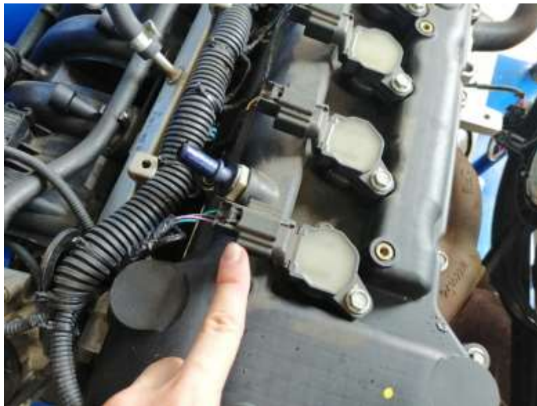
Figura 83 Instalación de bobinas (Torres, 2019)
