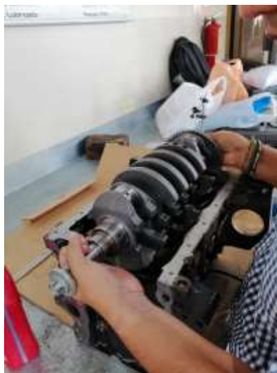
Figura 62 Contaje de cigüeñal (Torres, 2019)
