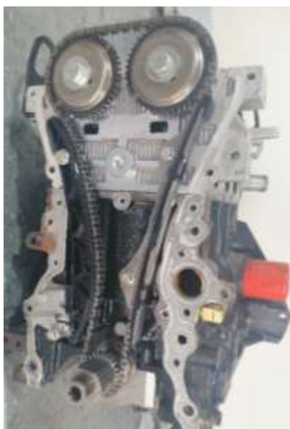
Figura 71 Colocación de templadores de cadena (Torres, 2019)
