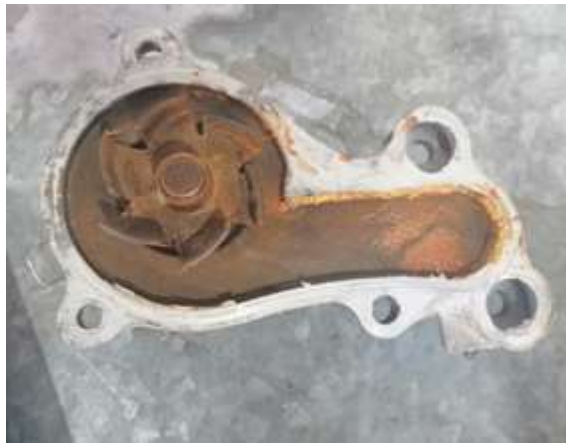
Figura 18 Bomba de refrigerante (Torres, 2019)
