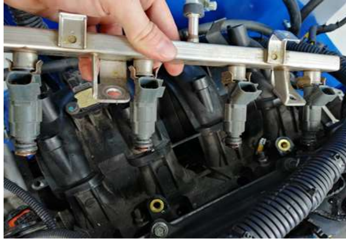
Figura 39 Desacople de riel de combustible (Torres, 2019)
