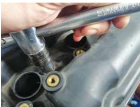
Figura 75 Apriete tapa válvulas (Torres, 2019)
