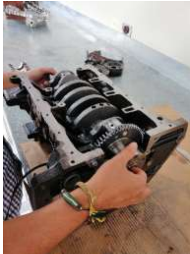
Figura 58 Extracción de cigüeñal (Torres, 2019)
