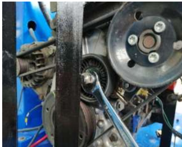
Figura 79 Colocación de banda de accesorios (Torres, 2019)
