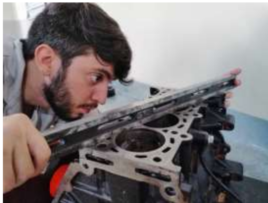
Figura 90 Verificación de planitud (Torres, 2019)
