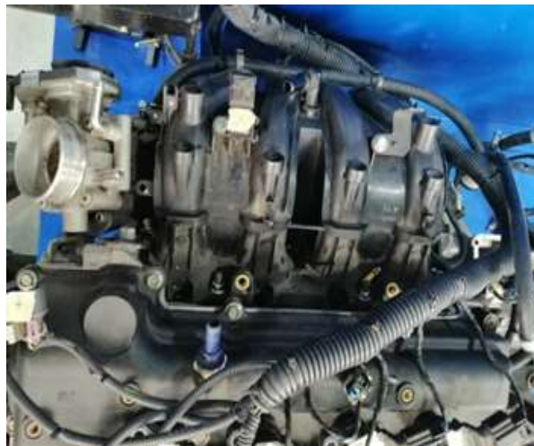
Figura 40 Desacople múltiple de admisión (Torres, 2019)
