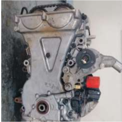
Figura 72 Instalación tapa delantera de motor (Torres, 2019)
