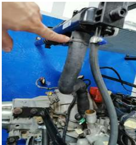
Figura 31 Manguera de refrigeración (Torres, 2019)
