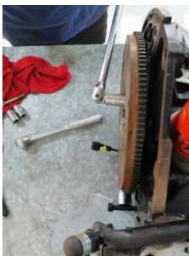
Figura 77 Instalación volante de inercia (Torres, 2019)
