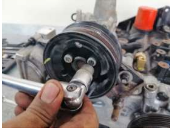
Figura 43 Desmontaje polea de bomba de agua (Torres, 2019)
