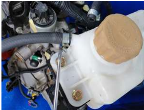
Figura 29 Manguera de tanque de compensación al motor (Torres, 2019)
