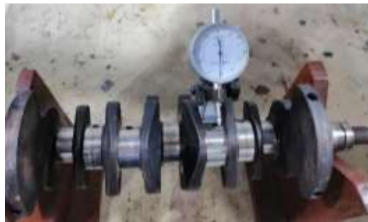
Figura 87 Verificación pandeo de cigüeñal (G.M., 2012)
