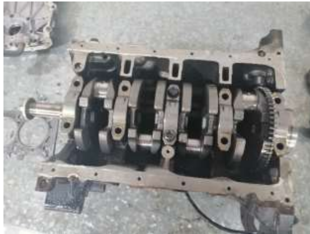
Figura 63 Instalación de bancada de cigüeñal (Torres, 2019)
