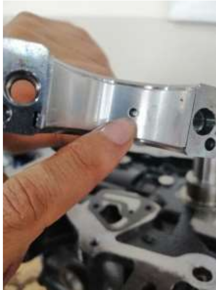
Figura 105 Instalación de cojinetes (G.M., 2012)
