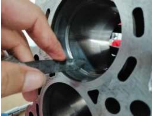
Figura 101 Verificación luz de segmentos (Torres, 2019)
