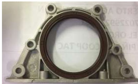
Figura 89 Inspección de retenedor posterior (G.M., 2012)
