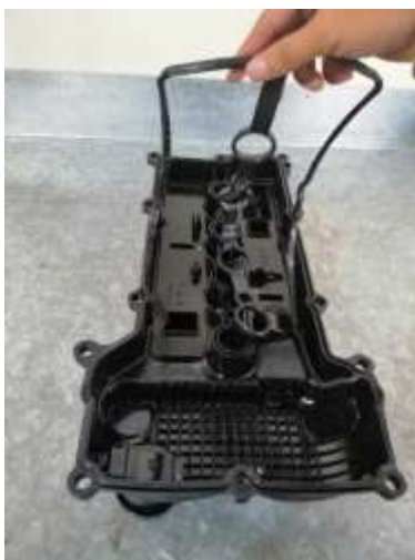
Figura 74 Instalación de tapa válvulas (Torres, 2019)
