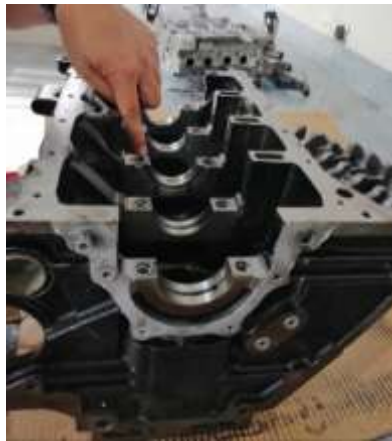
Figura 56 Extracción cojinetes axiales (Torres, 2019)
