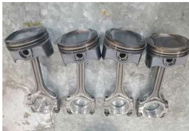
Figura 55 Extracción de pistones y bielas (Torres, 2019)
