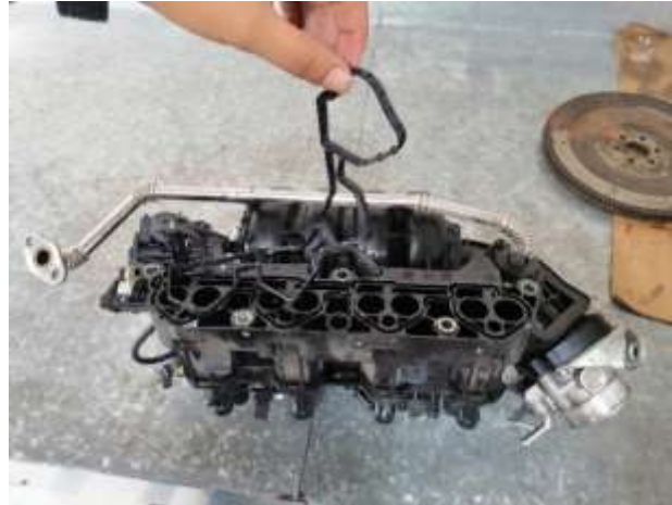
Figura 80 Instalación múltiple de admisión (Torres, 2019)
