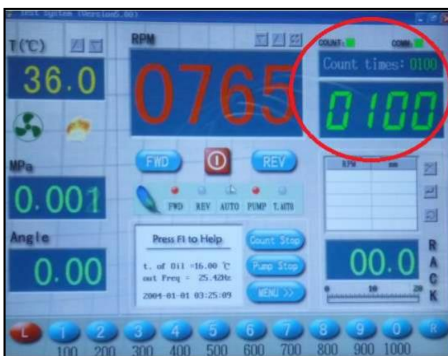
Figura 54. Tiempo de conteo de inyección en el panel de control de banco de pruebas (Lucin, 2019)
