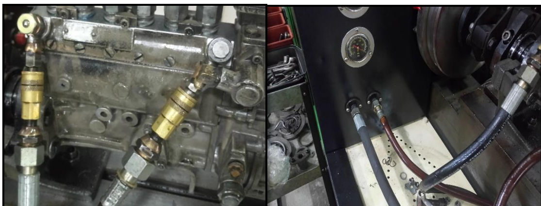
Figura 50. Colocación de mangueras de entrada y retorno de combustible (Lucín, 2019)
