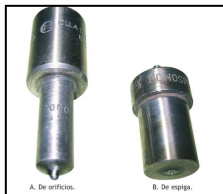
Figura 16. Inyector de orificios(A) e inyector de espiga (B) (Sanchez, 2009)
