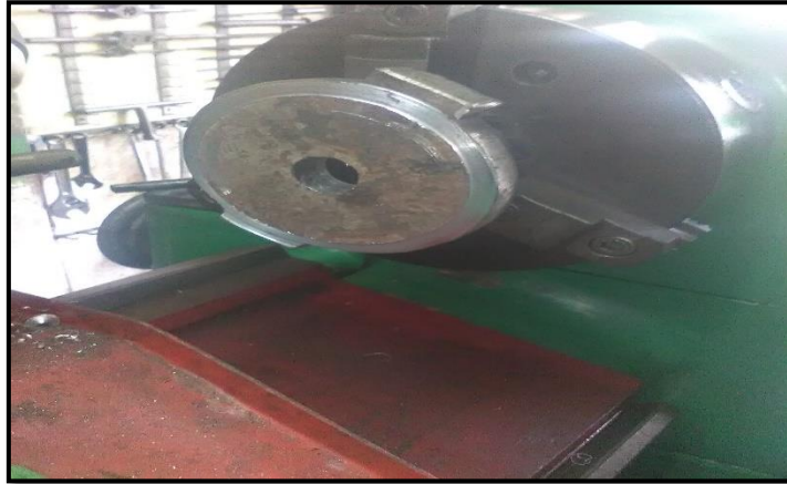
Figura 33. Elaboración de puntas laterales (Lucín, 2019)
