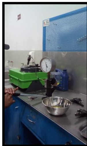
Figura 40. Comprobación de inyectores (Lucín, 2019)
