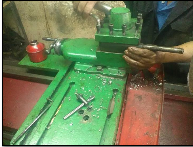
Figura 31. Colocación de buril (Lucín, 2019)
