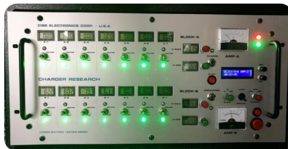
Figura 5. Panel de control del Banco de Pruebas para baterías híbridas (TAAET Electronics , 2017)
