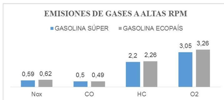
Figura 13. Emisiones de gases a altas rpm.
