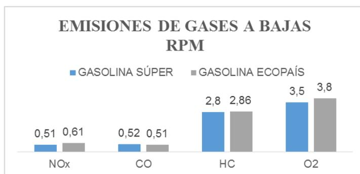
*Figura 12.* Emisiones de gases a bajas rpm.
