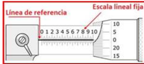
Figura 7. Escala lineal fija de un micrómetro en el Sistema Inglés. Fuente: Stefanelli Eduardo.
