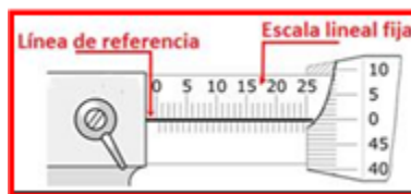
Figura 5. Escala lineal fija de un micrómetro en el Sistema métrico. Fuente: Stefanelli Eduardo.
