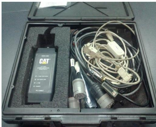
Figura 3: Kit OEM para diagnóstico de sistemas de inyección electrónica CAT.
