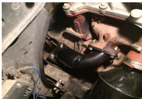
Figura 5. Adaptaciones de admisión y escape adecuadamente montadas
