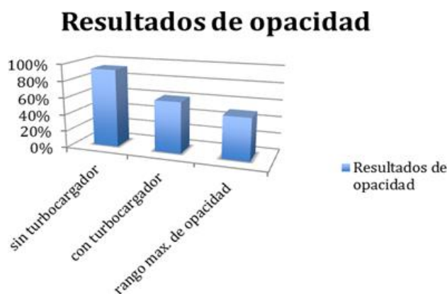
Figura 11. Comparación de los resultados de medición de la opacidad
