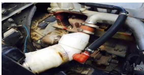
Figura 3. Adaptación en el múltiple de admisión.
