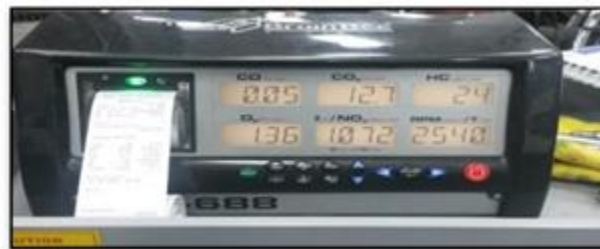
Figura 4. Analizador de gas BRAIN BEE AGS-688 Fuente: Marco Noroña
