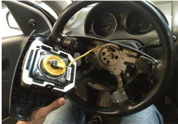
**Figura 3:** Localización del airbag del piloto en el vehículo Chevrolet Aveo 2008.
