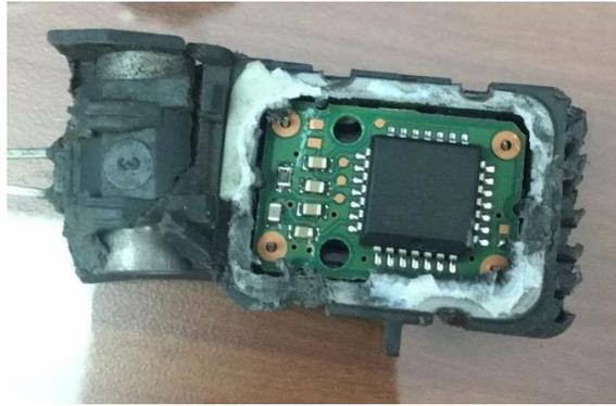
**Figura 8:** Sensor de impacto delantero sistema Air Bag.
