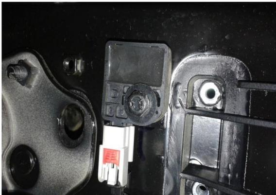
**Figura 5:** El sensor de deceleración del sistema.
