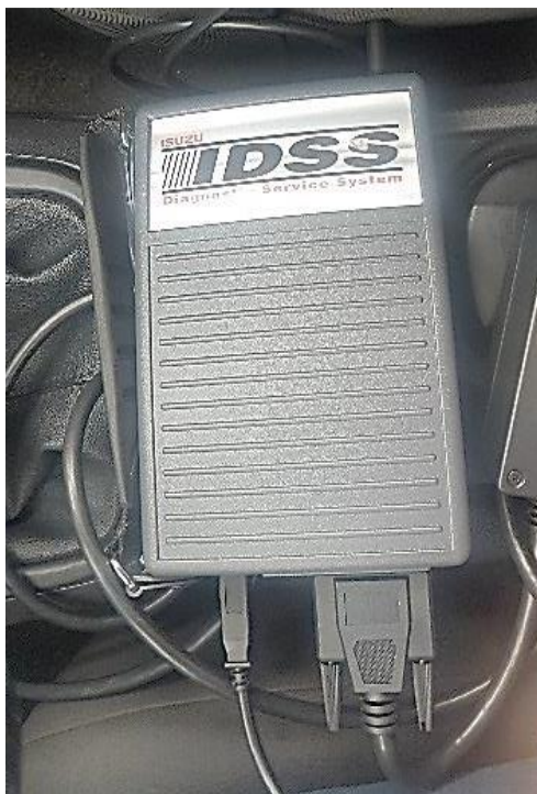
Imagen 11 IDSS (Isuzu Diagnostic Service System)
