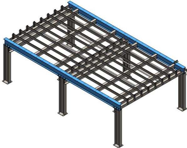
Figura 3. 3 – Vigas longitudinales
