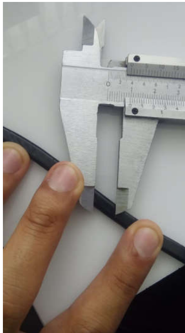
Figura 4.199. Medición de Traslape
