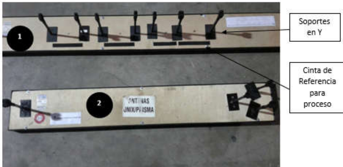
Figura 1.2. Soportes de antena para encintado (JIGS)
