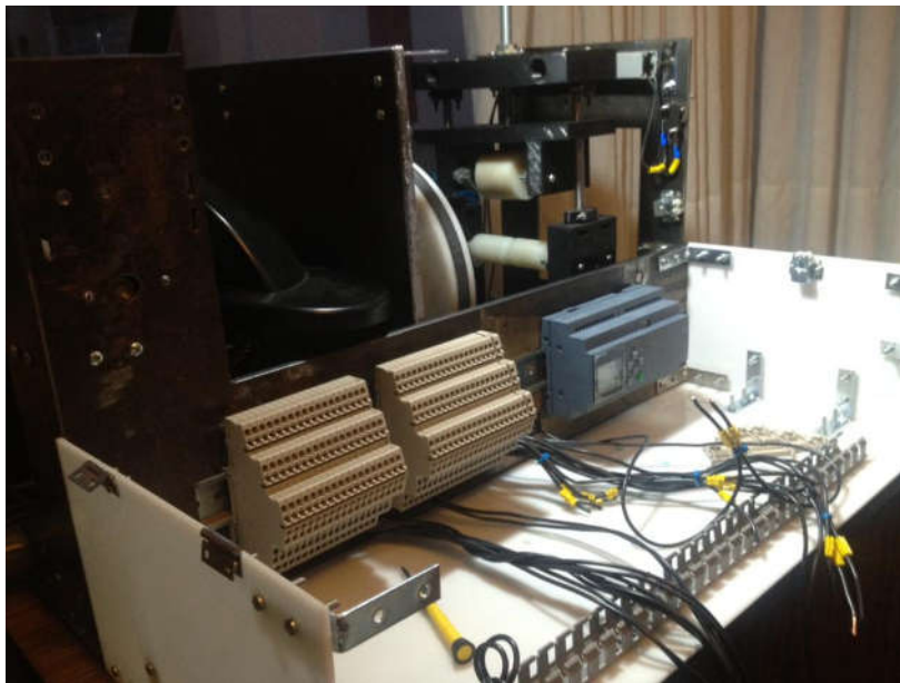
Figura 3.188. Montaje de elementos de control sobre riel DIN
