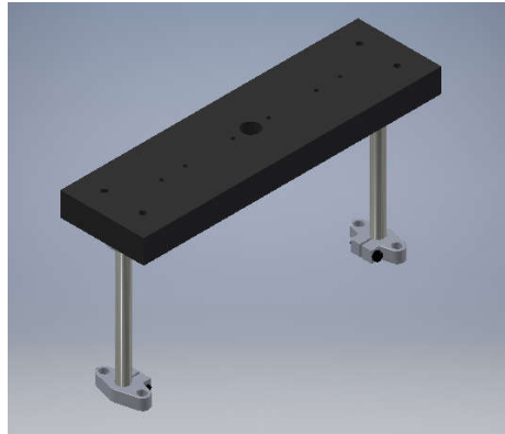
Figura 3.108. Estructura para cajetín de desplazamiento vertical en rodillo presor para mecanismo de alimentación
