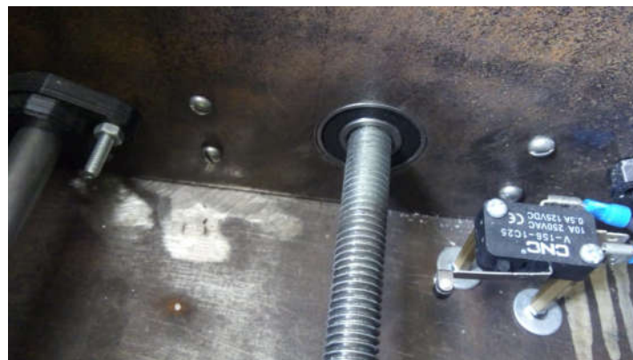
Figura 3.179. Rodamiento de media insertado en plancha central
