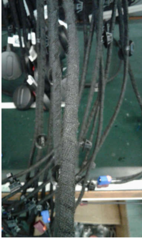
Figura 1.3. Visualización de antena recubierta con cinta
