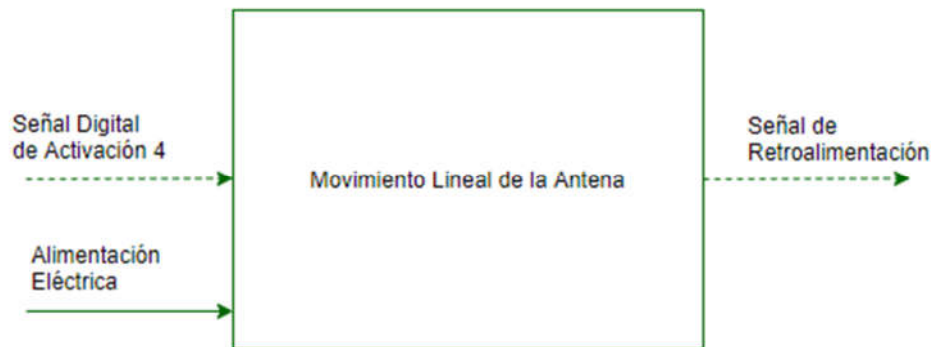
Figura 2.36. Módulo 3: movimiento lineal de la antena
