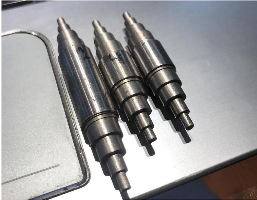
**Figura 4.24.** Probetas del primer ensayo realizadas en un acero plata.
