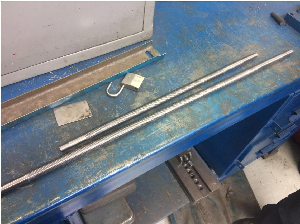
*Figura 4.7. Tornillos de potencia de paso 2 mm fabricados.*
