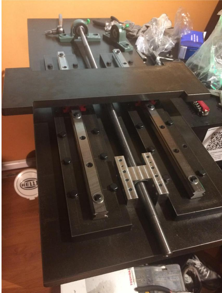
*Figura 4.3. Montaje de las guías lineales y alineación de las chumaceras.*
