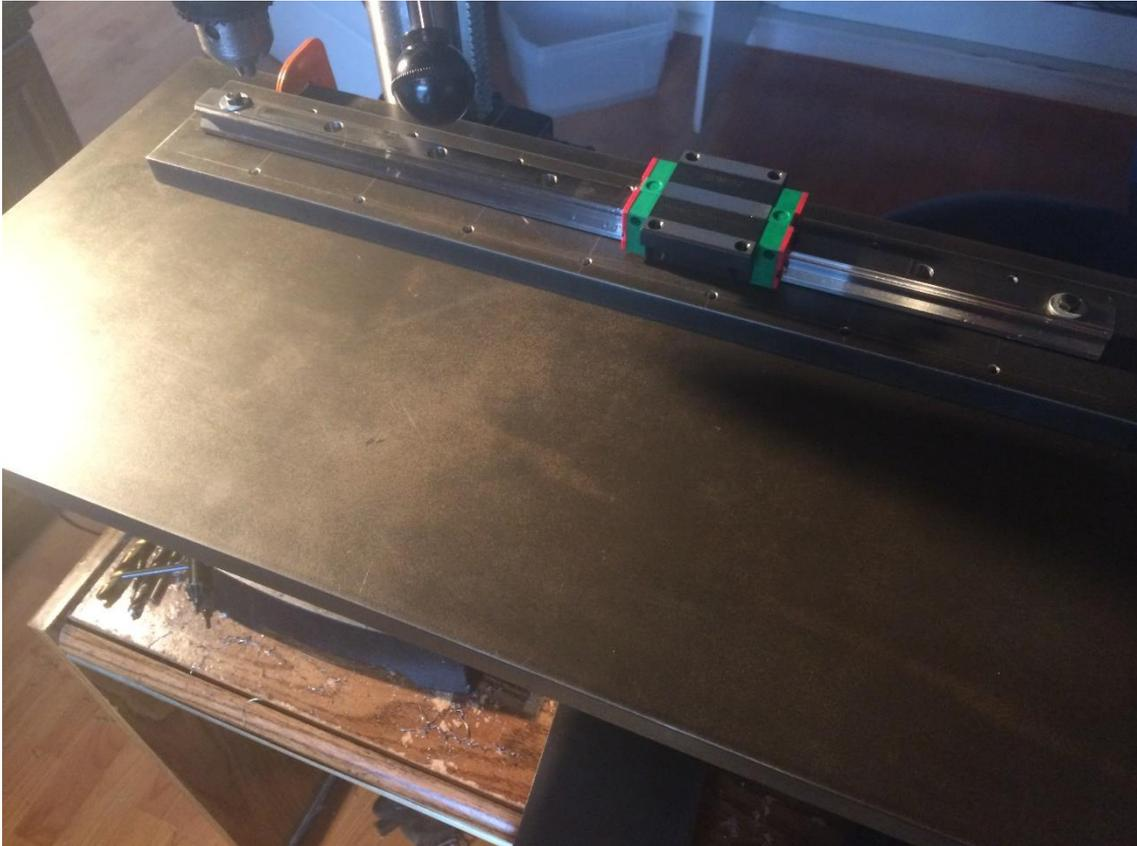
**Figura 4.2.** Perforación de la bancada para la colocación de las guías lineales.
