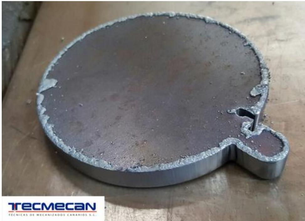
**Figura 2.16.** Acabado posterior al corte por plasma. Nótese el acabado triangular en los contornos.
