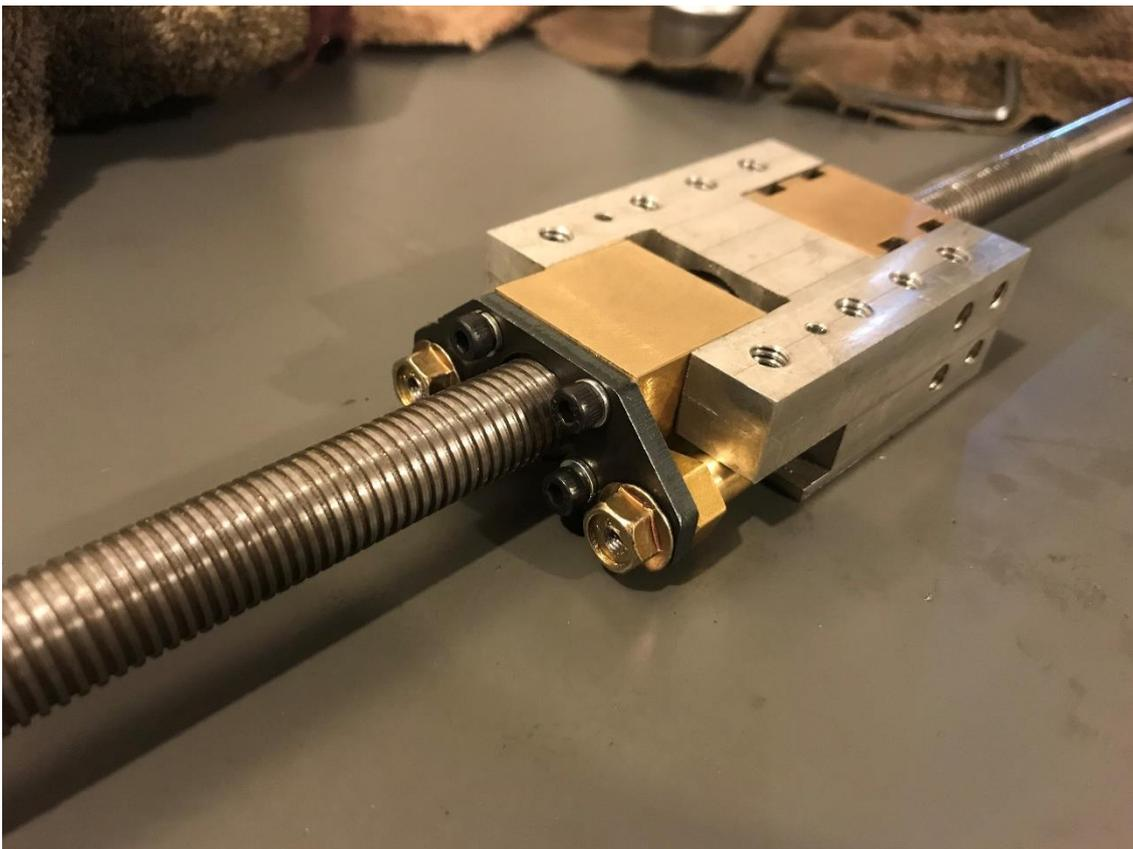
*Figura 4.12. Mecanismo anti juego para los tornillos de potencia.*
