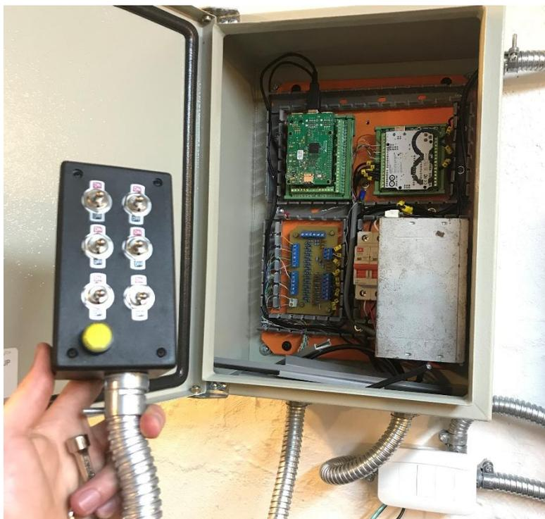
**Figura 4.16.** Conexión y cableado del tablero de control del HMI.
