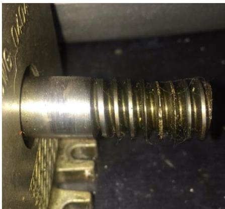
*Figura 1.2. Sinfin del motor destruido debido al desgaste de los bujes de bronce del motor debido a corrosión.*
