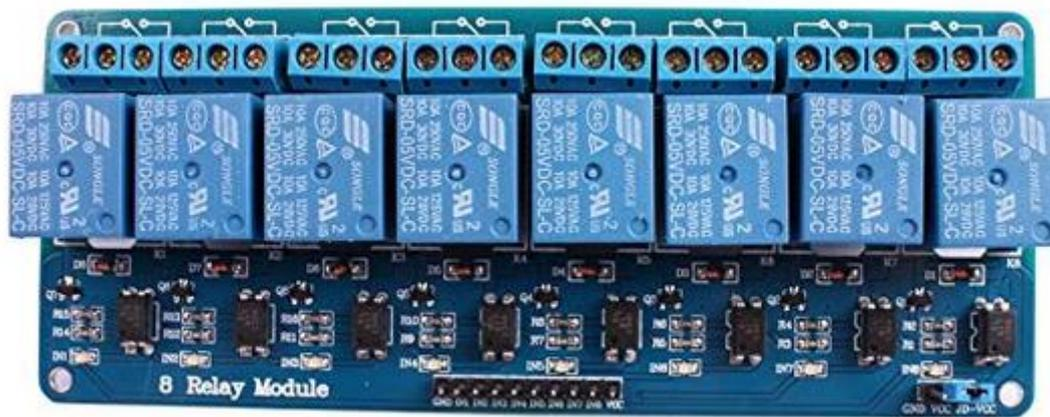
*Figura 2.39. Bloque de relés de 1 contacto, activación con 5VDC.*
