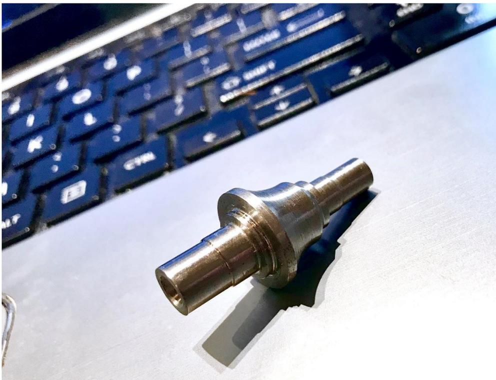
*Figura 4.25. Pieza de prueba referencial mecanizada con el modo CNC en un acero bonificado AISI 4340 y un inserto de carburo de tungsteno.*
