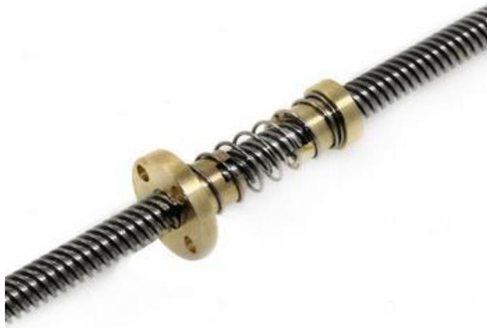
*Figura 2.27. Uso de un resorte para eliminar el juego en un tornillo de potencia.*
