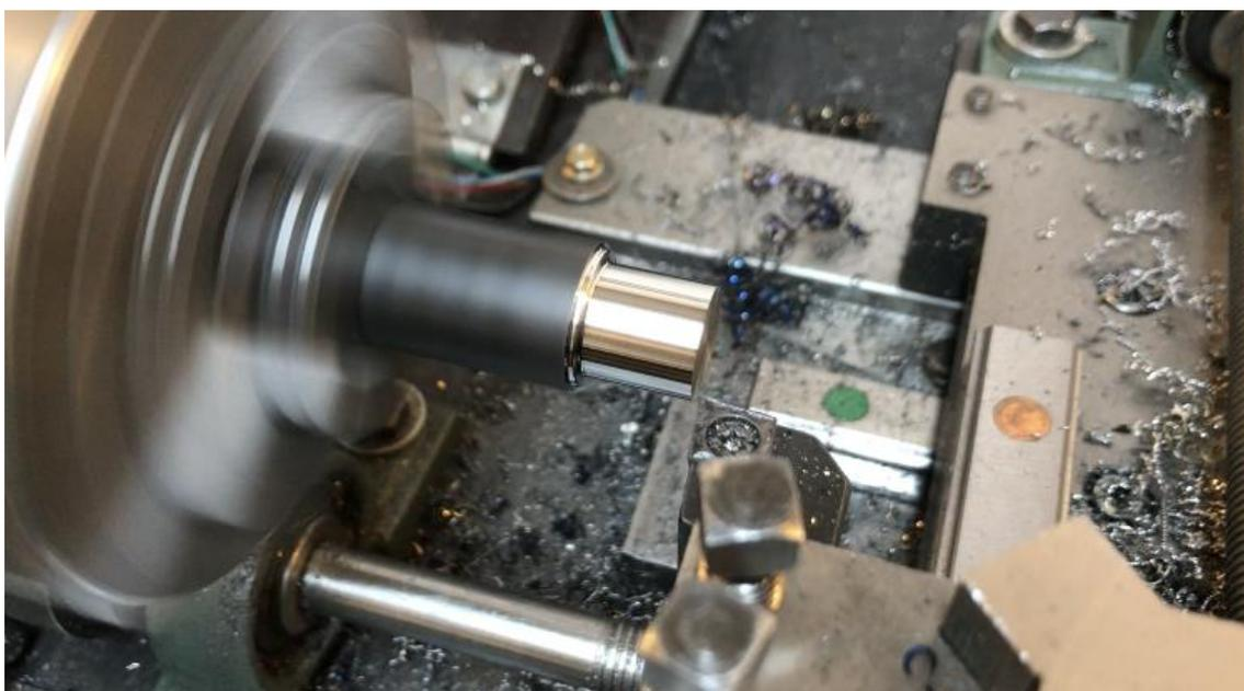
*Figura 4.23. Acabado superficial del segundo ensayo realizado sobre un acero bonificado AISI 4340.*
