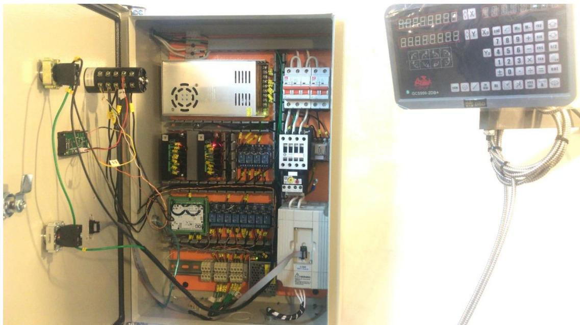
**Figura 4.15.** Conexión y cableado del tablero de control del torno CNC.
