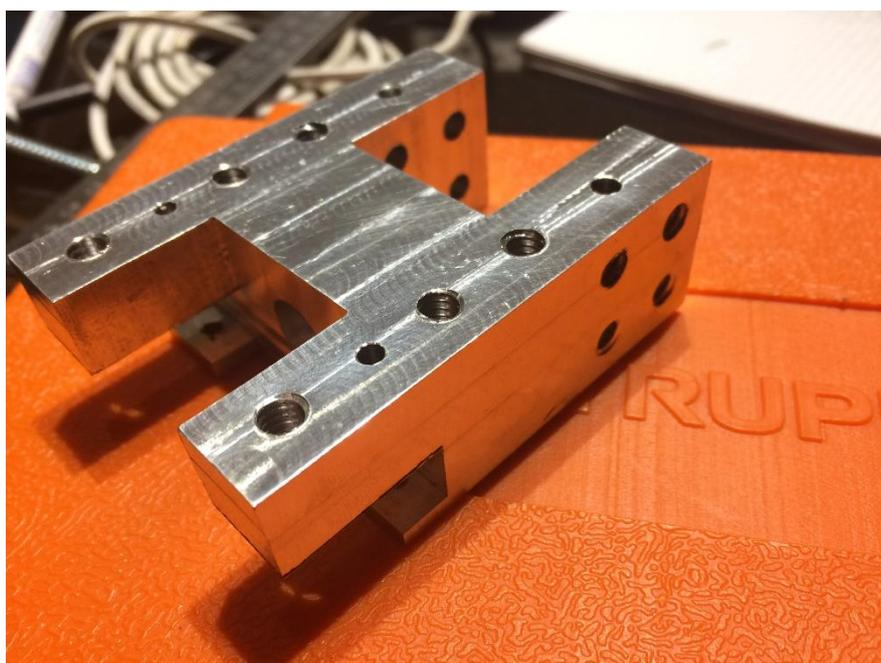
*Figura 4.9. Estructura en la que van acopladas las tuercas de los tornillos de potencia.*
