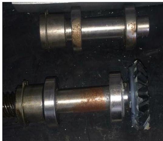
**Figura 1.1.** Ejes de motores de puertas automáticas afectados por corrosión.
