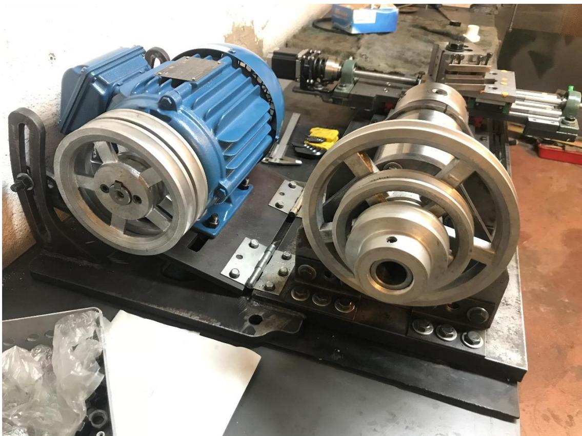
*Figura 4.14. Colocación del motor principal del husillo y alineación del mismo con el conjunto.*
