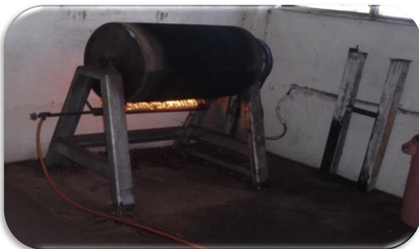
Figura 26. Tostado de los granos de cacao. Adaptado de la visita a la fábrica de Chocolates El Salinerito®.
