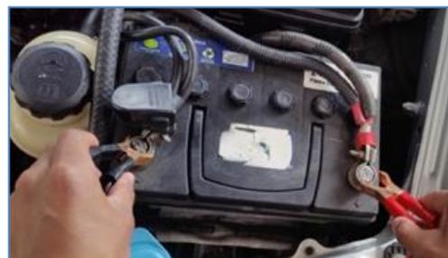
**Figura 18.** Conexión del módulo de rpm la batería
