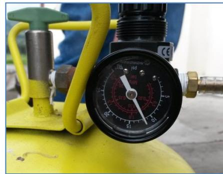
**Figura 4.** Ajuste del gas a 12 psi
