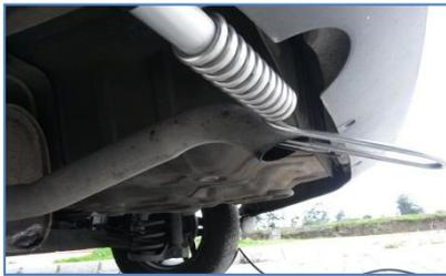
Figura 26. Sonda introducida en el escape
