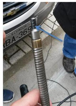
**Figura 13.** Punta de la sonda tapada.
