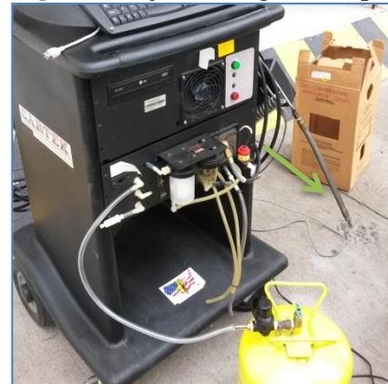
**Figura 5.** Conexión a la toma de calibración.
