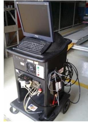
Figura 1. Analizador de gases CARTEK
