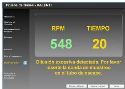
Figura 25. Mensaje para insertar la sonda.
