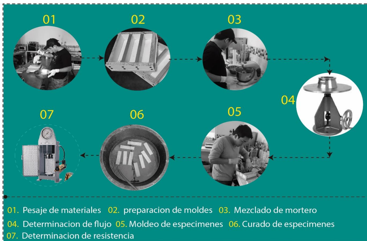
Ilustración. 55. Proceso para la elaboración de ensayos a flexión
