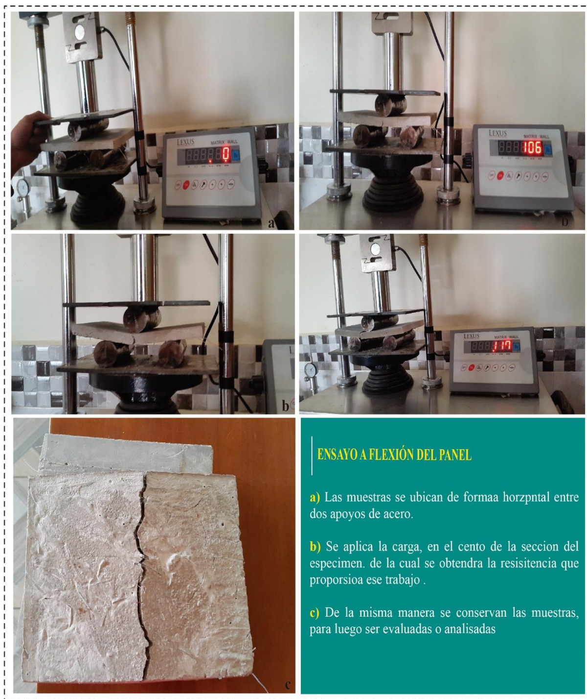
Ilustración. 78. pruebas de flexión de panel propuesto
