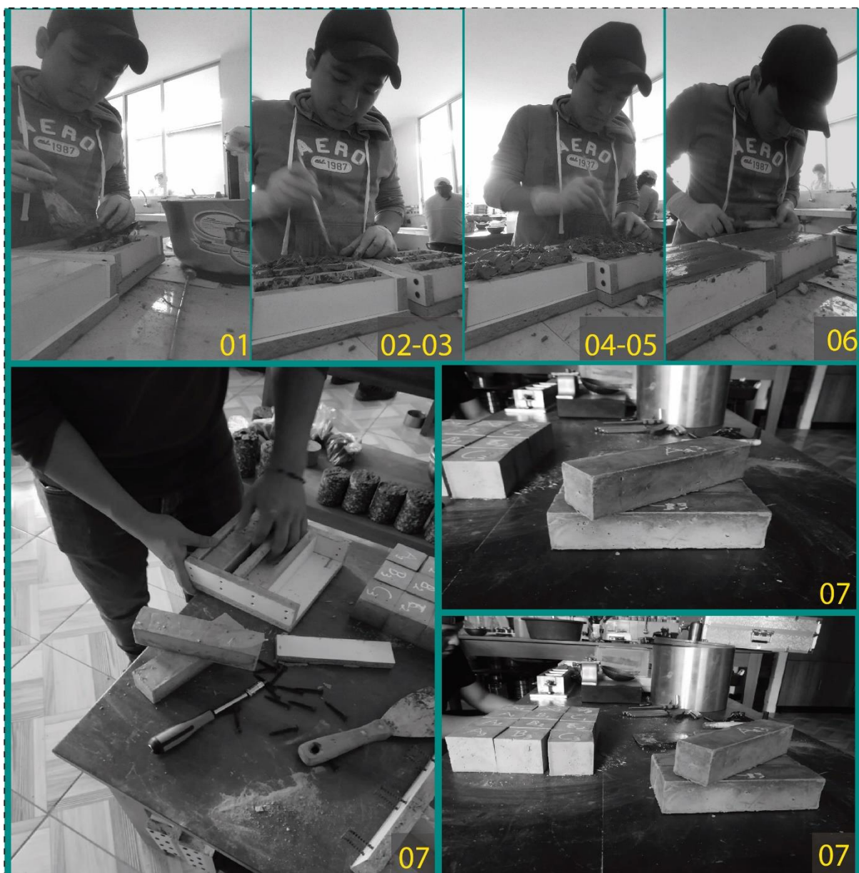
Ilustración. 59. Moldeo de especímenes según la norma NTE INEN 488
