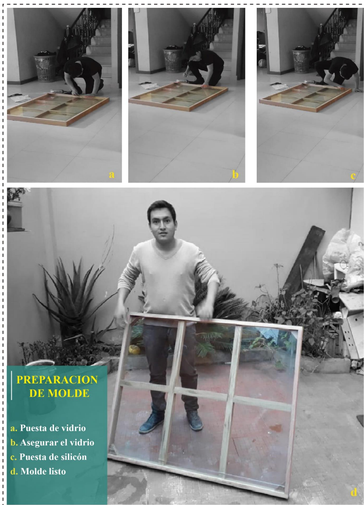
Ilustración. 66. Preparación del molde
