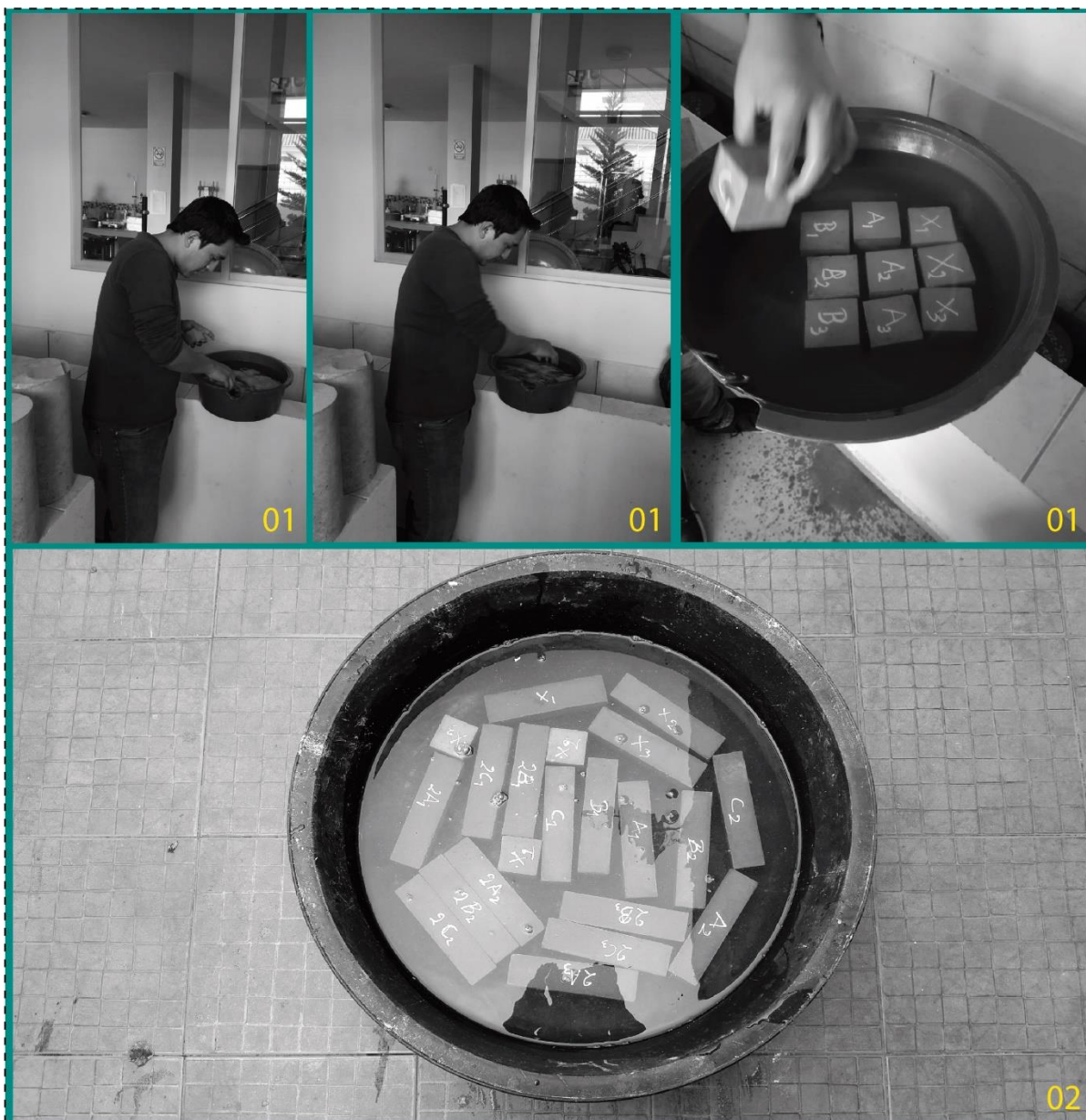
Ilustración. 53. Curado de especímenes de acuerdo a la norma NTE INEN 1 576
