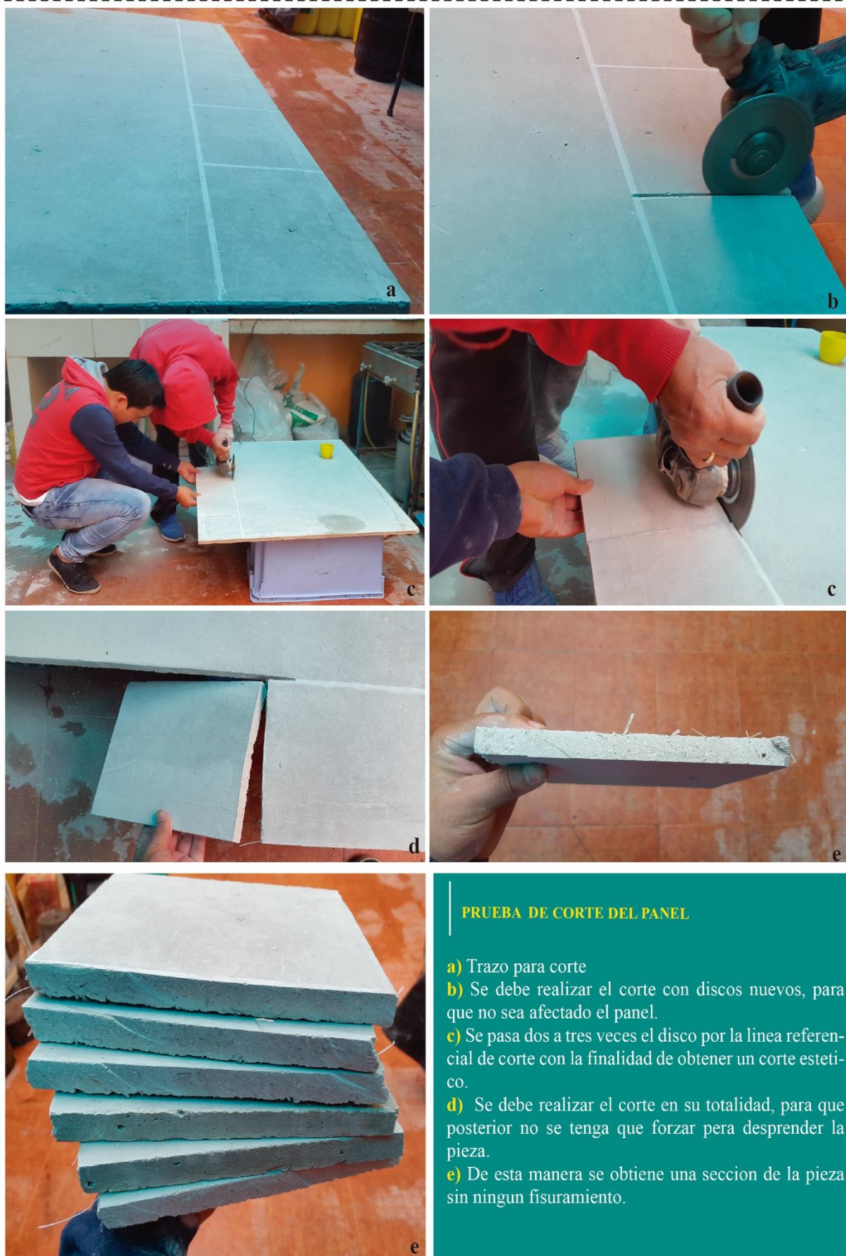
Ilustración. 74. Prueba de corte - NTE INEN 2100
