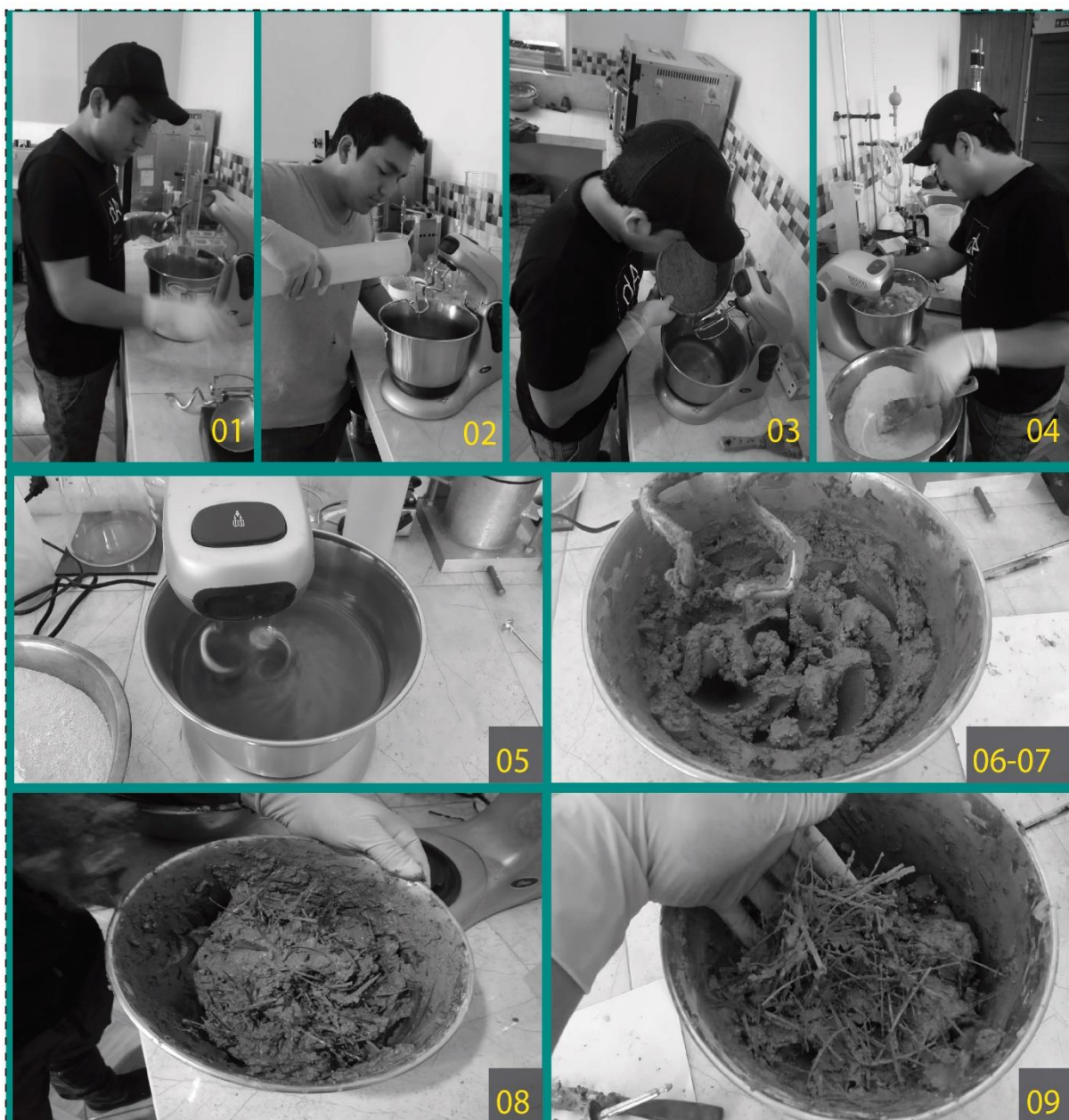
Ilustración. 58. Mezclado de la pasta de mortero según norma NTE INEN 155
