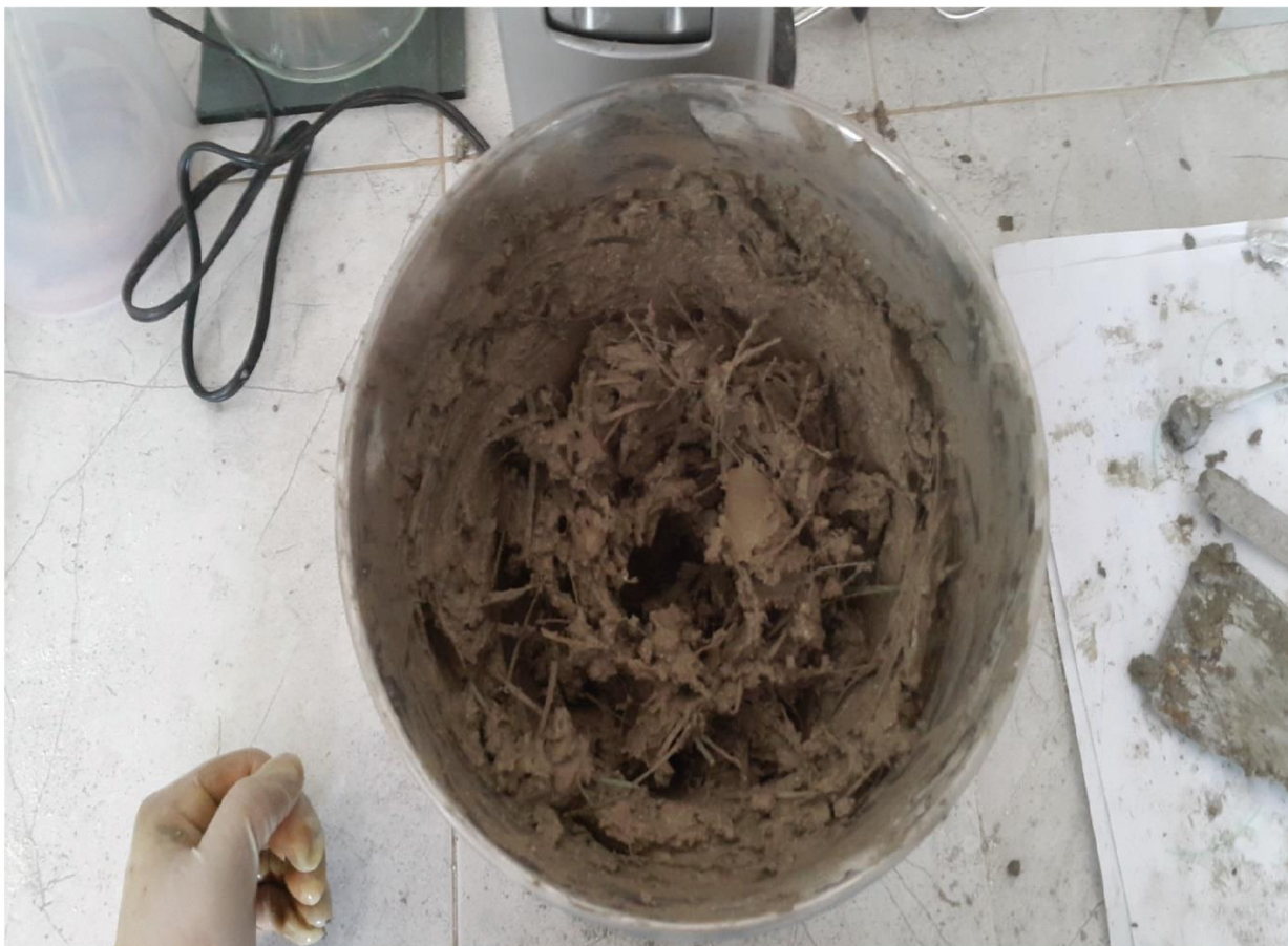
Ilustración. 46. Mezcla con agregado del 2.21 % de fibra de plástico PET en el micro-hormigón
