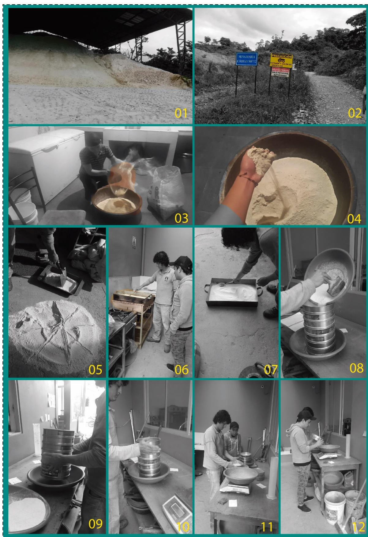
Ilustración. 37. Proceso de ensayo granulométrico - ASTM 136-1
