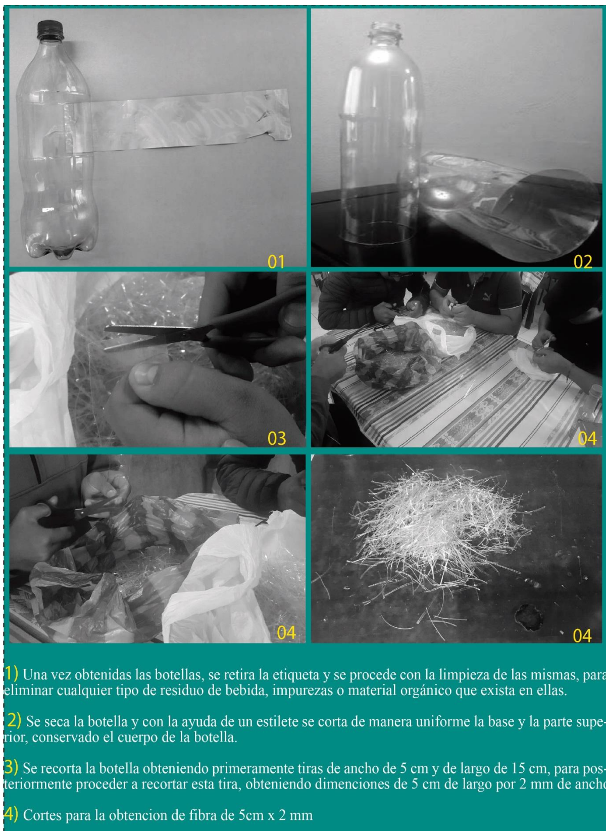
Ilustración. 41. Proceso de obtención de fibra PET
