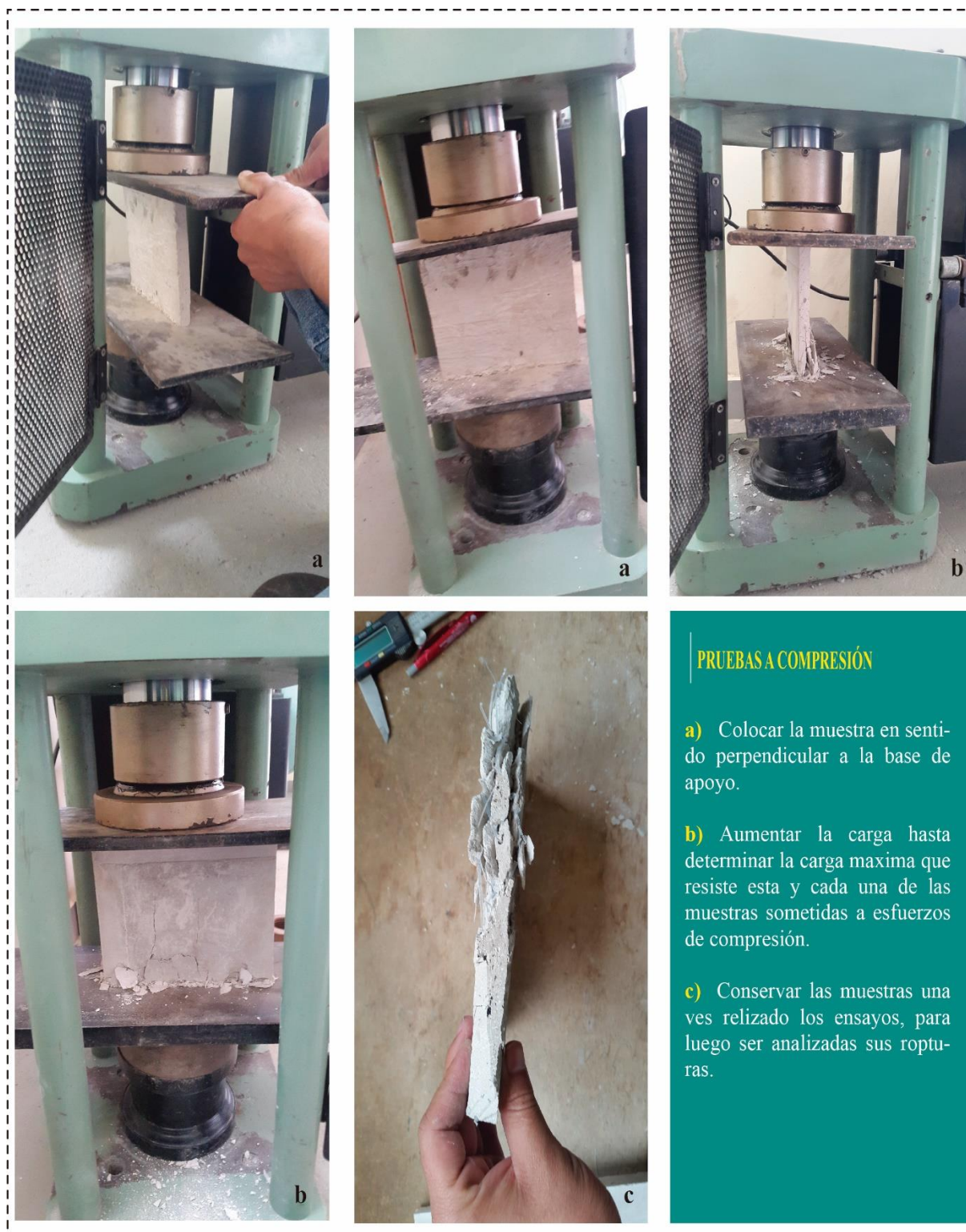
Ilustración. 77. Pruebas de compresión de panel Micro H-PET (propuesto)
