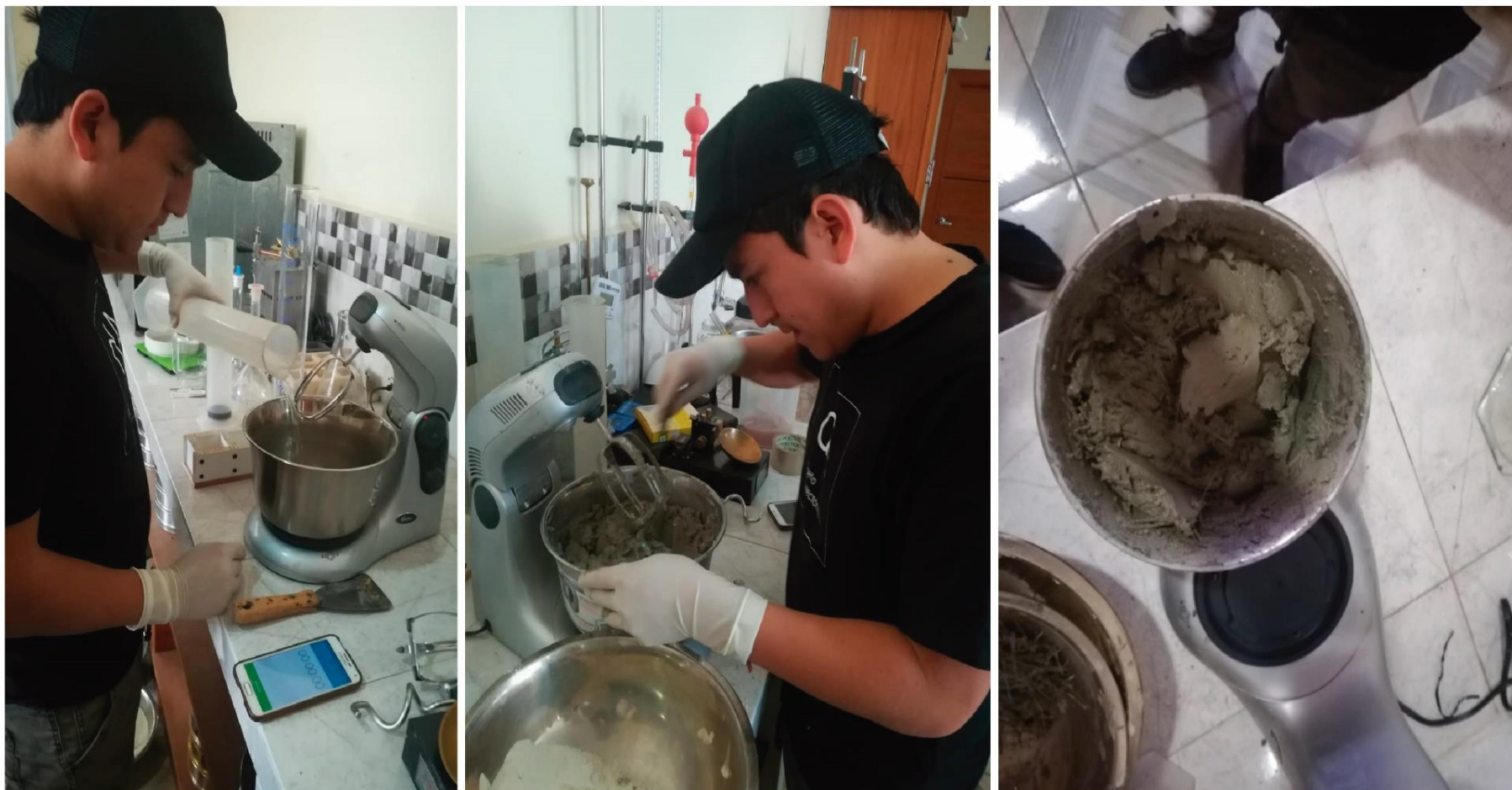
Ilustración. 43. Mezcla de micro-hormigón sin fibra PET y sin aditivo SIKA.
