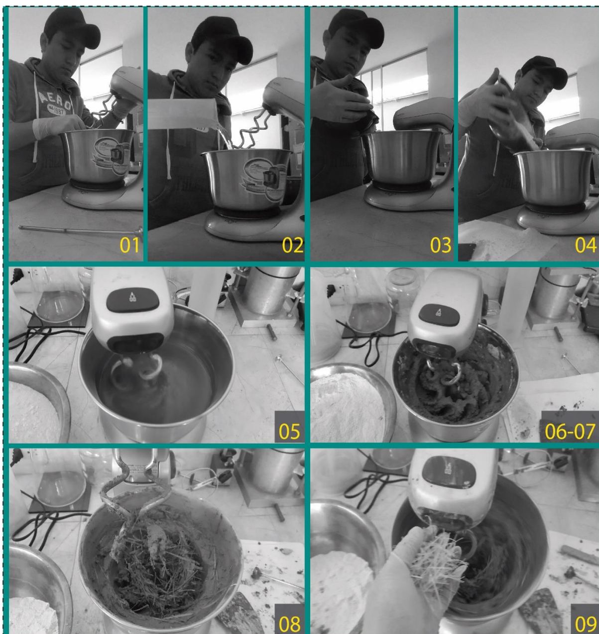
Ilustración. 50. Mezclado de la pasta de micro-hormigón
