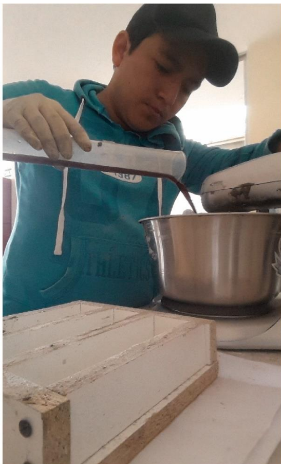
Ilustración. 46. Mezcla con agregado del 2.21 % de fibra de plástico PET en el micro-hormigón
