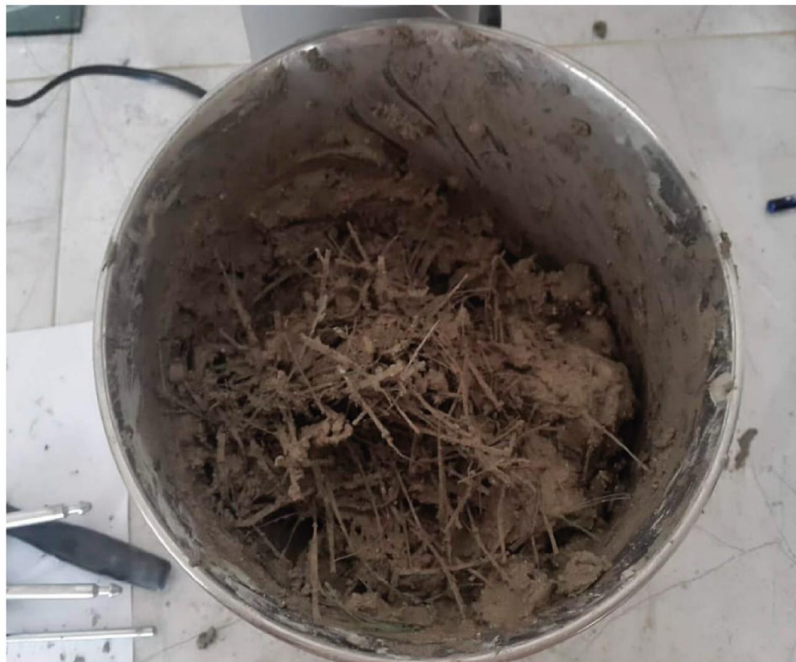
Ilustración. 45. Mezcla con agregado del 3% de fibra de plástico PET en el micro-hormigón
