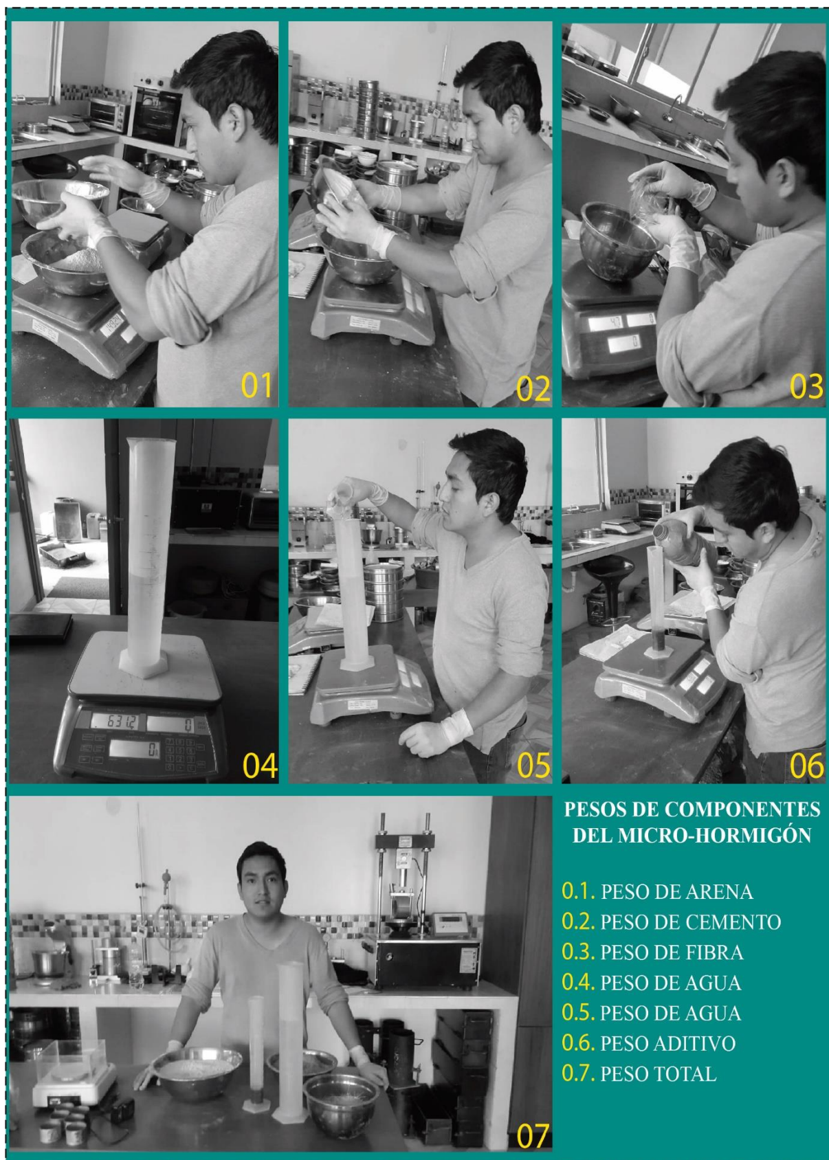
Ilustración. 48. pesaje de materiales, componentes de micro hormigón
