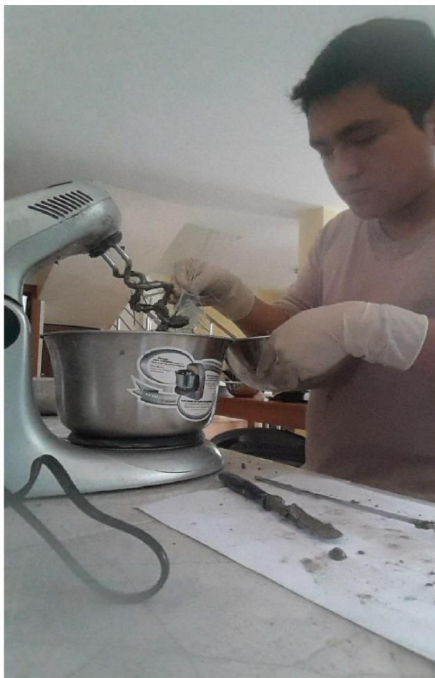
Ilustración. 45. Mezcla con agregado del 3% de fibra de plástico PET en el micro-hormigón
