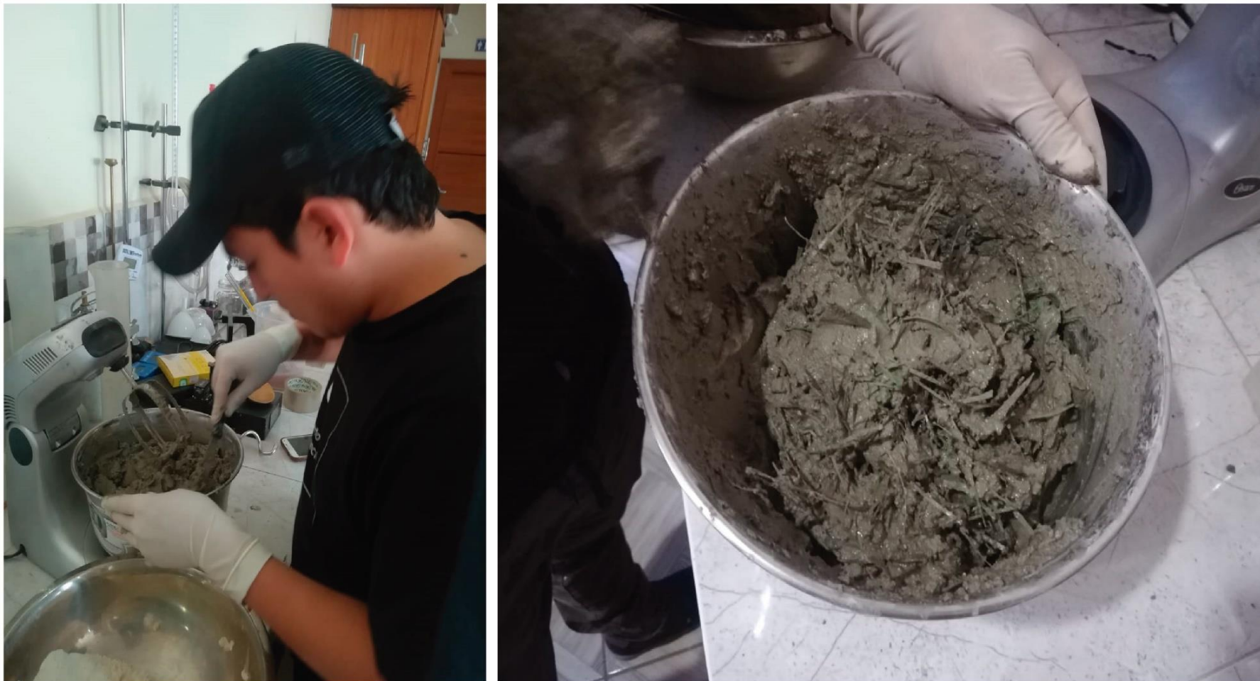
Ilustración. 44. Mezcla con agregado del 1 % de fibra de plástico PET en el miro-hormigón
