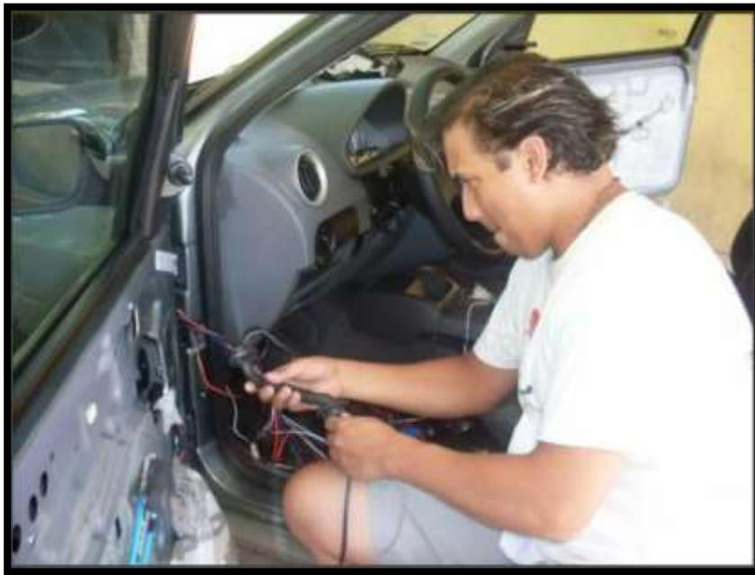
Fig.21: Instalación de alarma
