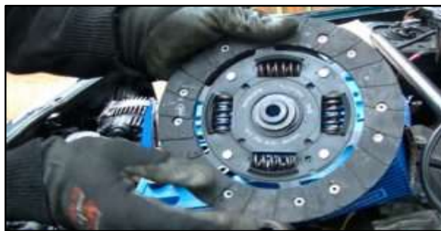
Figura 2. Cambio de embrague (Servicentro Quick pit)
