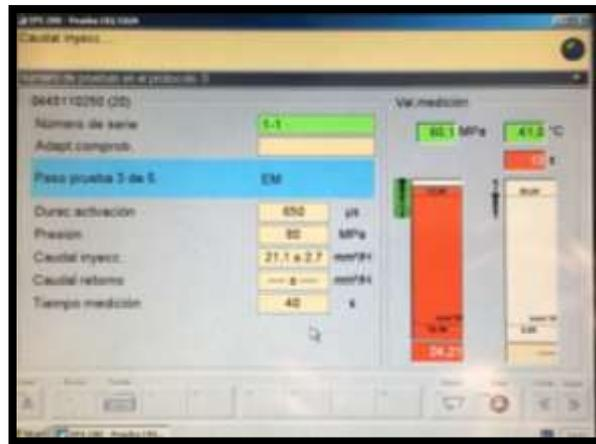
**Figura 4.9.** Caudal de inyección aportado por el inyector 0445120289 usado. (Bosch, 2018)
