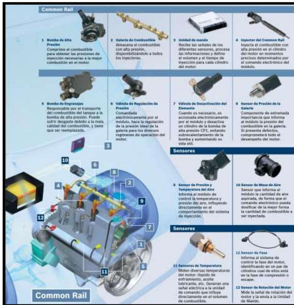
Figura 2.28. Principales componentes del sistema Bosch de riel común. (Bosch, 2016)
