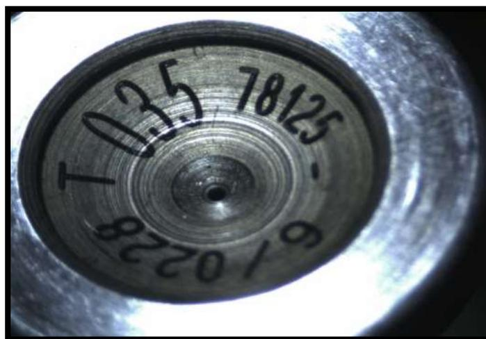
**Figura 4.27.** Desgaste en asiento de válvula de control.
