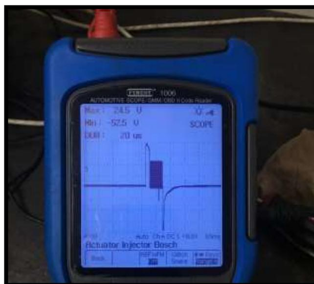
**Figura 4.8.** Gráfica del comportamiento de la inyección del inyector 0445120289, durante la prueba de emisiones contaminantes. (Noboa, 2018)
