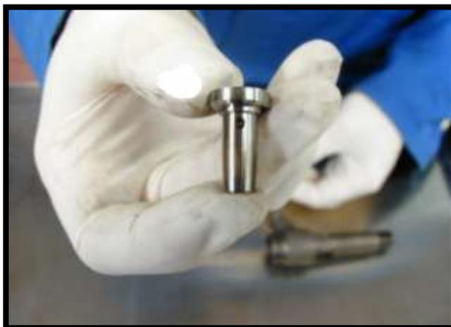
**Figura 4.26.** Válvula de control de un inyector Common Rail.
