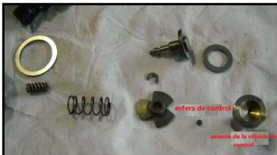
Figura 4.25. Componentes de un inyector Common Rail sometidos a mayor desgaste. (Cise Electronics Corp., 2018)
