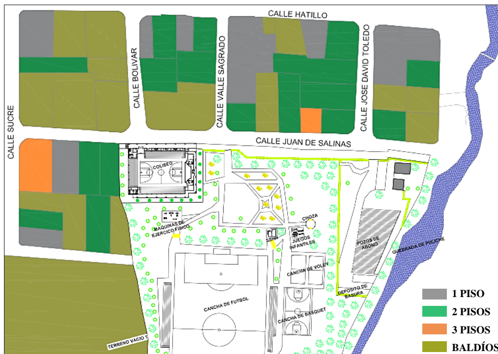
Ilustración 45. Altura de edificaciones colindantes al centro deportivo
