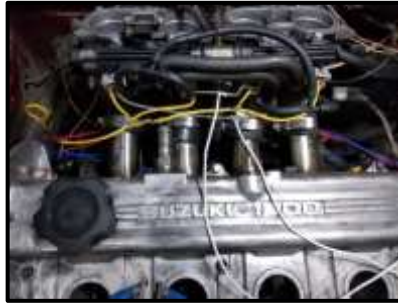
Figura 2.25. Conexión eléctrica de inyectores (Cavadía, 2018)
