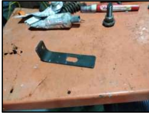
Figura 2.21. Base para el sensor de posición de cigüeñal (Cavadía, 2018)
