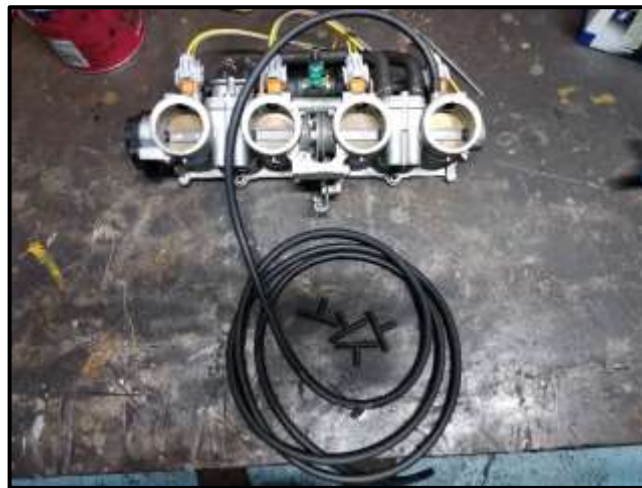
Figura 2.10. Cuerpo de aceleración con manguera de vacío (Cavadía, 2018)
