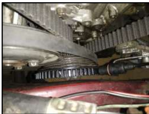
Figura 2.22. Ubicación del sensor de giro de cigüeñal. (Cavadía, 2018)
