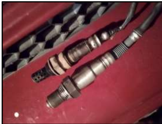
Figura 2.23. Sensores de oxígeno (Cavadía, 2018)
