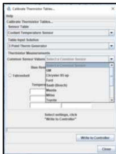
Figura 2.31. Calibración sensores IAT y ECT (Cavadía, 2018)
