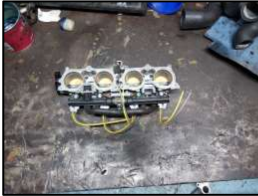
Figura 2.8. Cuerpo de aceleración independientes (Cavadía, 2018)
