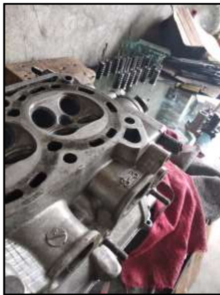
Figura 2.2. Desarmado y limpieza de cabezote (Cavadía, 2018)
