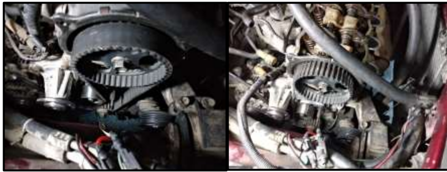
Figura 2.5. Sustitución banda de distribución (Cavadía, 2018)
