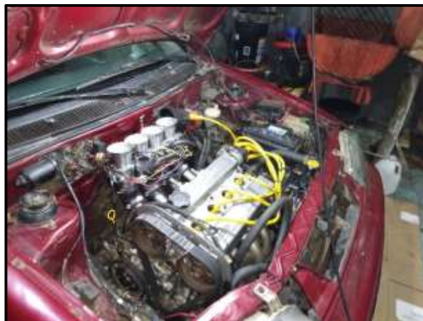
Figura 2.9. Cuerpo de aceleración independiente montado en el cabezote. (Cavadía, 2018)
