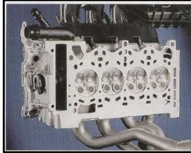
Figura 1.4 Culata del motor (Escudero, González, Ruivas, & Suárez, 2013)
