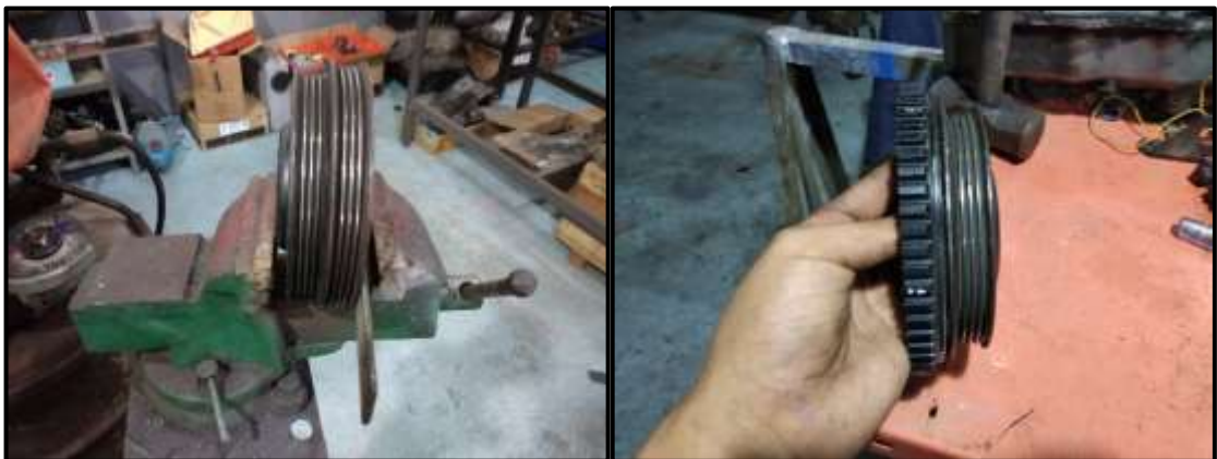
Figura 2.20. Adaptación de rueda fónica (Cavadía, 2018)
