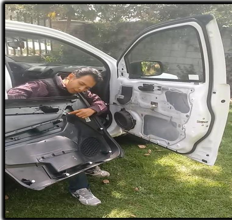
Gráfico 39 Desmontaje de puerta delantera
