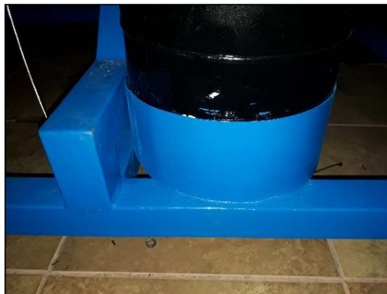
Figura 47. Tanque de combustible
