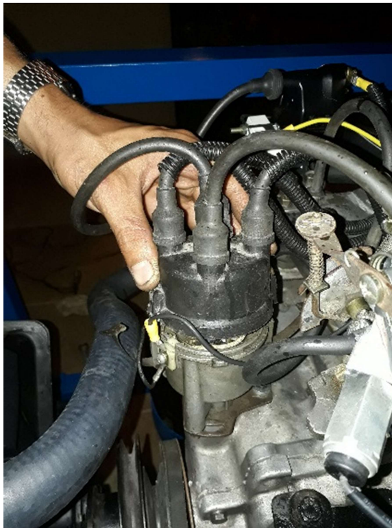
Figura 81. Tapa del distribuidor
