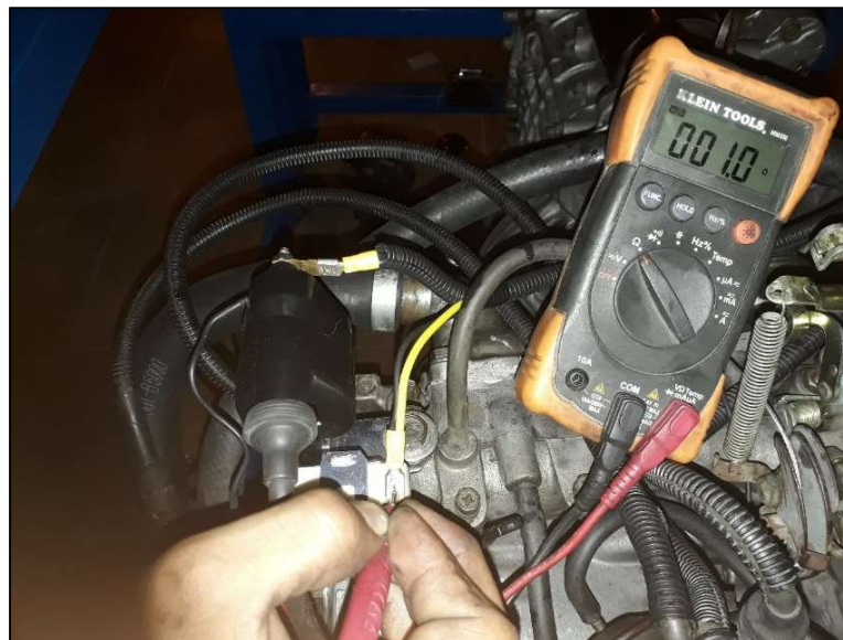
Figura 88. Medición de bobina de alta
