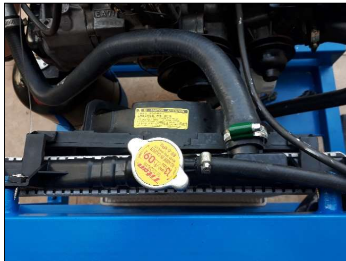
Para el sistema de refrigeración se utilizó el radiador convencional (Figura 49), se construyeron bases de soporte para el radiador las cuales van conectadas directamente a la estructura de la maqueta, de esta forma la instalación se realiza en un solo conjunto, el radiador cuenta con su propio electro ventilador.
