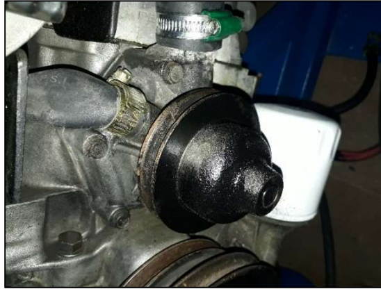
Figura 16. Bomba de agua
