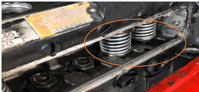
Figura 60 Identificación de los elevadores de los plunger. (Paguay 2018)
