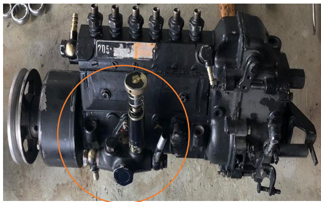
Figura 52 Identificación de la Bomba de Alimentación. (Paguay 2018)
