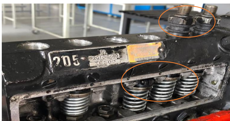
Figura 66 Instalación de los plunger en la bomba. (Paguay 2018)
