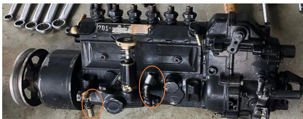
Figura 67. Identificación de entrada y retorno de combustible en la bomba de alimentación (Paguay 2018)
