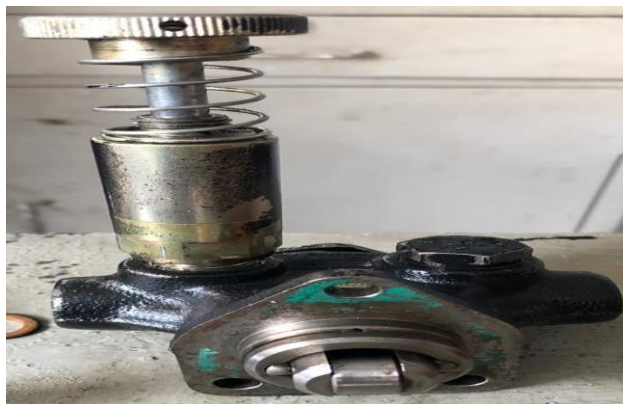
Figura 53 Extracción de la Bomba de Alimentación (Paguay 2018)
