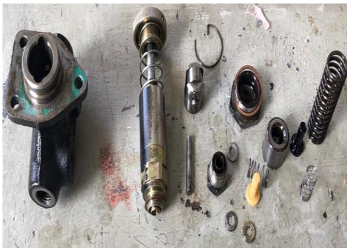
Figura 54 Despiece de la Bomba de Alimentación (Paguay 2018)
