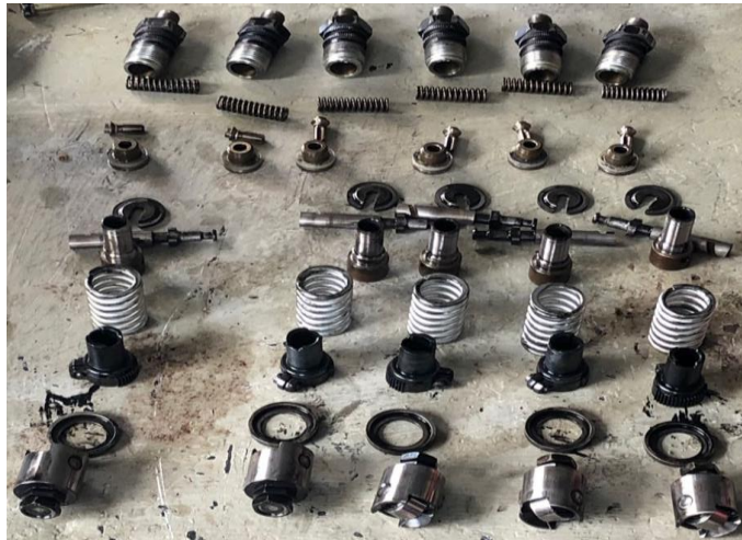
Figura 62 Despiece de los elevadores plunger (Paguay 2018)
