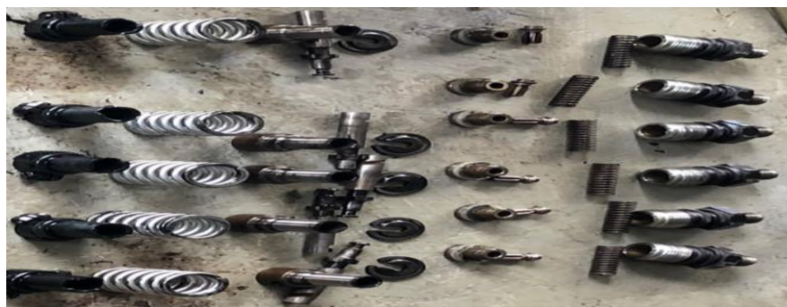
Figura 65 Juego de plunger de la bomba. (Paguay 2018)
