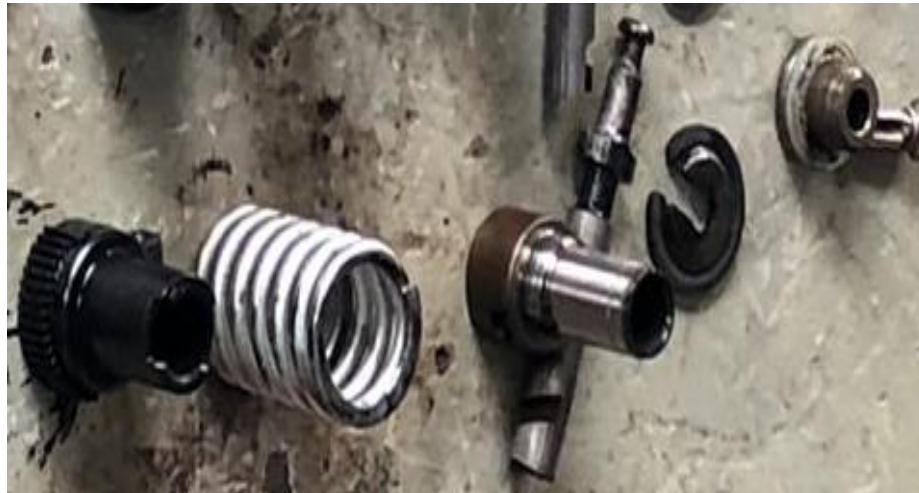
Figura 59 Despiece del plunger. (Paguay 2018)
