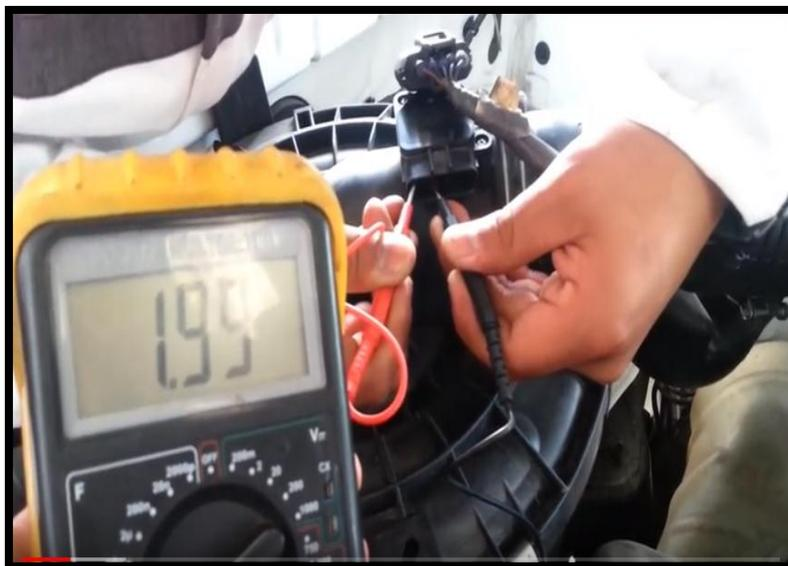
*Figura 33.* Comprobación de sensores y conexionado con el multímetro - Paso 2. (José R. Andrade)
