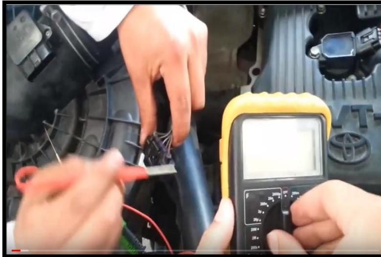
*Figura 32.* Comprobación de sensores y conexionado con el multímetro - Paso 1. (José R. Andrade)
