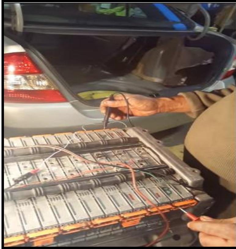
*Figura 30.* Colocacion de. Baterias y conexionado - Paso 2. (José R. Andrade)
