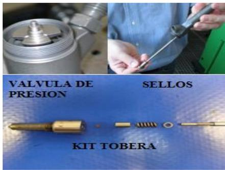
**Figura 15:** Pieza de cambio a los 100.000 Km
