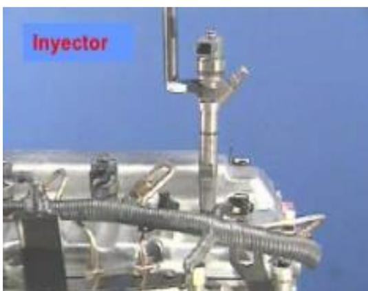
**Figura 4:** Ubicación inyector en la culata
