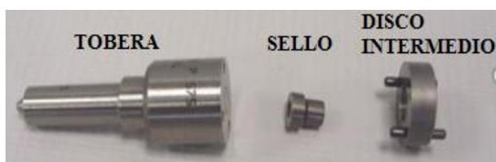
**Figura 14:** Pieza de sustitución a los 50.000 Km
